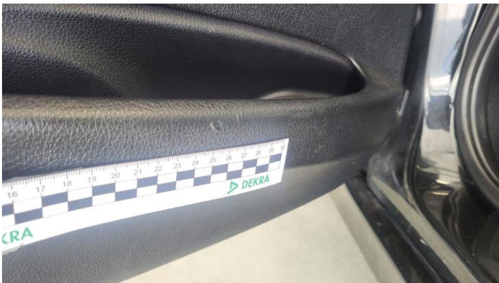
Photo 80. Tapicerka drzwi przednich L - Wgniecenie/odkształcenie 1
