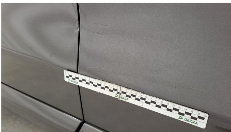
Fot. 52. Drzwi przednie P - Rysa/odprysk 1
