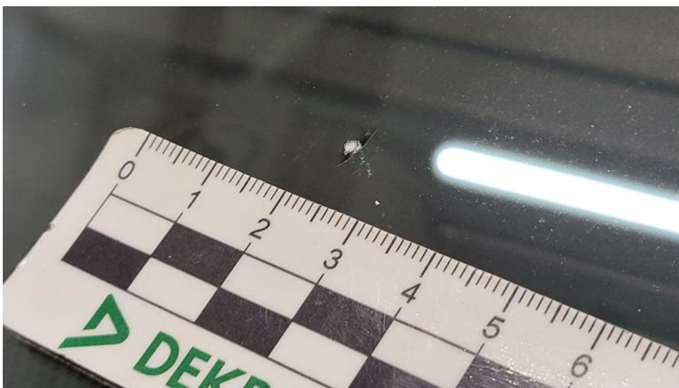
Fot. 45. Szyba czołowa - Pęknięcie/rozerwanie 1
