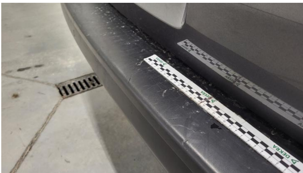
Fot. 67. Zderzak tylny - Rysa/odprysk 1
