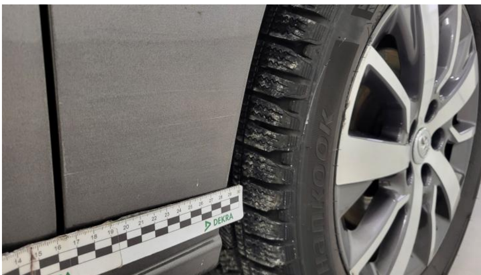
Fot. 73. Błotnik tylny L / Ściana boczna L - Rysa/odprysk 2
