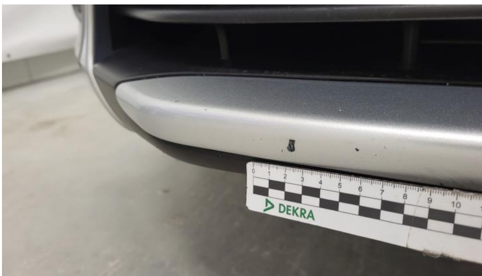
Fot. 43. Spoiler zderzaka przedniego - Rysa/odprysk 1
