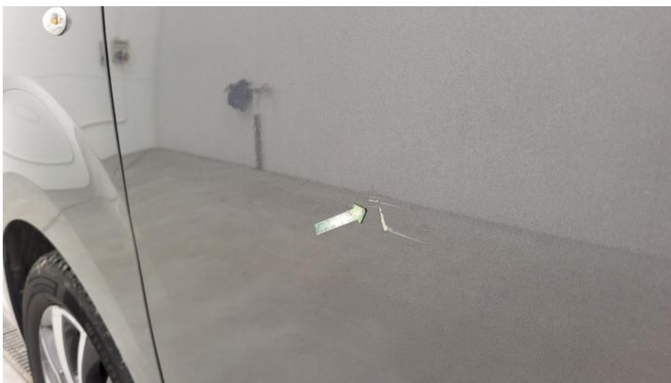
Fot. 76. Drzwi przed L - Wgniecenie/odkształcenie 1
