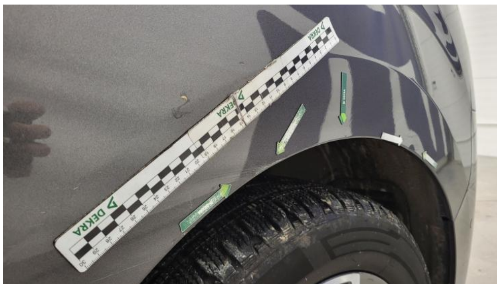
Fot. 51. Błotnik przedni P - Wgniecenie/odkształcenie 2
