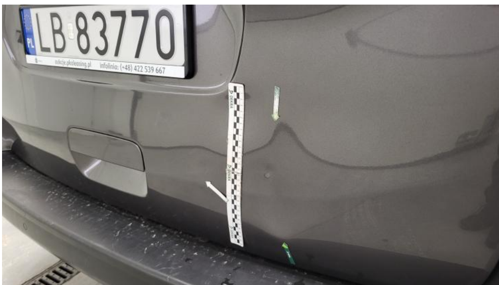
Fot. 66. Pokrywy bagażnika - Wgniecenie/odkształcenie 1
