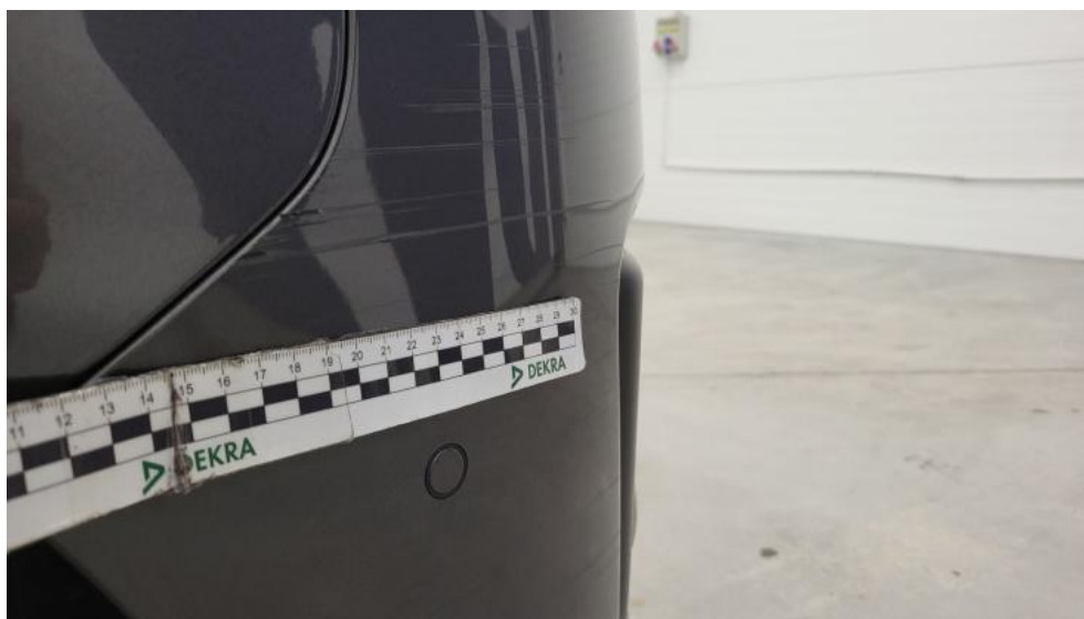
Fot. 47. Zderzak przedni cz P - Rysa/odprysk 1
