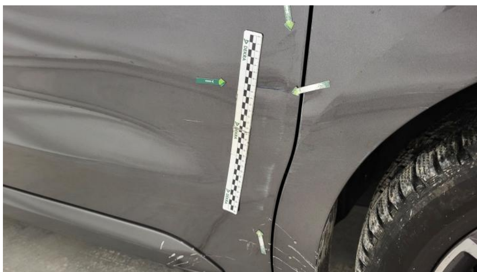
Fot. 54. Drzwi przednie P - Wgniecenie/odkształcenie 1
