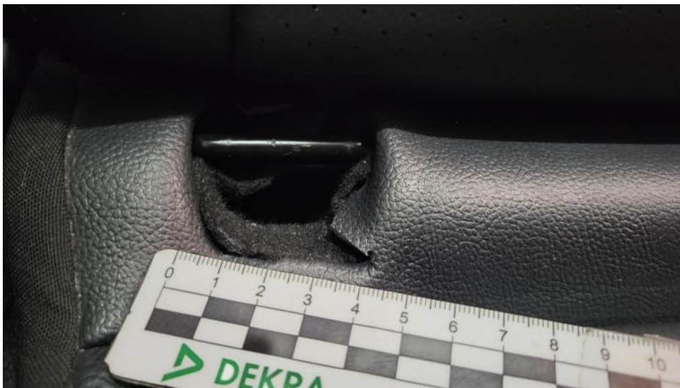
Fot. 83. Kanapa tyl. - Pęknięcie/rozerwanie 1
