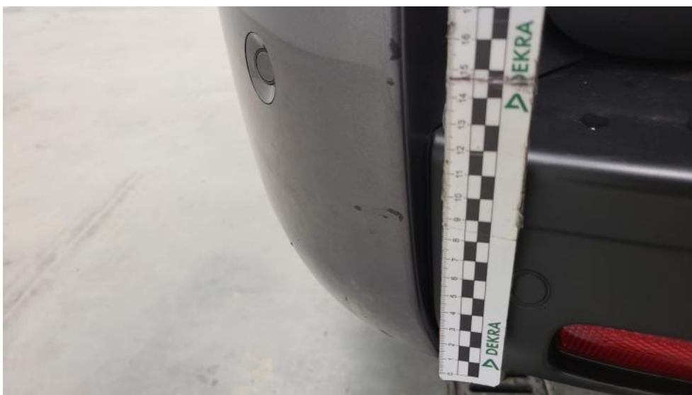
Fot. 70. Zderzak tylny cz L - Rysa/odprysk 1
