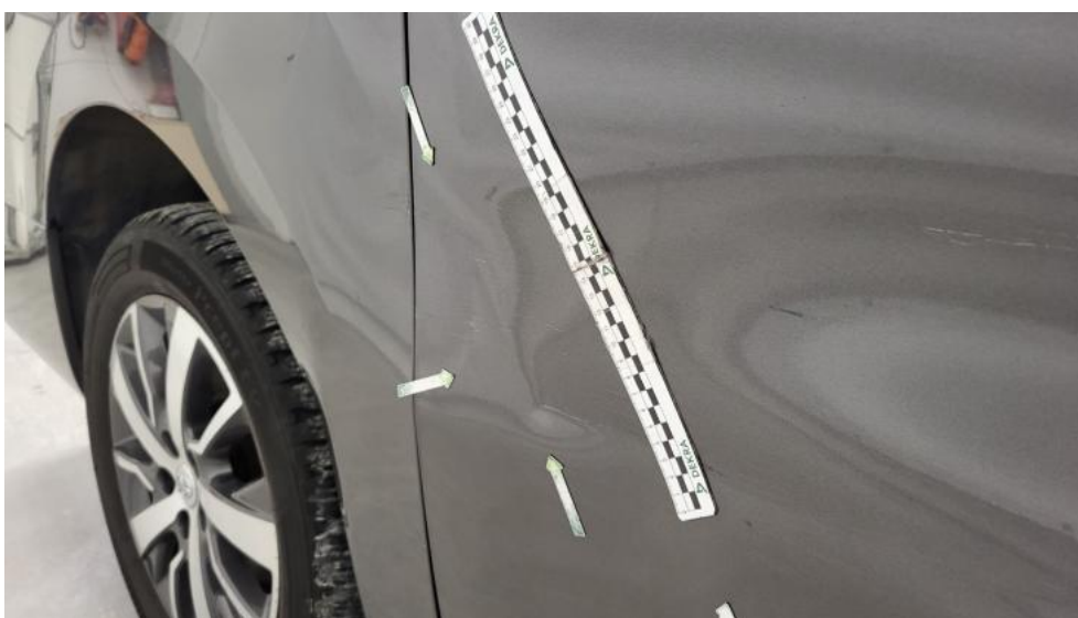
Fot. 60. Drzwi tylne P - Wgniecenie/odkształcenie 2
