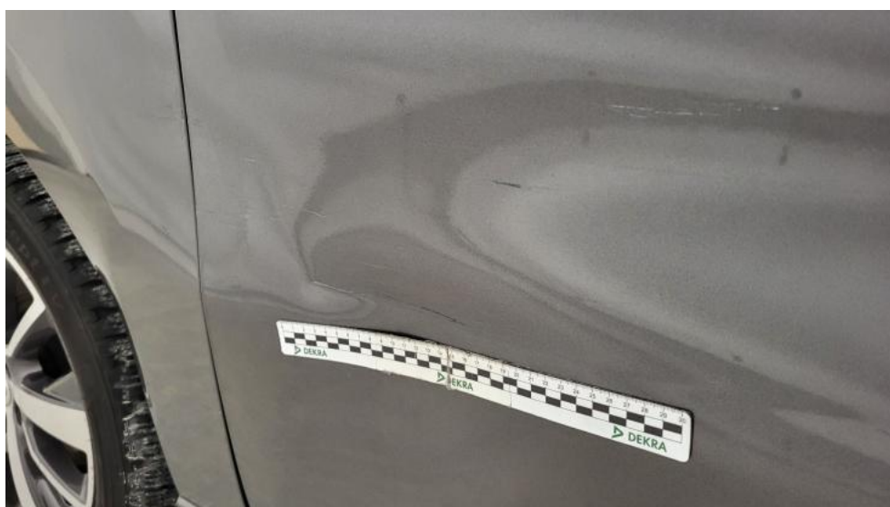
Fot. 58. Drzwi tylne P - Rysa/odprysk 2
