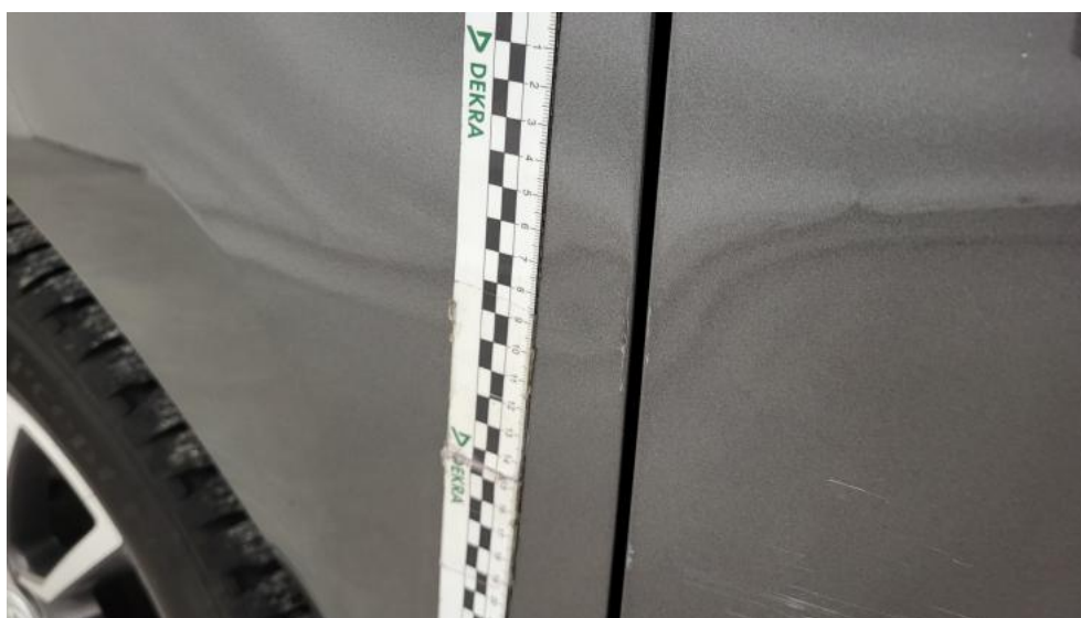
Fot. 62. Błotnik tylny P / Ściana boczna P - Rysa/odprysk 1
