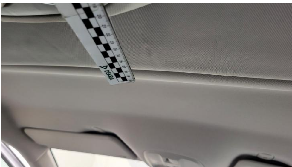
Fot. 85. Podsufitka - Wgniecenie/odkształcenie 1
