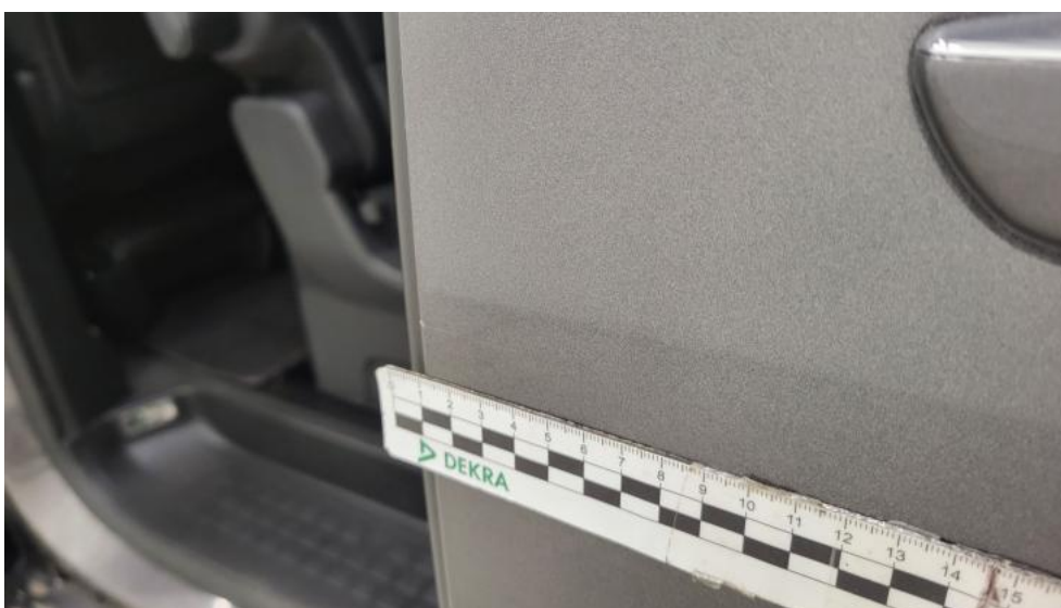
Fot. 78. Drzwi tylne L - Rysa/odprysk 2
