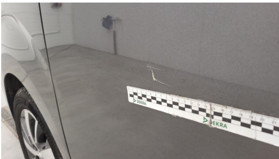
Fot. 75. Drzwi przed L - Rysa/odprysk 2
