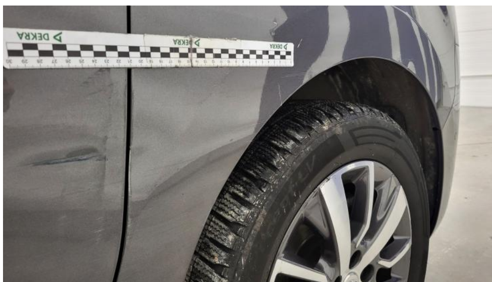
Fot. 49. Błotnik przedni P - Rysa/odprysk 2
