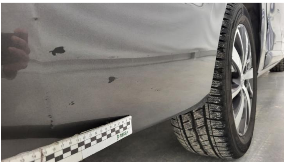
Fot. 71. Zderzak tylny cz P - Rysa/odprysk 1
