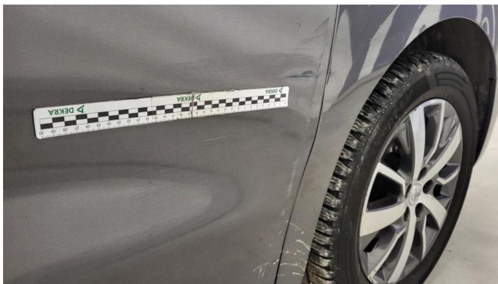
Fot. 53. Drzwi przednie P - Rysa/odprysk 2
