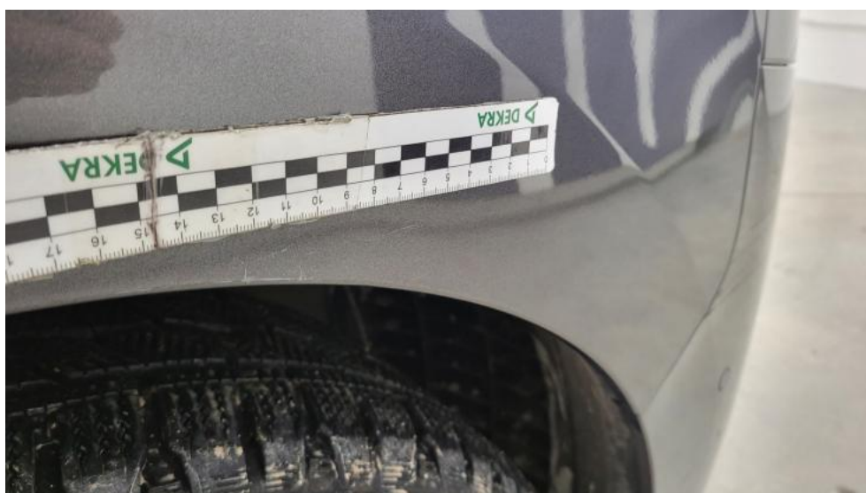
Fot. 48. Błotnik przedni P - Rysa/odprysk 1
