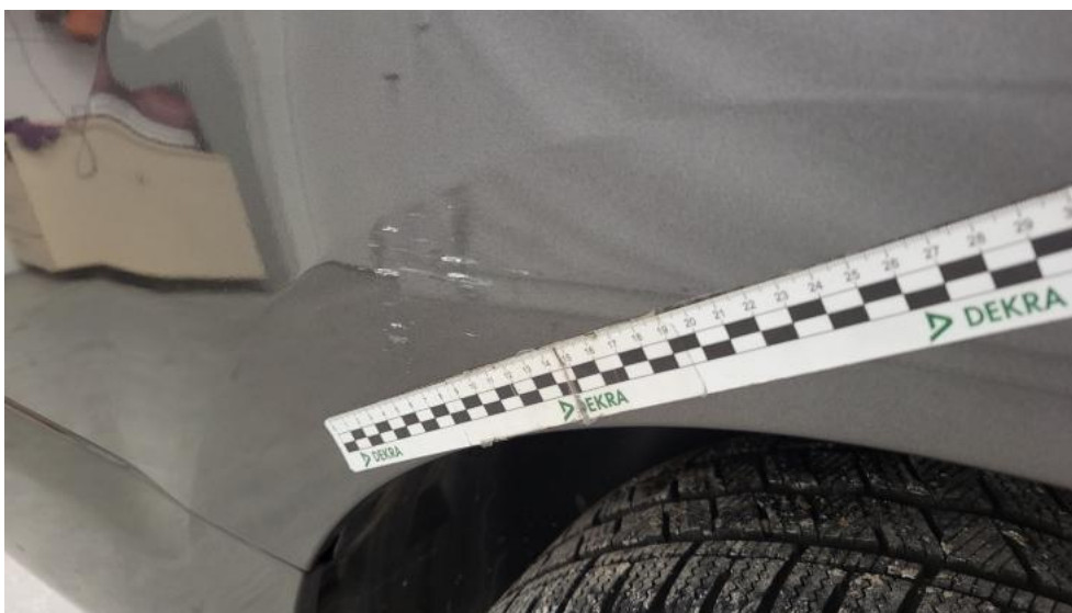
Fot. 63. Błotnik tylny P / Ściana boczna P - Rysa/odprysk 2
