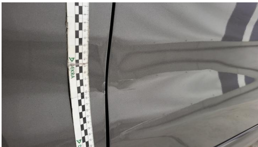
Fot. 57. Drzwi tylne P - Rysa/odprysk 1
