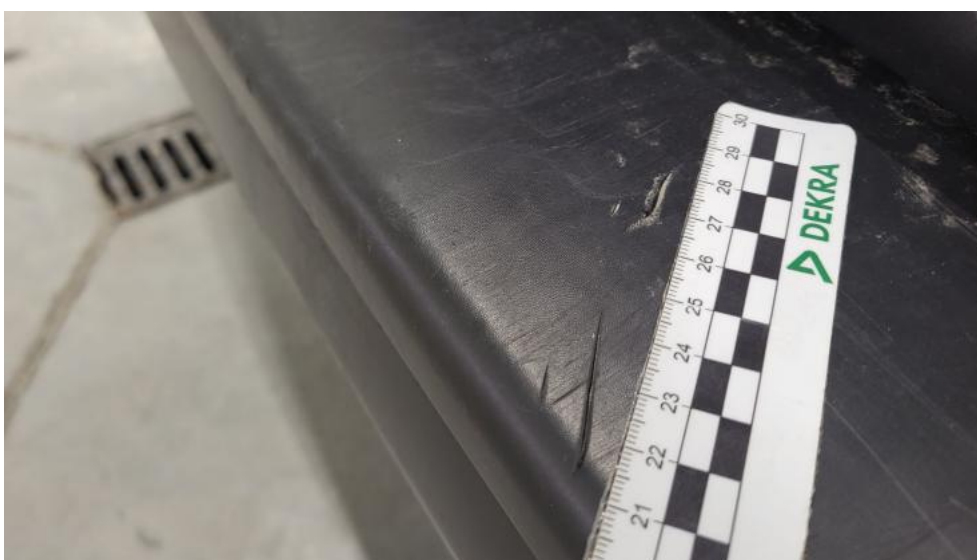
Fot. 68. Zderzak tylny - Pęknięcie/rozerwanie 1
