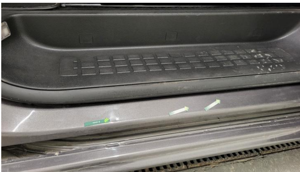
Fot. 81. Próg L - Wgniecenie/odkształcenie 1
