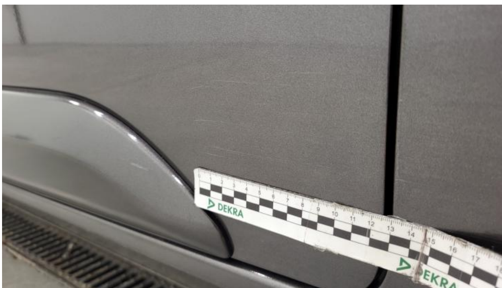
Fot. 77. Drzwi tylne L - Rysa/odprysk 1
