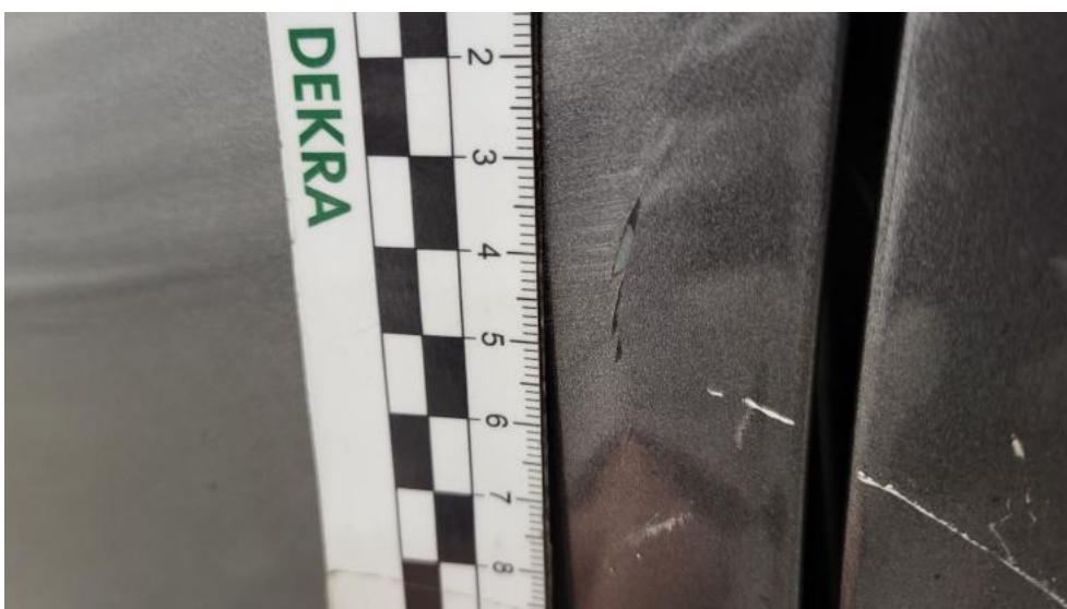
Fot. 56. Drzwi przednie P - Pęknięcie/rozerwanie 1
