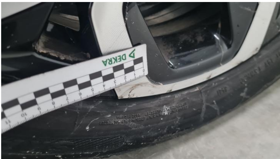
Photo 73. Felga Aluminiowa przednia L - Rysa/odprysk 1
