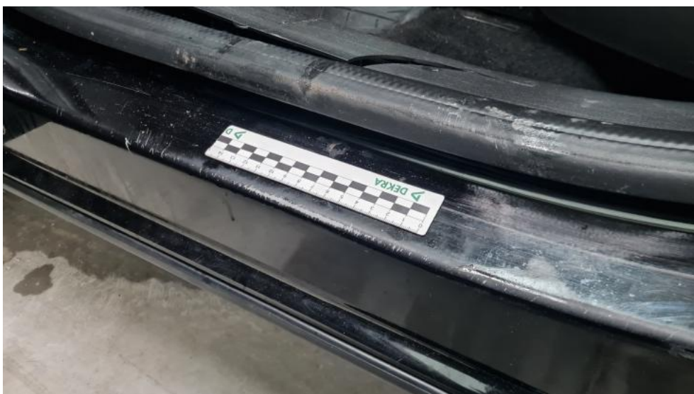
Photo 70. Próg L - Rysa/odprysk 2
