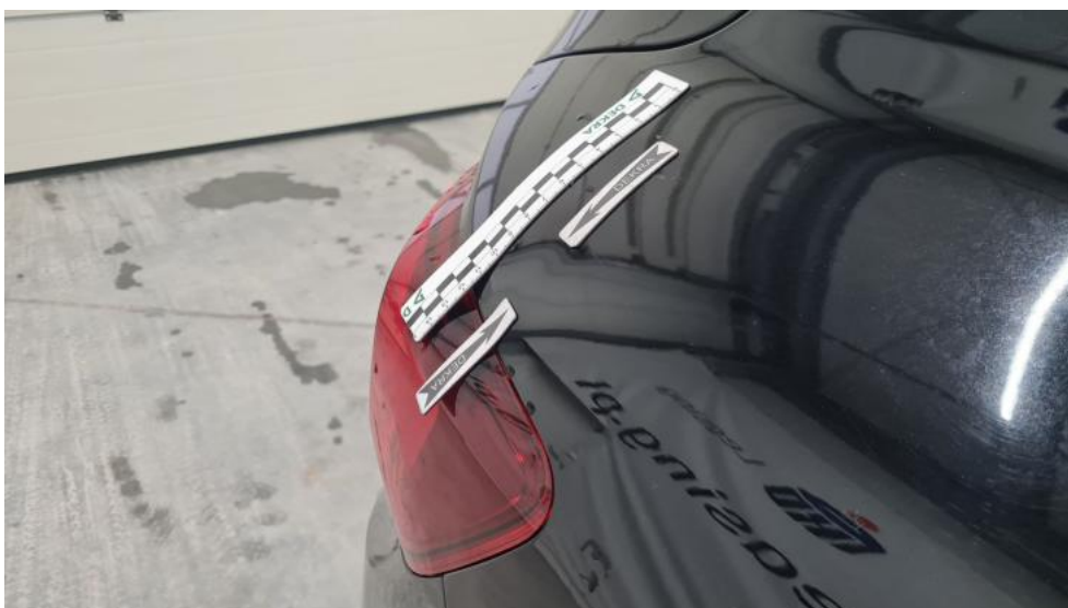
Photo 54. Błotnik tylny P / Ściana boczna P - Wgniecenie/odkształcenie 1
