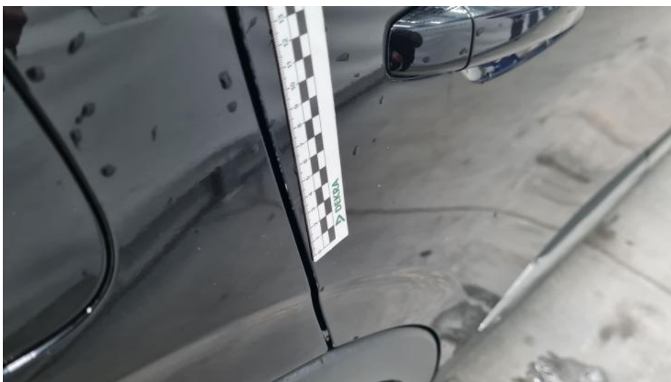
Photo 50. Drzwi tylne P - Rysa/odprysk 1
