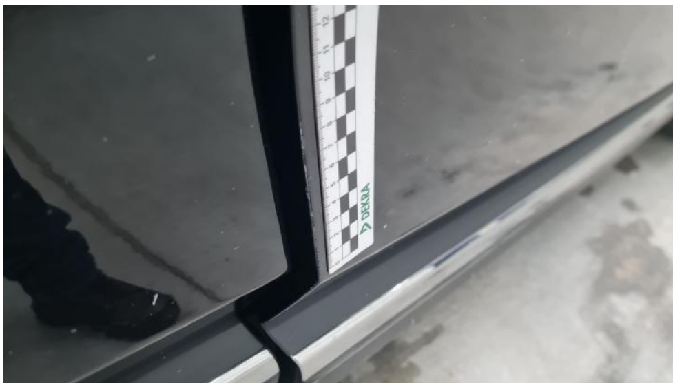
Photo 47. Drzwi przednie P - Rysa/odprysk 2
