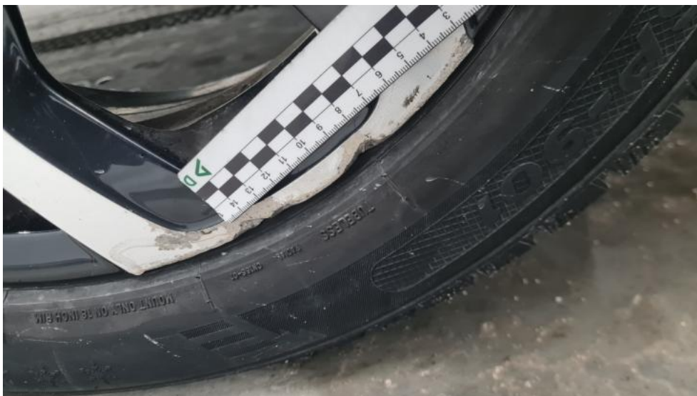
Photo 45. Felga aluminiowa przednia P - Rysa/odprysk 1
