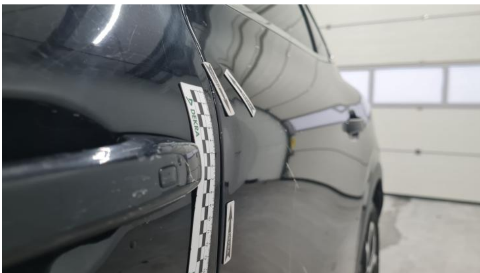
Photo 68. Drzwi tylne L - Wgniecenie/odkształcenie 1
