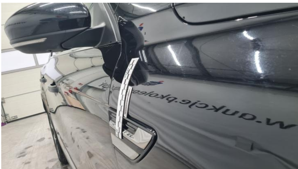
Photo 44. Błotnik przedni P - Wgniecenie/odkształcenie 1
