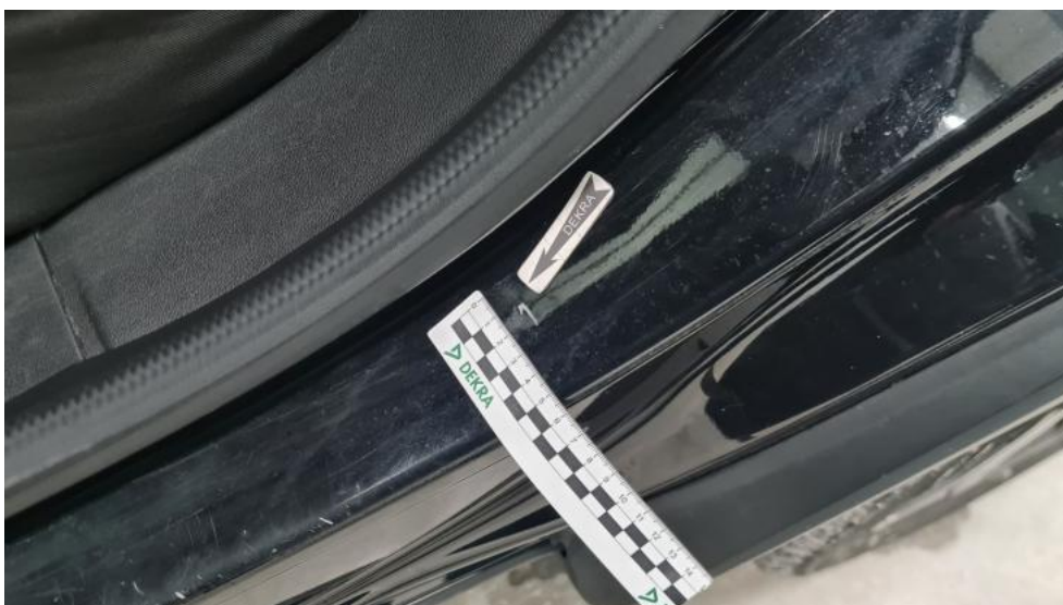
Photo 62. Błotnik tylny L / Ściana boczna L - Wgniecenie/odkształcenie 1
