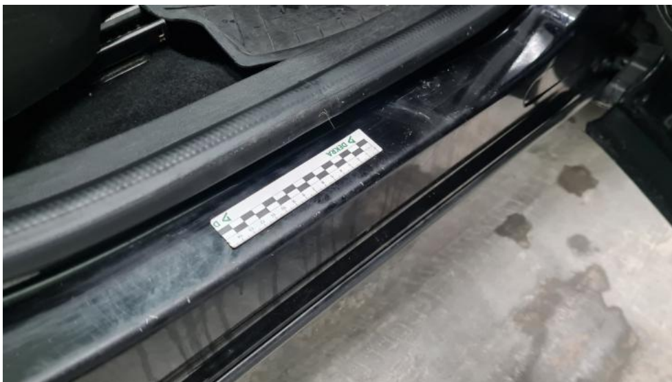
Photo 51. Próg P - Rysa/odprysk 1
