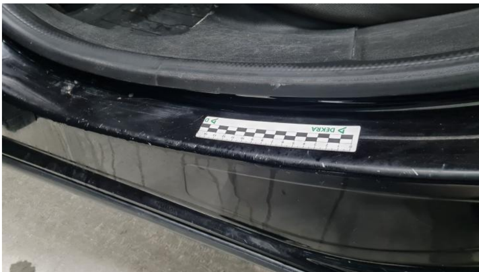
Photo 69. Próg L - Rysa/odprysk 1
