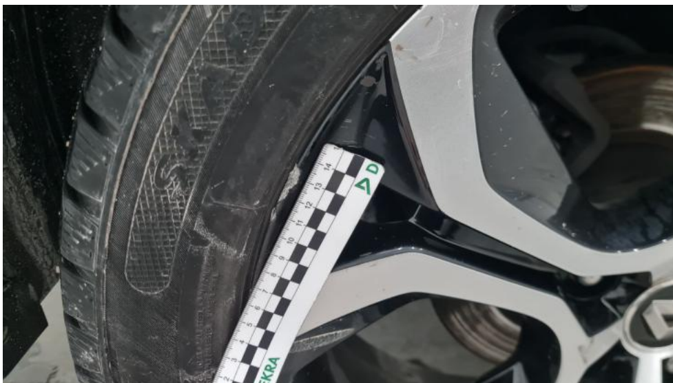
Photo 55. Felga aluminiowa tylna P - Rysa/odprysk 1
