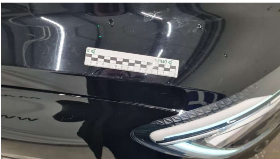
Photo 38. Pokrywa komory silnika - Rysa/odprysk 1
