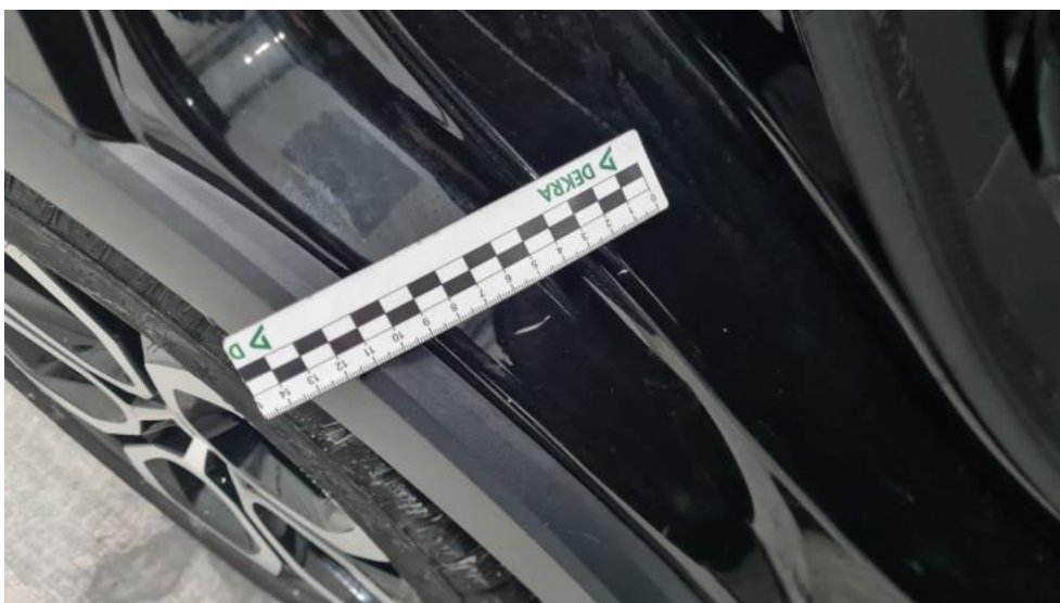
Photo 52. Błotnik tylny P / Ściana boczna P - Rysa/odprysk 1
