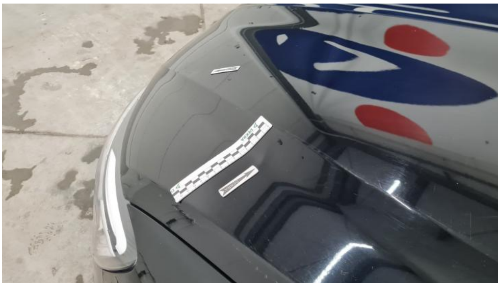
Photo 41. Pokrywa komory silnika() - Wgniecenie/odkształcenie 3
