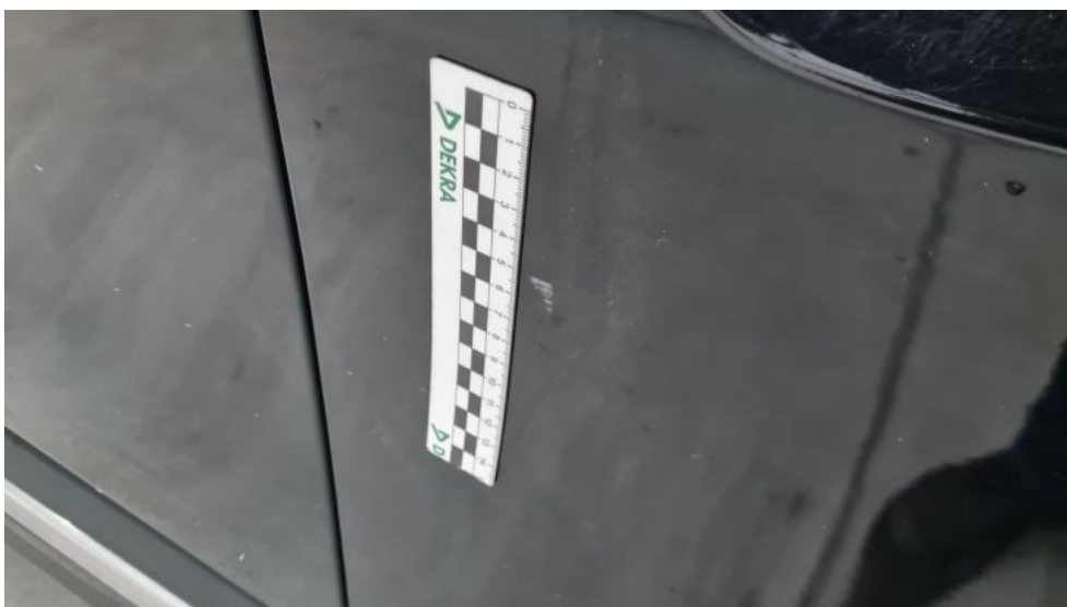
Photo 46. Drzwi przednie P - Rysa/odprysk 1
