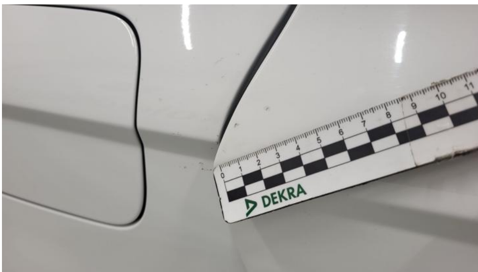
Fot. 50. Drzwi tylne P - Rysa/odprysk 1
