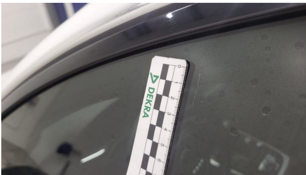
Fot. 65. Szyba boczna przednia L - Rysa/odprysk 1
