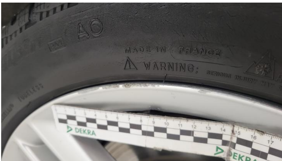
Fot. 56. Felga aluminiowa tylna P - Rysa/odprysk 1
