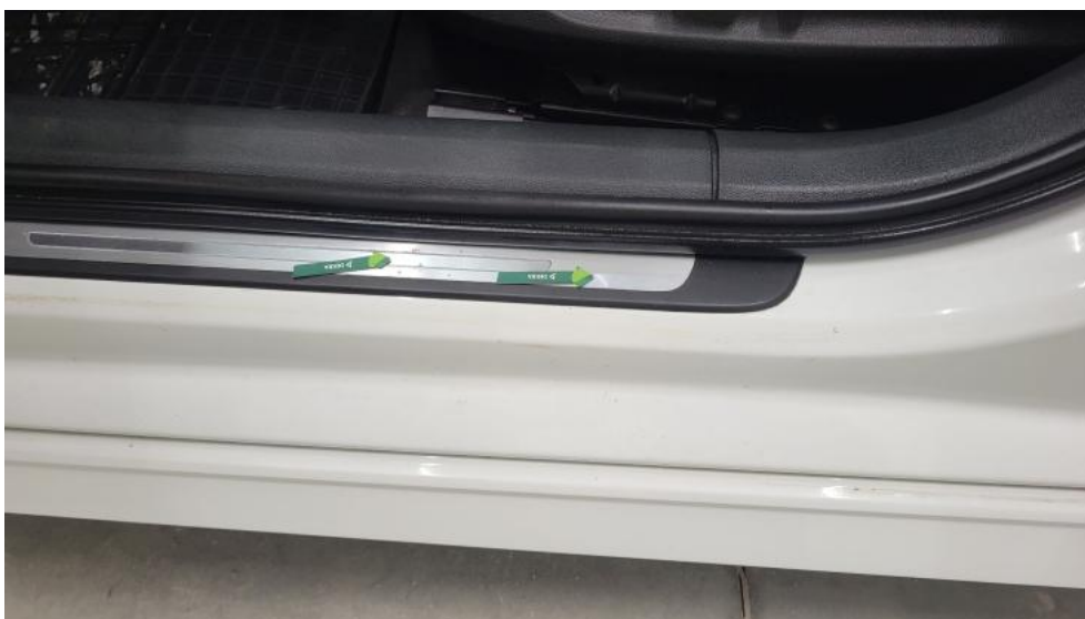
Fot. 64. Próg L - Wgniecenie/odkształcenie 1
