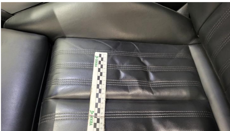
Fot. 69. Fotel prz. lew. - Wgniecenie/odkształcenie 1
