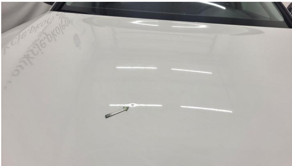
Fot. 41. Pokrywa komory silnika - Wgniecenie/odkształcenie 1
