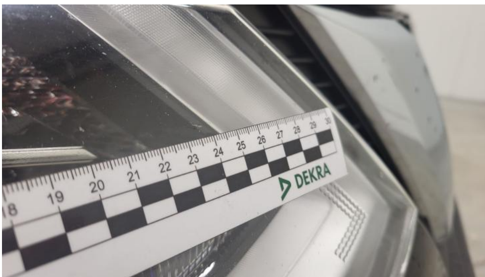
Photo 57. Reflektor P - Rysa/odprysk 1
