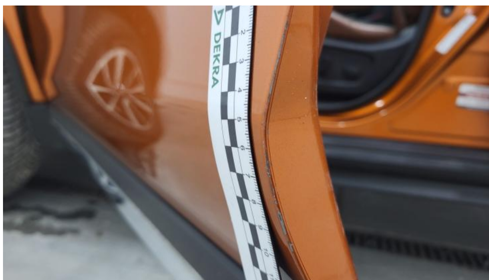
Photo 98. Drzwi przed L - Rysa/odprysk 1
