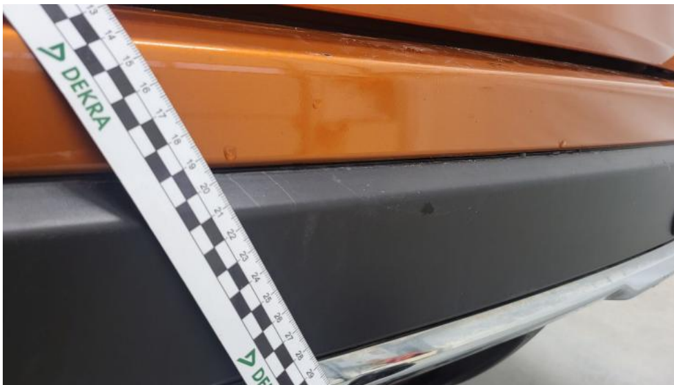
Photo 91. Zderzak tylny cz dolna() - Rysa/odprysk 3
