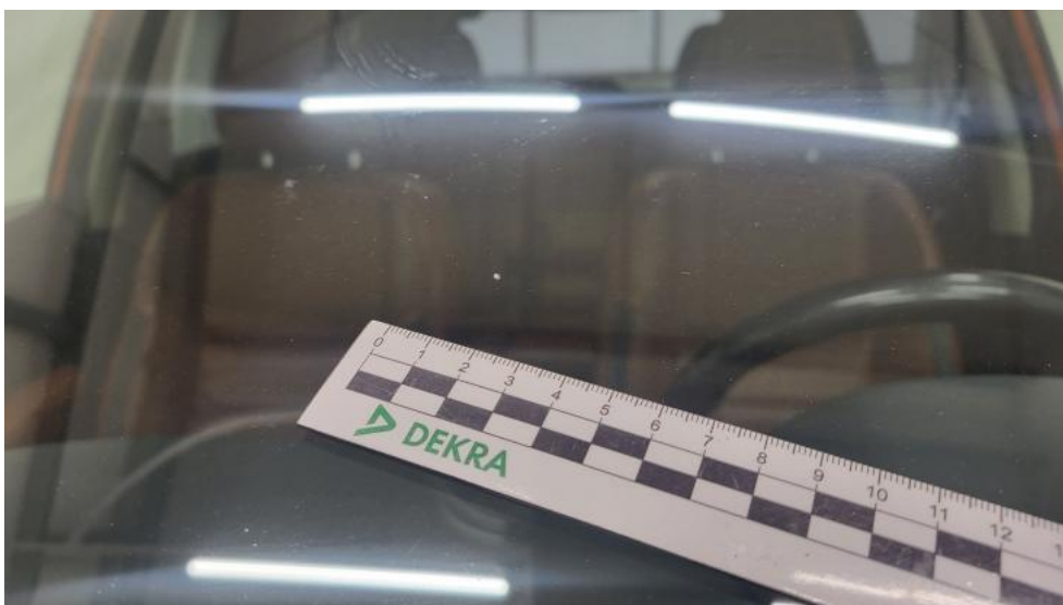
Photo 48. Szyba czołowa - Rysa/odprysk 1
