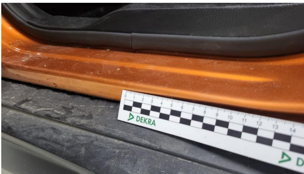
Photo 107. Próg L - Rysa/odprysk 1
