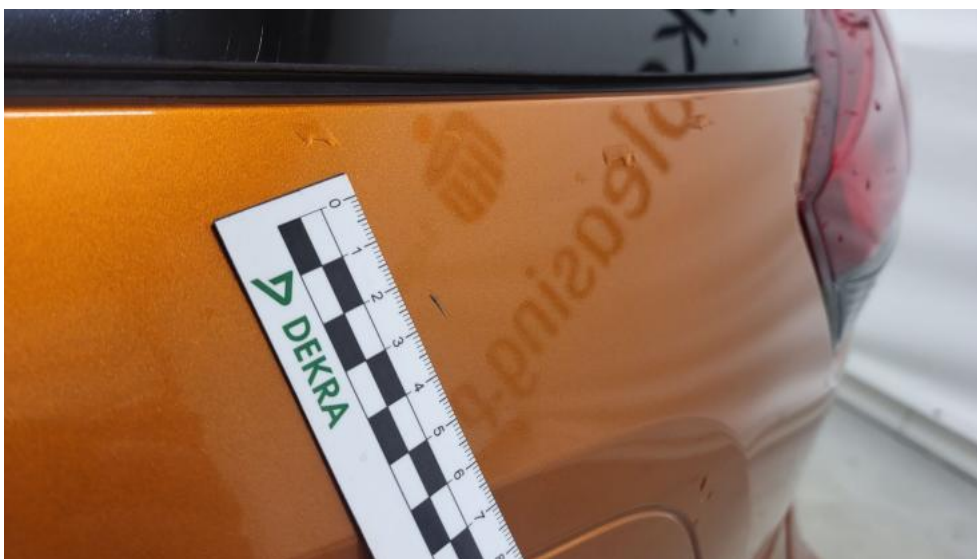
Photo 81. Pokrywy bagażnika - Rysa/odprysk 1
