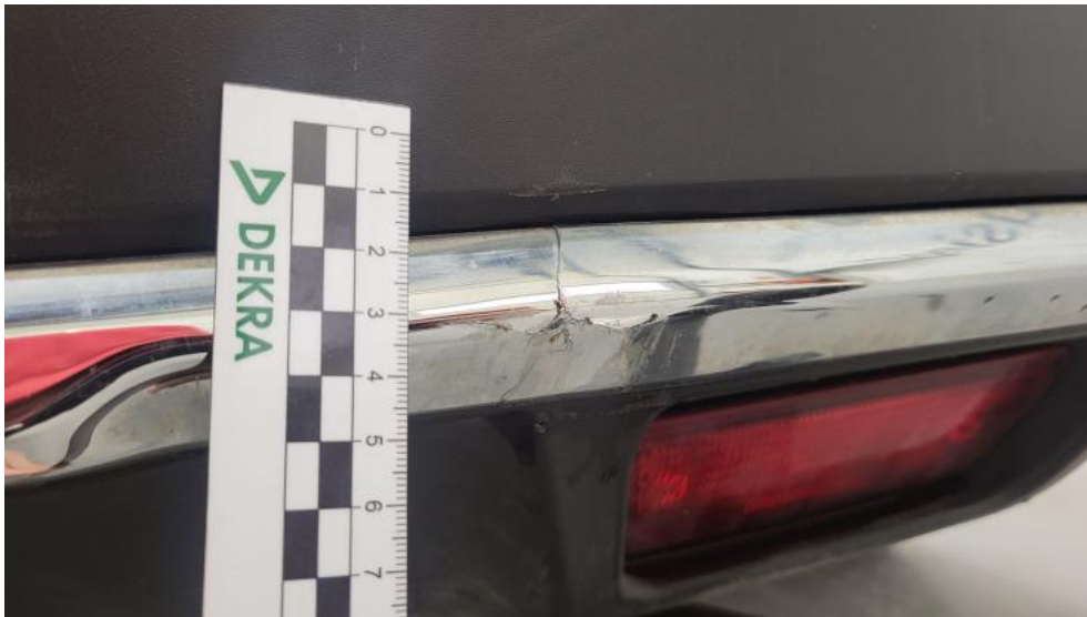
Photo 83. Spojler zderzaka tylnego - Pęknięcie/rozerwanie 1
