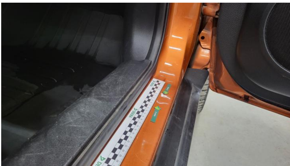
Photo 71. Próg P - Wgniecenie/odkształcenie 1
