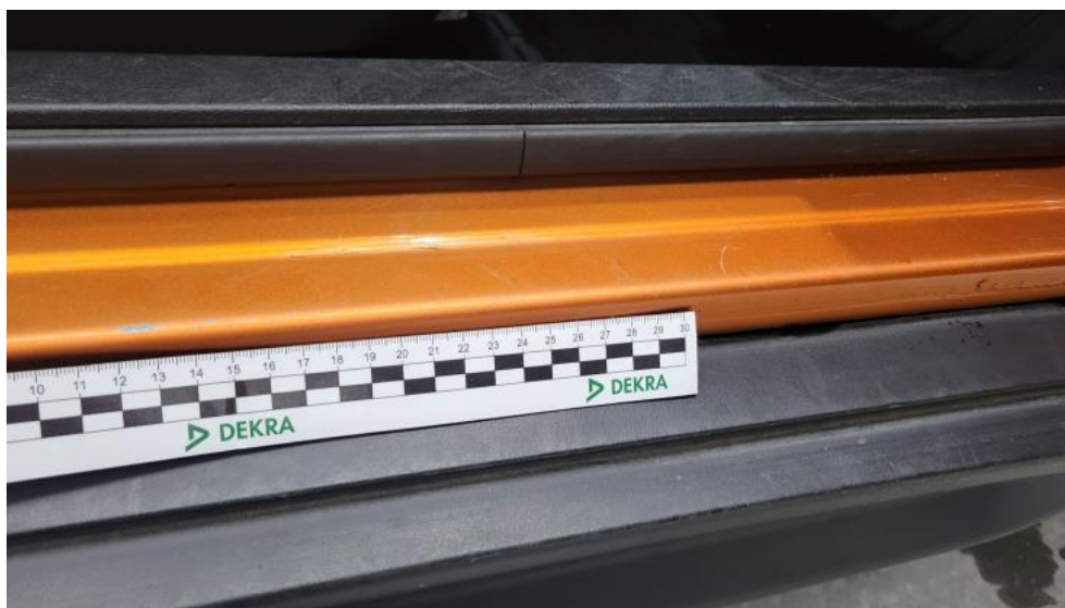
Photo 69. Próg P - Rysa/odprysk 1
