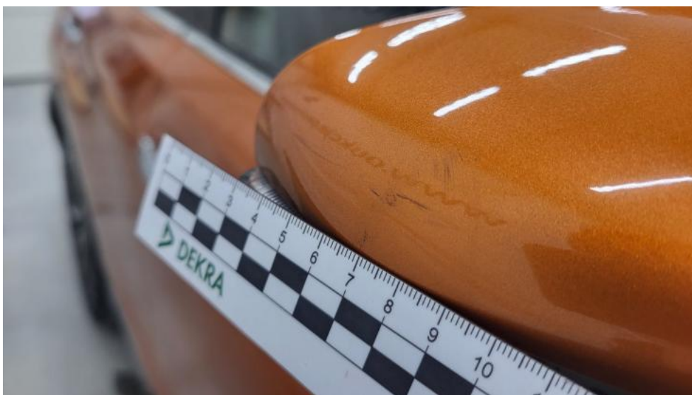
Photo 68. Lusterko zew P - Rysa/odprysk 1
