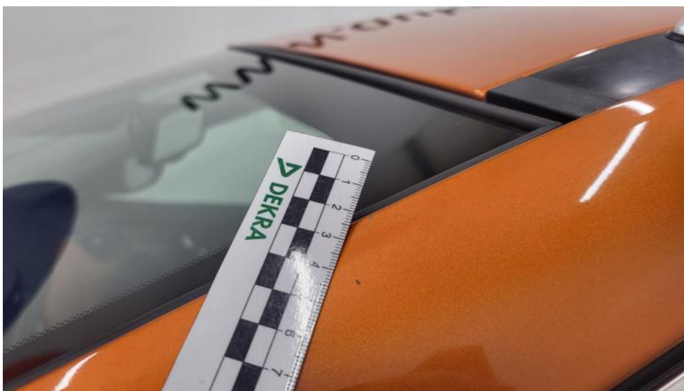
Photo 109. Stupek przedni L - Rysa/odprysk 1
