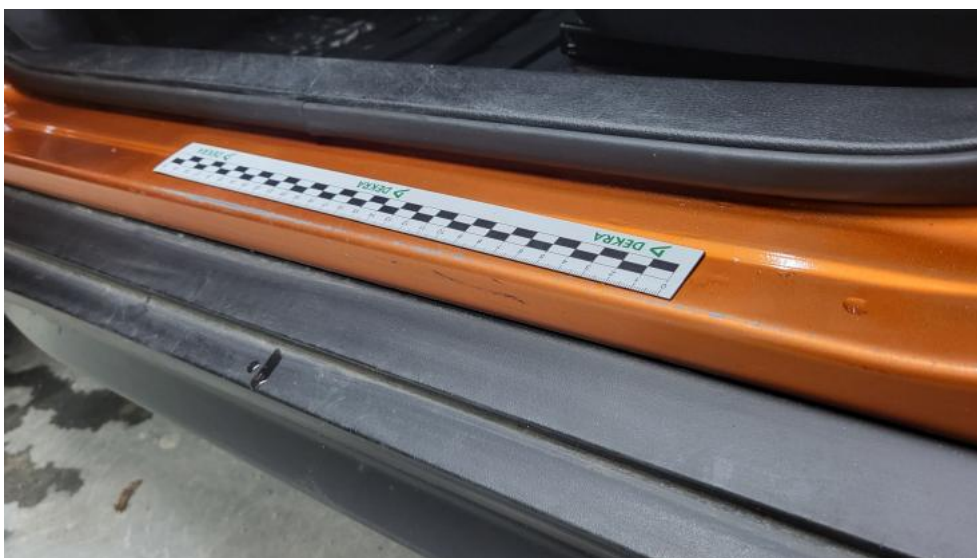
Photo 108. Próg L - Rysa/odprysk 2
