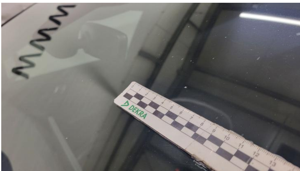
Photo 49. Szyba czołowa - Rysa/odprysk 1
