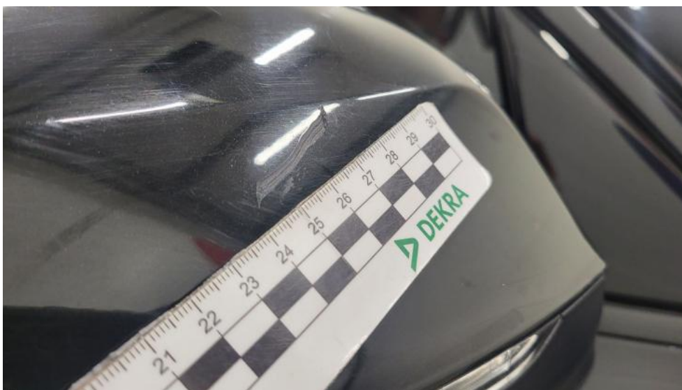
Photo 67. Lusterko zew P - Rysa/odprysk 1
