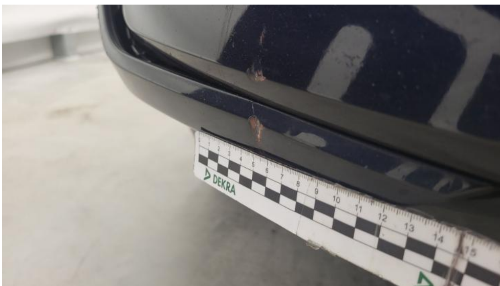
Photo 61. Zderzak przedni cz P - Wgniecenie/odkształcenie 2
