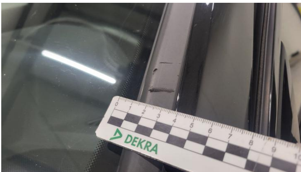
Photo 50. Uszczelka/listwa szyby czołowej - Rysa/odprysk 1
