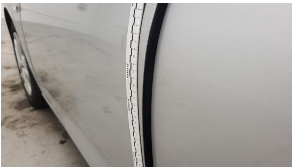
Fot. 60. Drzwi przed L - Rysa/odprysk 1
