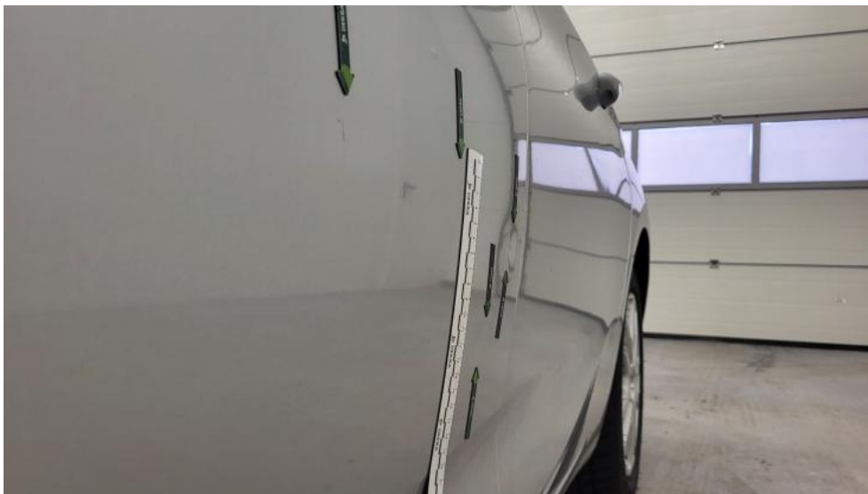
Fot. 61. Drzwi przed L - Wgniecenie/odkształcenie 1
