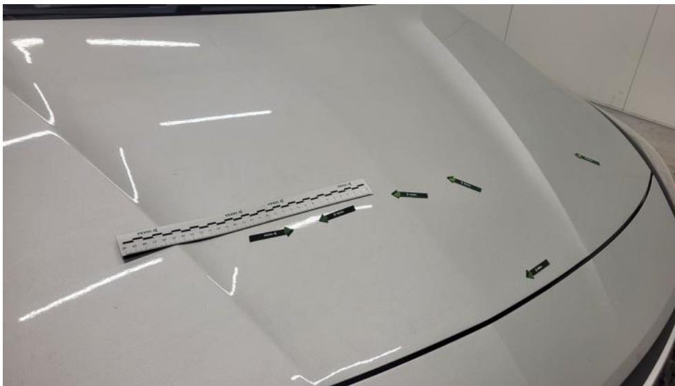
Fot. 39. Pokrywa komory silnika - Wgniecenie/odkształcenie 1
