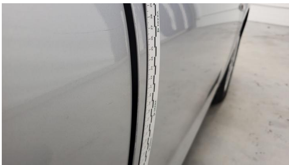
Fot. 42. Drzwi przednie P - Rysa/odprysk 1
