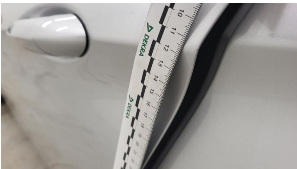
Fot. 62. Drzwi tylne L - Rysa/odprysk 1
