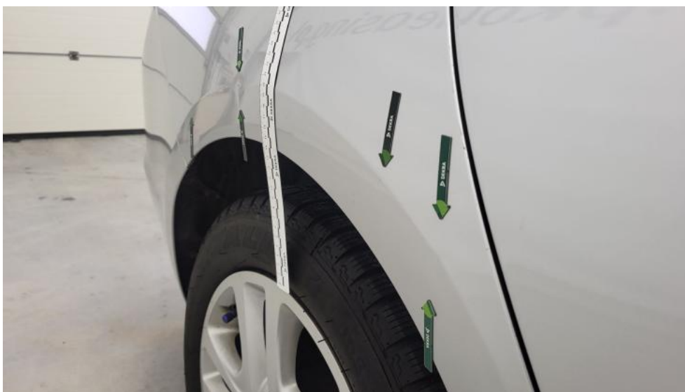
Fot. 49. Błotnik tylny P / Ściana boczna P - Wgniecenie/odkształcenie 2
