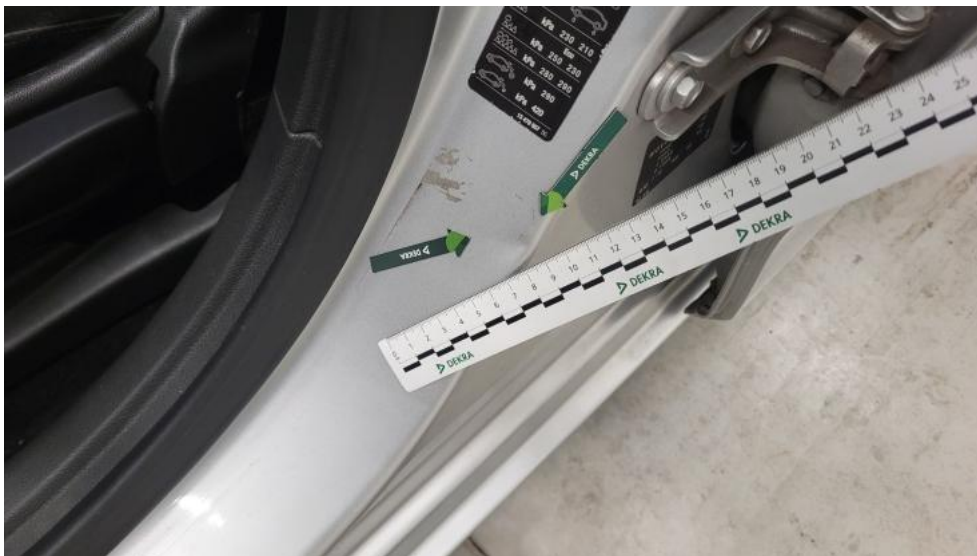
Fot. 69. Stupek środkowy L - Wgniecenie/odkształcenie 1
