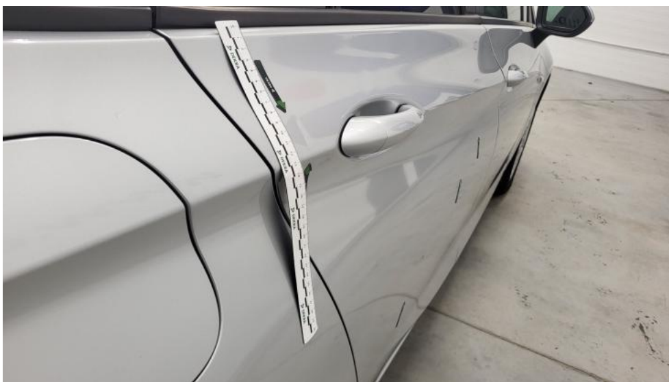
Fot. 45. Drzwi tylne P - Wgniecenie/odkształcenie 1
