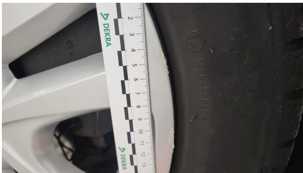
Fot. 41. Kołpak przedni P - Rysa/odprysk 1
