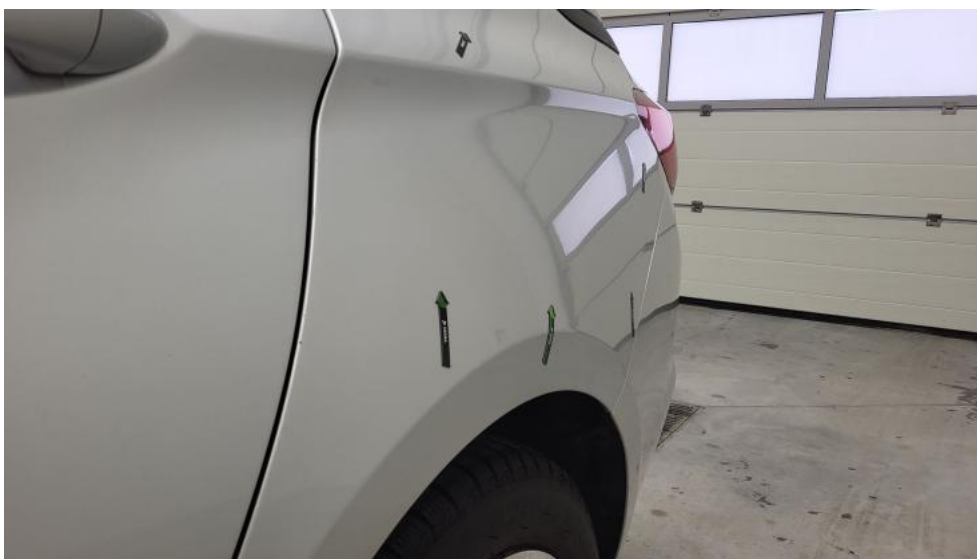
Fot. 57. Błotnik tylny L / Ściana boczna L - Wgniecenie/odkształcenie 2
