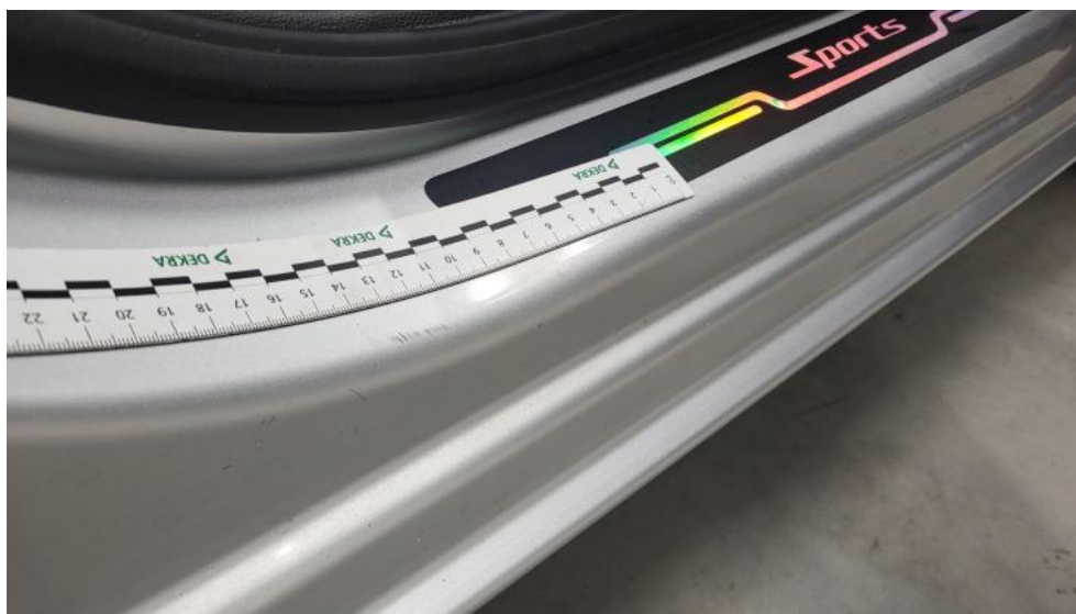
Fot. 47. Próg P - Rysa/odprysk 1
