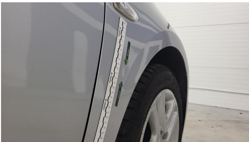
Fot. 40. Błotnik przedni P - Wgniecenie/odkształcenie 1
