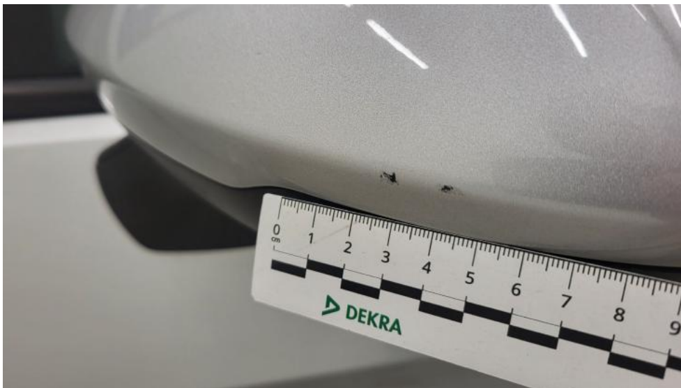
Fot. 65. Lusterko zew L - Rysa/odprysk 1
