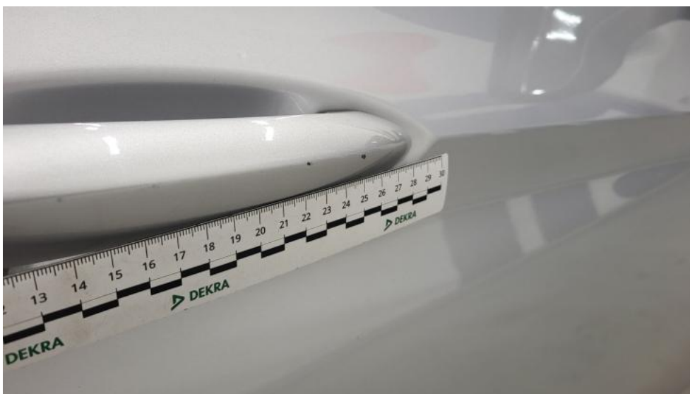
Fot. 46. Klamka drzwi prz P - Rysa/odprysk 1
