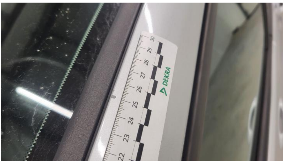
Fot. 68. Słupek przedni L - Rysa/odprysk 1
