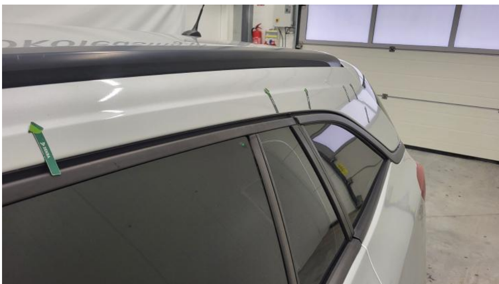
Fot. 56. Błotnik tylny L / Ściana boczna L - Wgniecenie/odkształcenie 1
