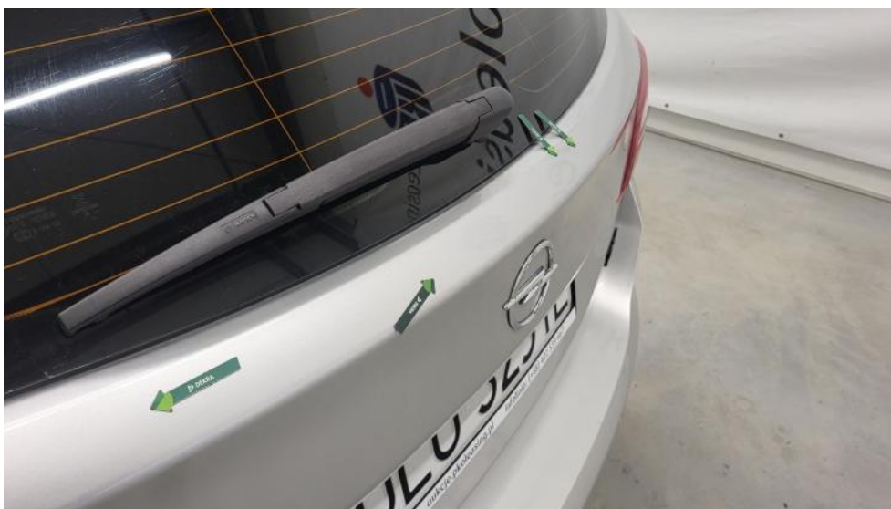
Fot. 52. Pokrywy bagażnika - Wgniecenie/odkształcenie 1
