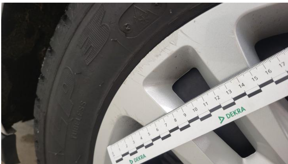
Fot. 71. Kołpak przedni L - Rysa/odprysk 1
