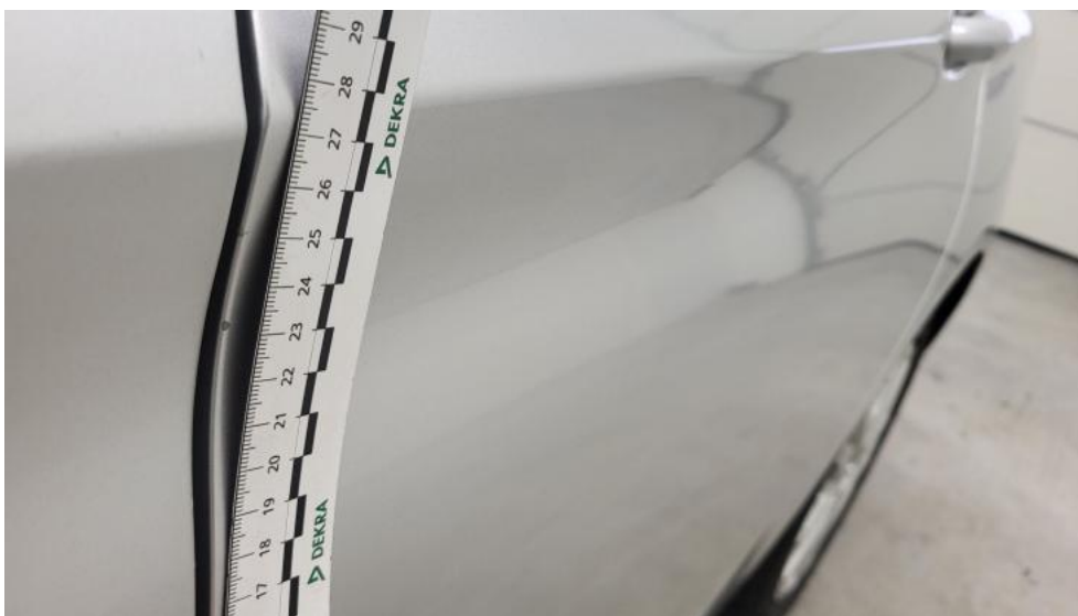
Fot. 63. Drzwi tylne L - Rysa/odprysk 2
