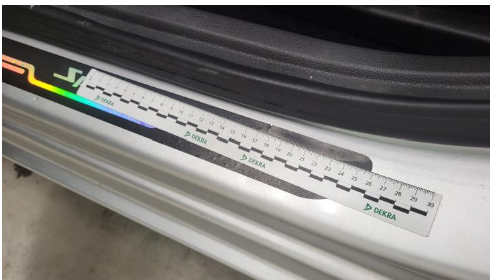
Fot. 66. Próg L - Rysa/odprysk 1
