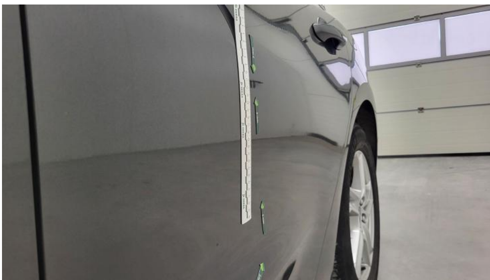
Photo 55. Drzwi tylne L - Wgniecenie/odkształcenie 1
