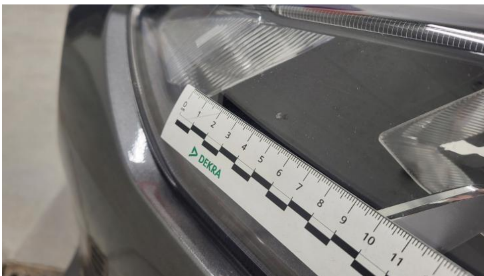
Photo 58. Reflektor L - Rysa/odprysk 1
