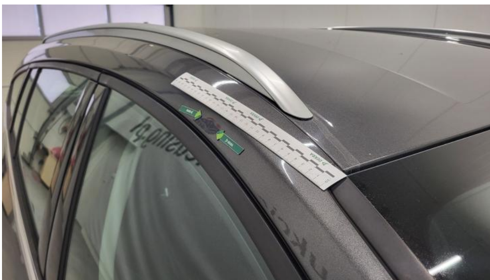
Photo 47. Stupek przedni P - Wgniecenie/odkształcenie 1
