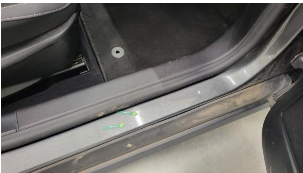
Photo 46. Próg P - Wgniecenie/odkształcenie 1
