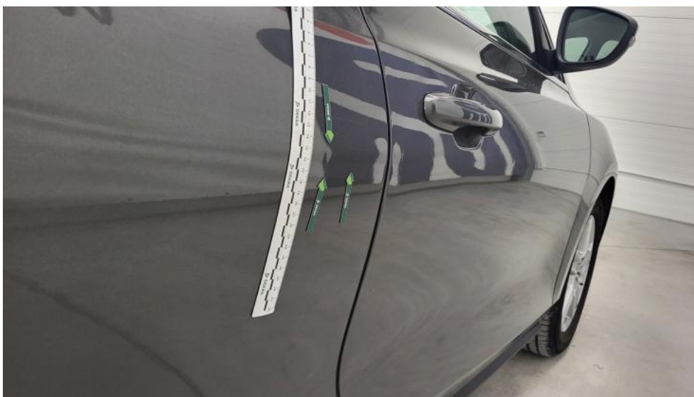
Photo 43. Drzwi tylne P - Wgniecenie/odkształcenie 1
