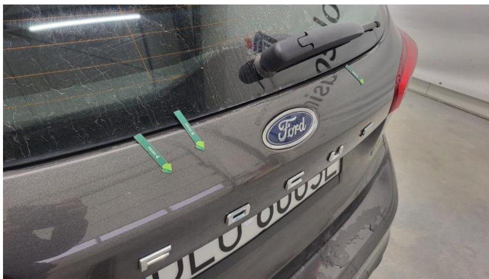
Photo 51. Pokrywy bagażnika - Wgniecenie/odkształcenie 1
