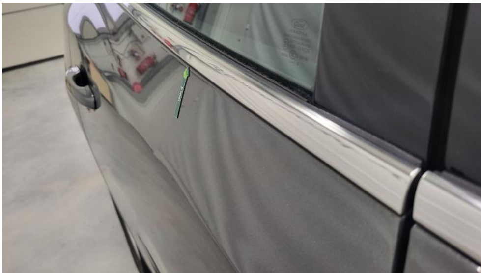
Photo 45. Listwa drzwi tylnych P - Wgniecenie/odkształcenie 1
