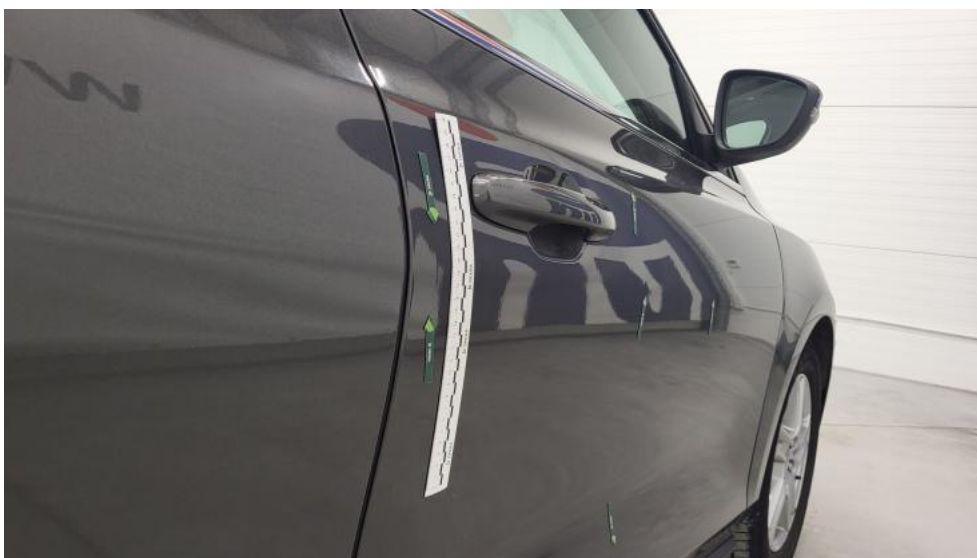
Photo 42. Drzwi przednie P - Wgniecenie/odkształcenie 1
