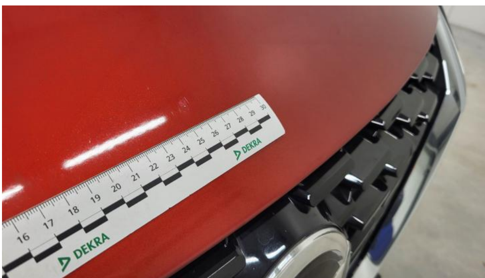
Fot. 38. Pokrywa komory silnika - Rysa/odprysk 1
