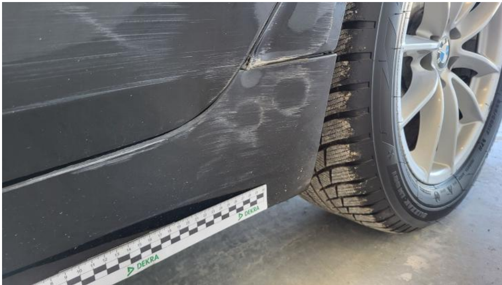
Photo 57. Próg L - Rysa/odprysk 2
