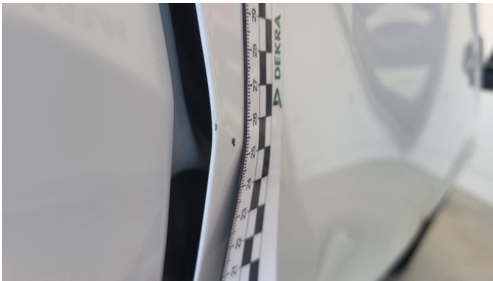
Fot. 49. Drzwi tylne P - Rysa/odprysk 1
