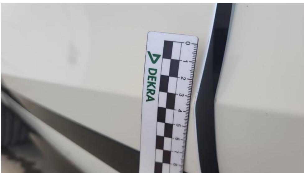
Fot. 52. Drzwi przed L - Rysa/odprysk 1
