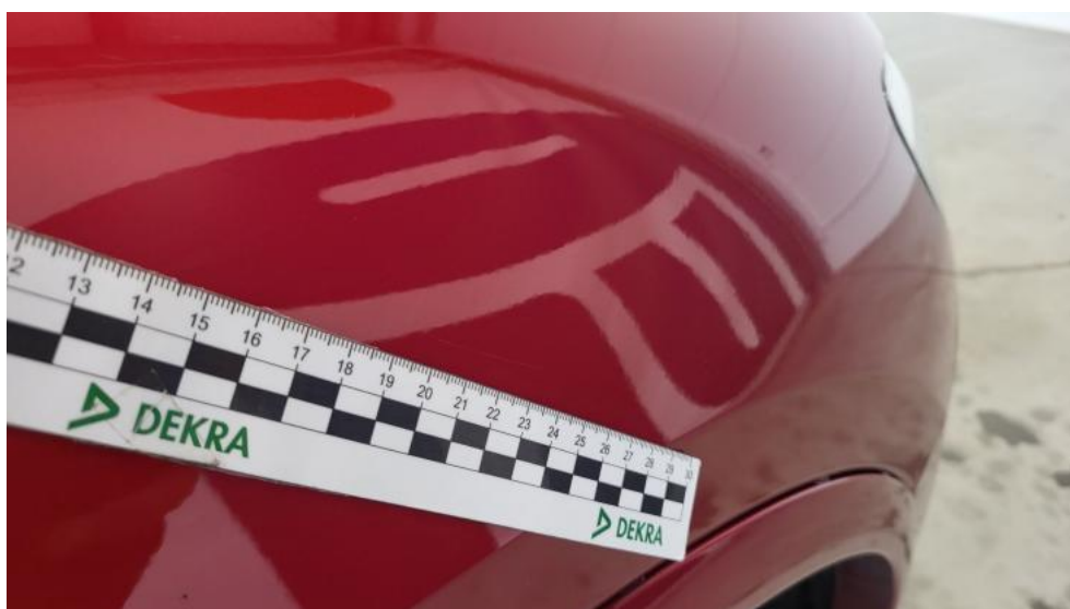
Fot. 50. Błotnik przedni P - Rysa/odprysk 1
