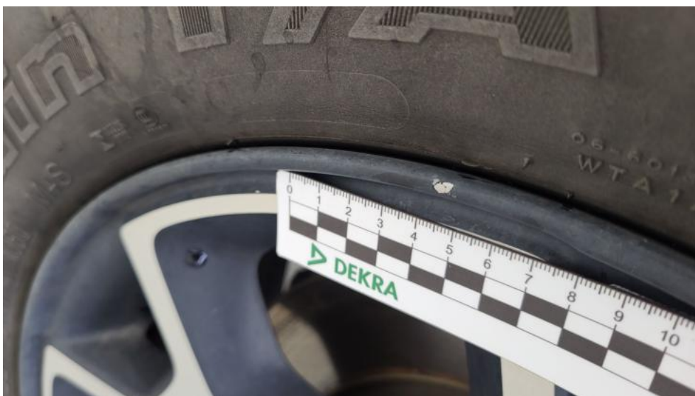
Photo 56. Felga Aluminiowa przednia L - Rysa/odprysk 1
