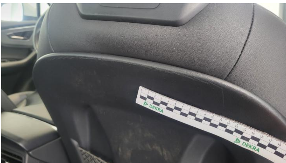
Fot. 74. Fotel prz. praw. - Rysa/odprysk 1
