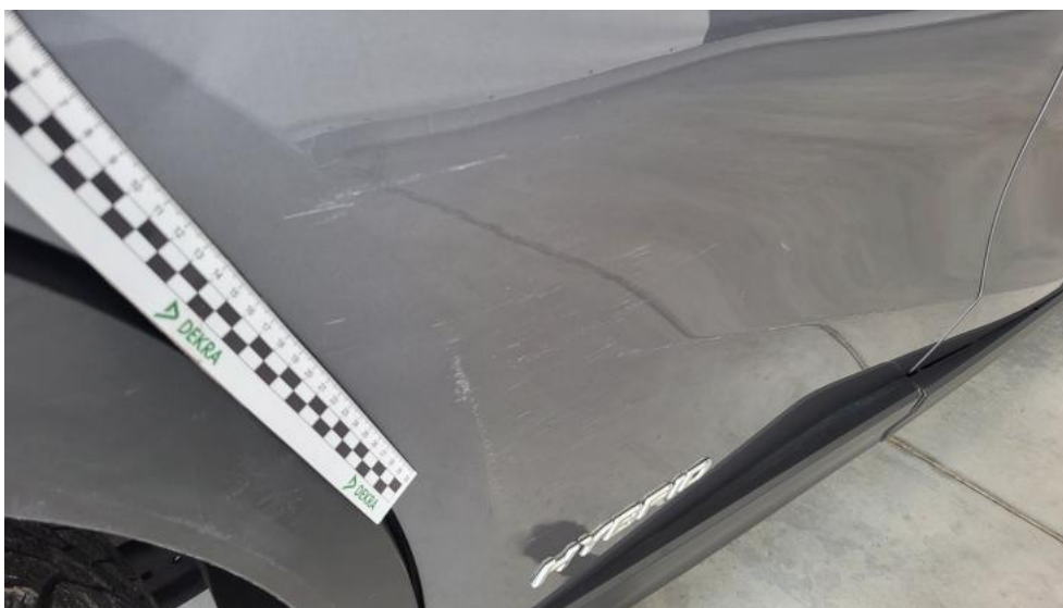
Fot. 51. Drzwi tylne P - Rysa/odprysk 2
