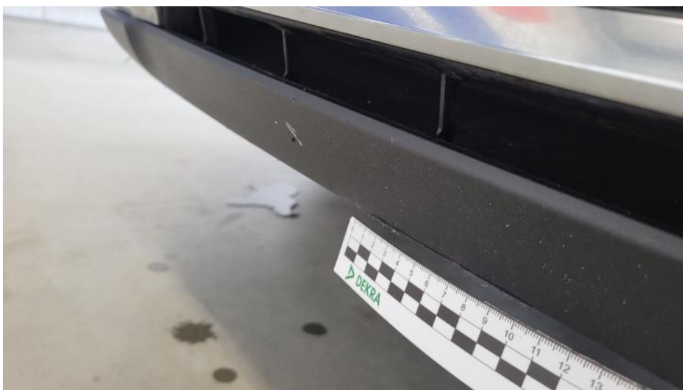
Fot. 40. Spoiler zderzaka przedniego - Rysa/odprysk 1
