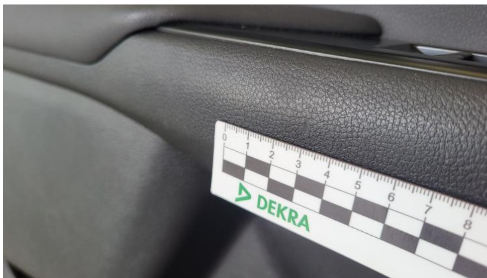
Fot. 89. Tapicerka drzwi przednich L - Rysa/odprysk 1
