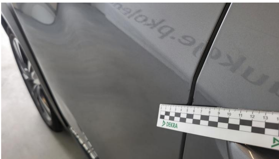
Fot. 50. Drzwi tylne P - Rysa/odprysk 1
