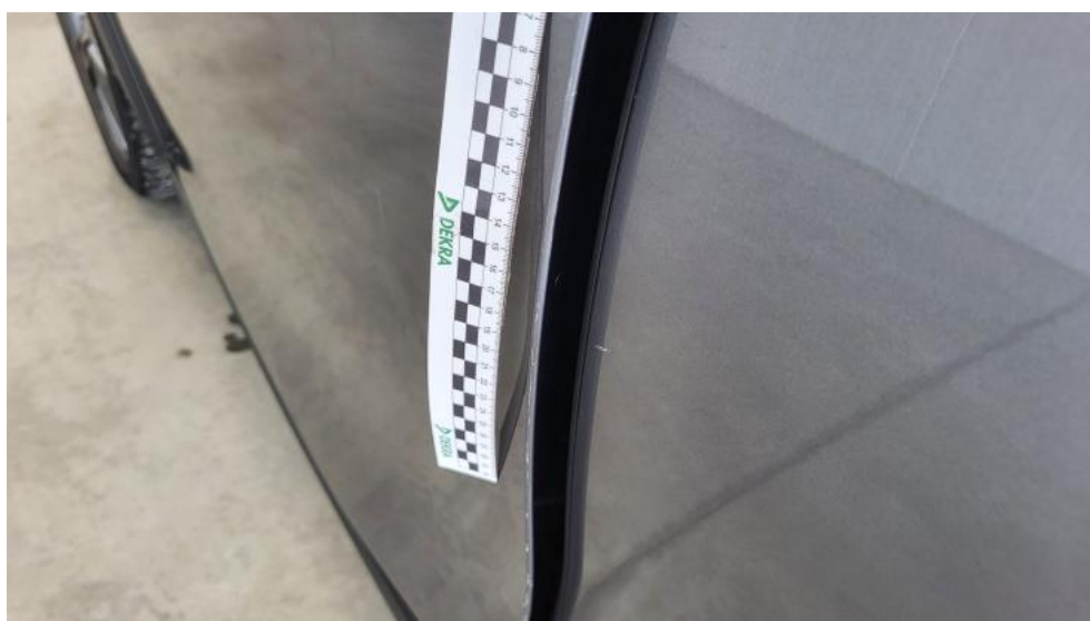
Fot. 72. Drzwi przed L - Rysa/odprysk 1
