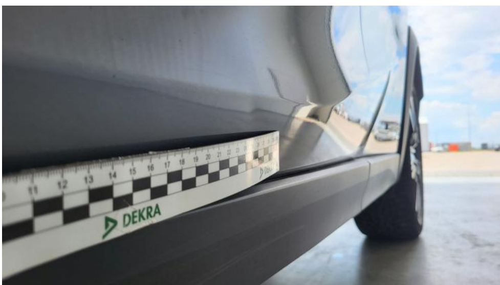
Fot. 74. Drzwi przed L - Wgniecenie/odkształcenie 1
