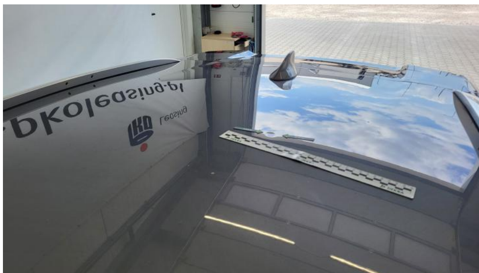
Fot. 67. Dach - Wgniecenie/odkształcenie 1
