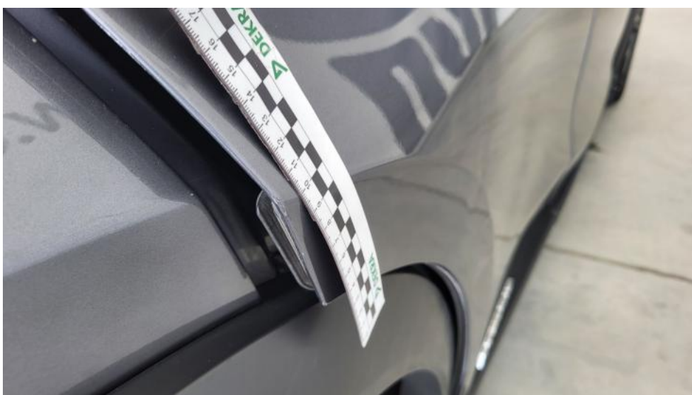
Fot. 52. Drzwi tylne P() - Rysa/odprysk 3
