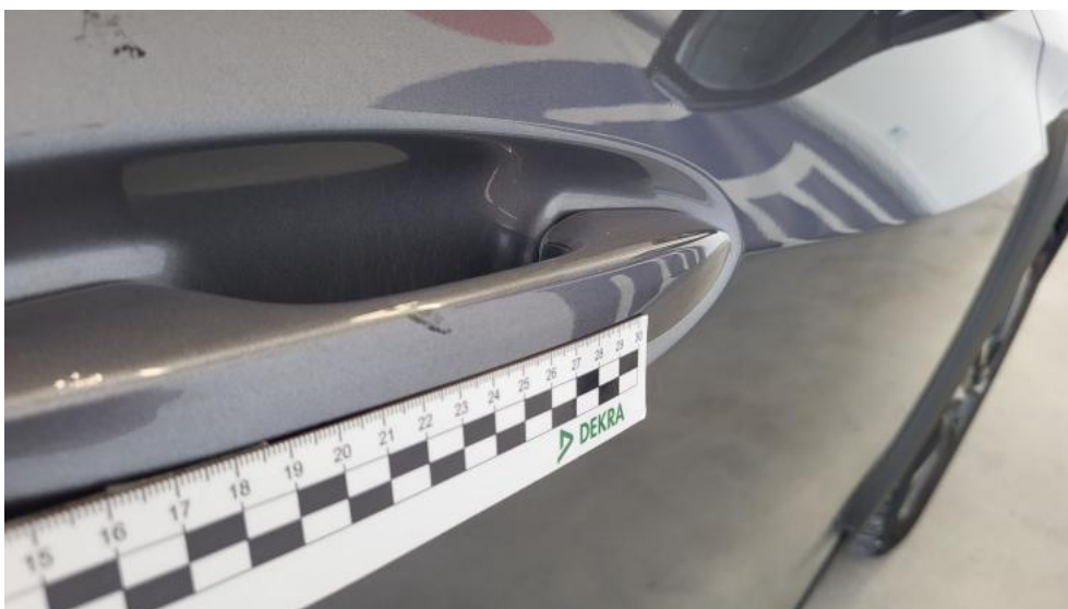
Fot. 54. Klamka drzwi prz P - Rysa/odprysk 1
