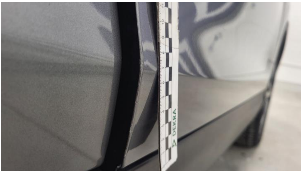
Fot. 51. Drzwi przednie P - Rysa/odprysk 1
