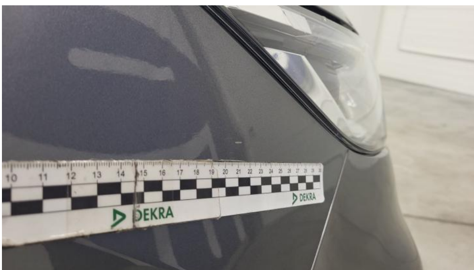
Fot. 46. Błotnik przedni P - Rysa/odprysk 1
