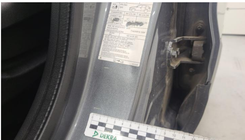
Fot. 96. Słupek środkowy L - Rysa/odprysk 2
