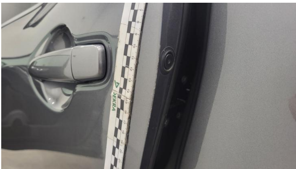
Fot. 91. Drzwi tylne L - Rysa/odprysk 1
