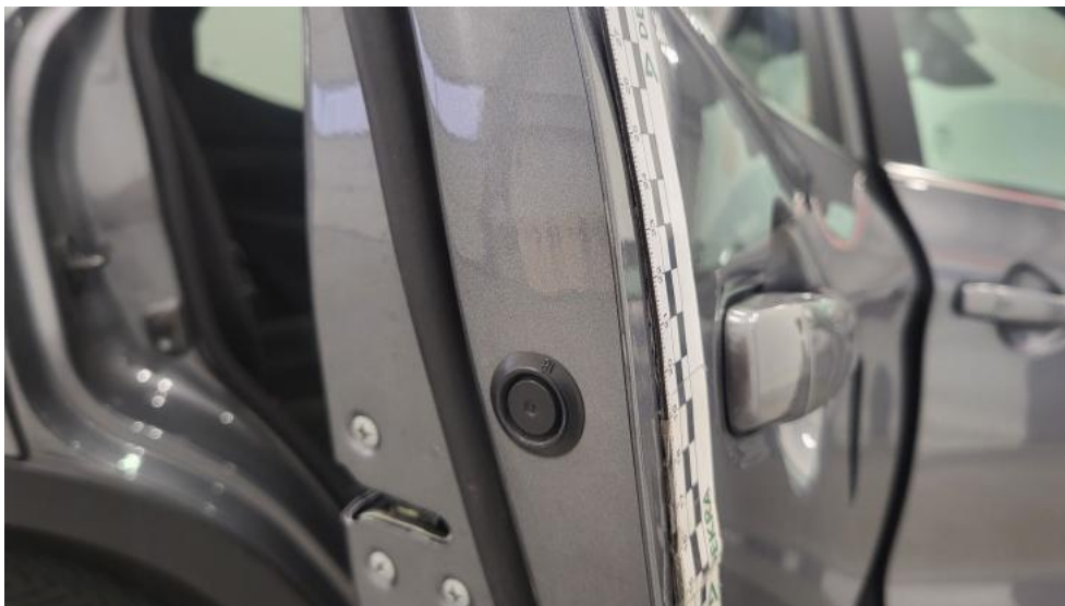
Fot. 55. Drzwi tylne P() - Rysa/odprysk 3
