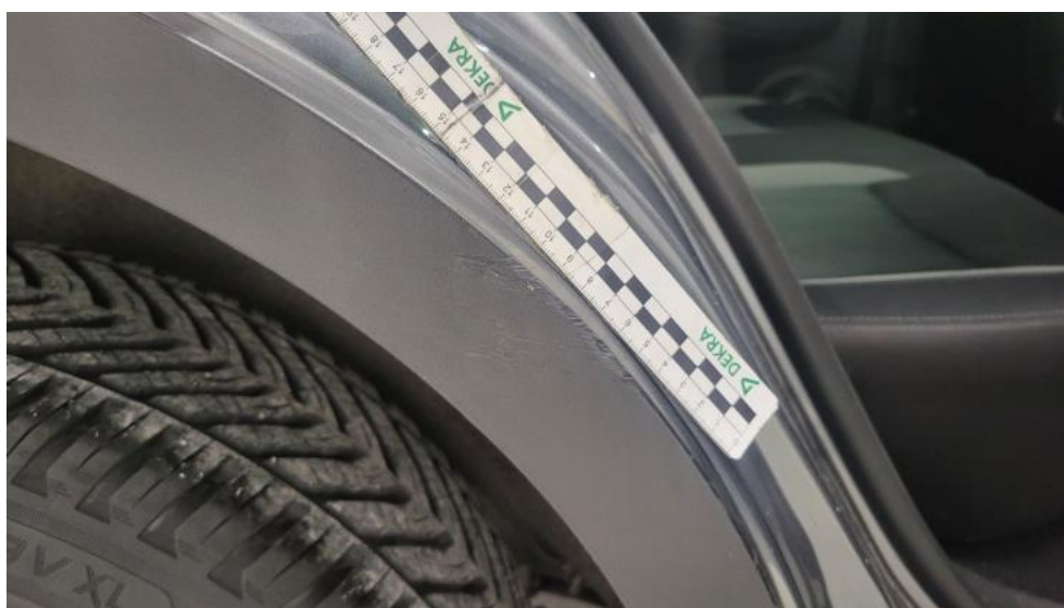
Fot. 70. Listwa krawędzi błotnika tył P - Rysa/odprysk 1
