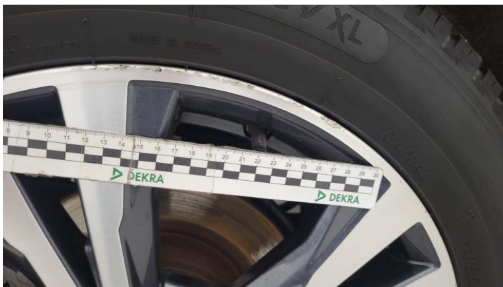
Fot. 69. Felga aluminiowa tylna P - Rysa/odprysk 1
