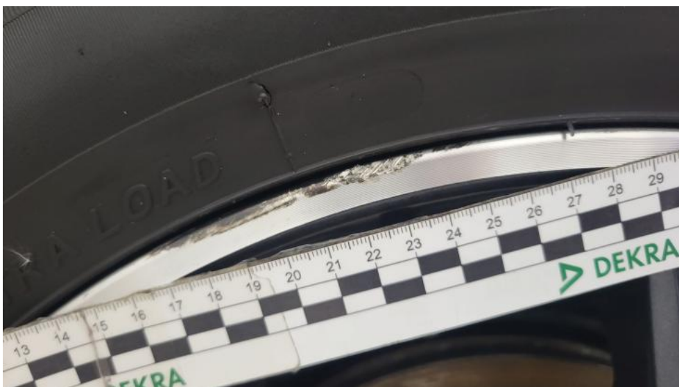
Fot. 50. Felga aluminiowa przednia P - Rysa/odprysk 1
