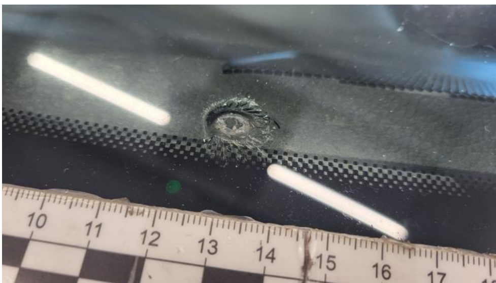
Fot. 42. Szyba czołowa - Pęknięcie/rozerwanie 1
