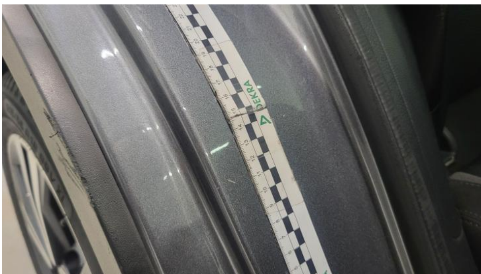
Fot. 66. Błotnik tylny P / Ściana boczna P - Rysa/odprysk 1
