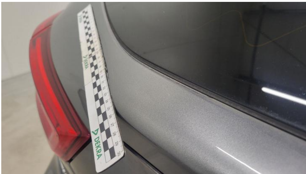
Fot. 73. Pokrywy bagażnika - Rysa/odprysk 2
