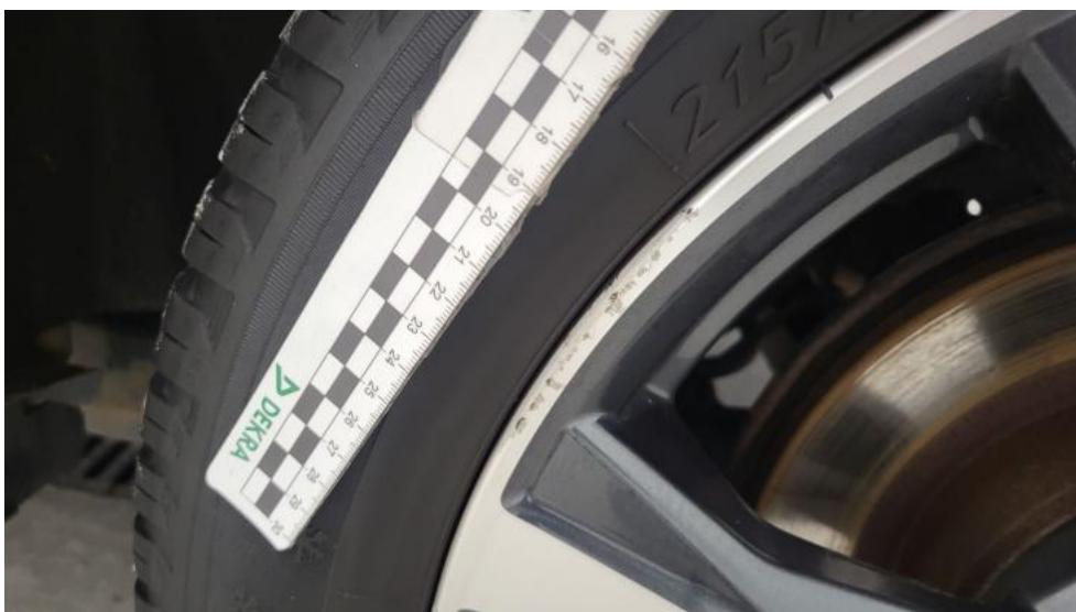
Fot. 84. Felga aluminiowa tylna L - Rysa/odprysk 1
