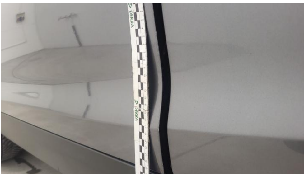
Fot. 87. Drzwi przed L - Rysa/odprysk 2
