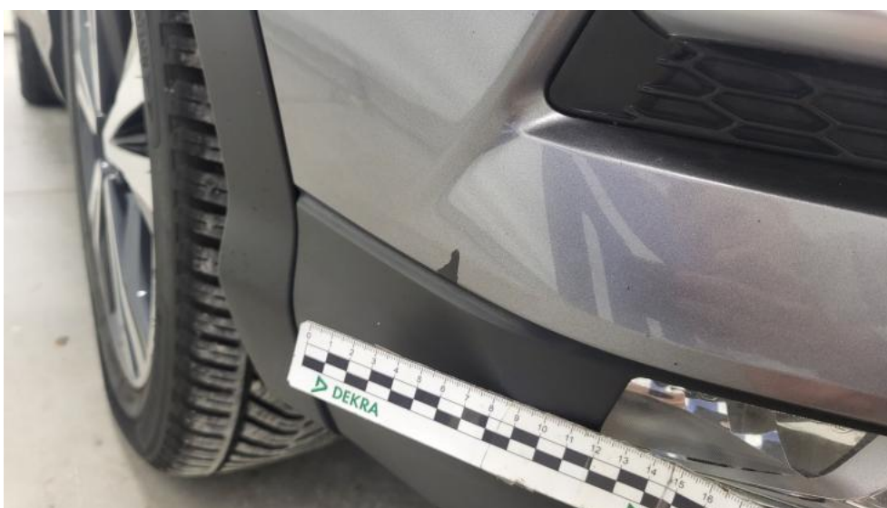
Fot. 44. Zderzak - Rysa/odprysk 2
