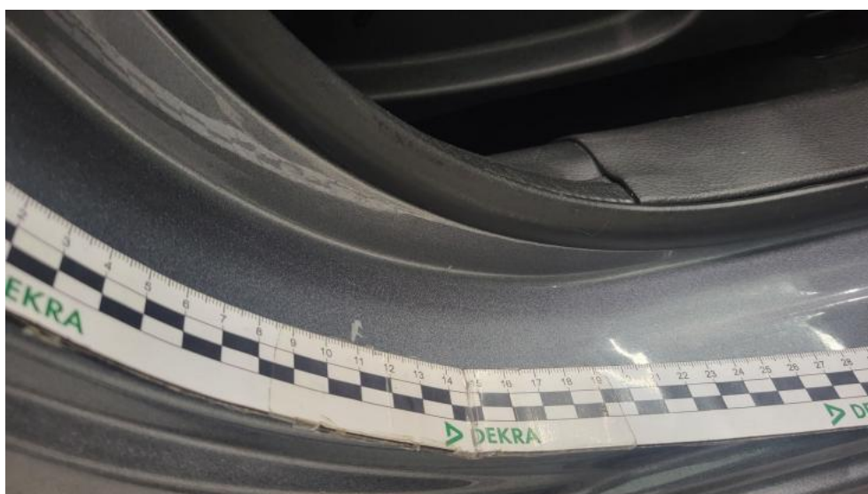
Fot. 62. Próg P - Rysa/odprysk 2
