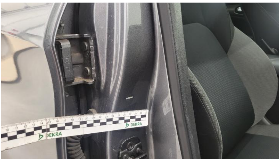
Fot. 63. Słupek środkowy P - Rysa/odprysk 1
