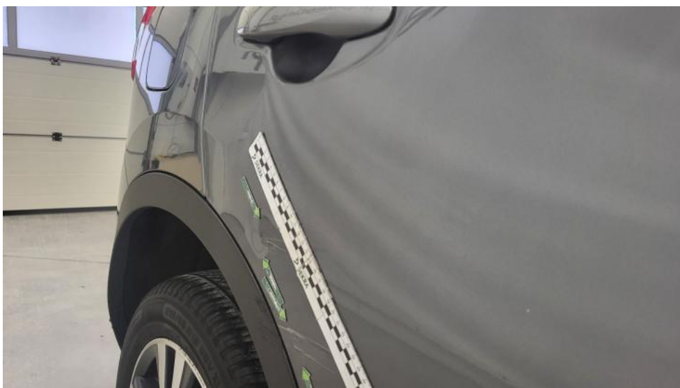
Fot. 56. Drzwi tylne P - Wgniecenie/odkształcenie 1
