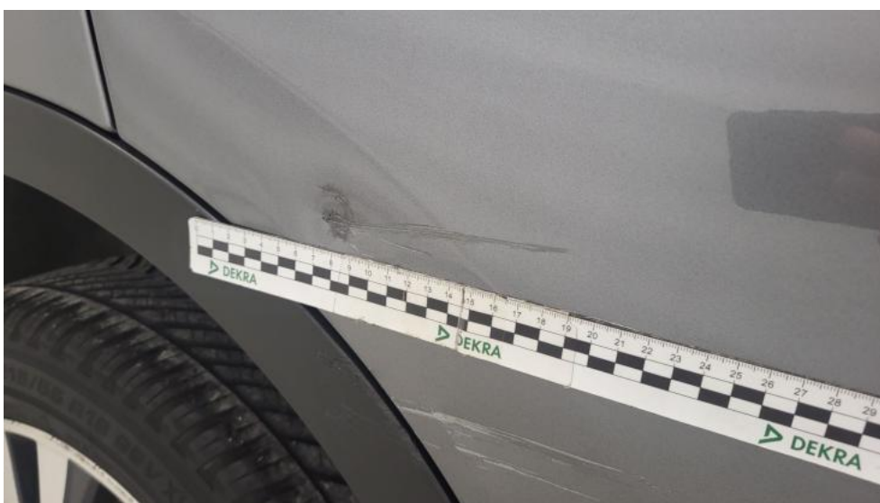
Fot. 54. Drzwi tylne P - Rysa/odprysk 2
