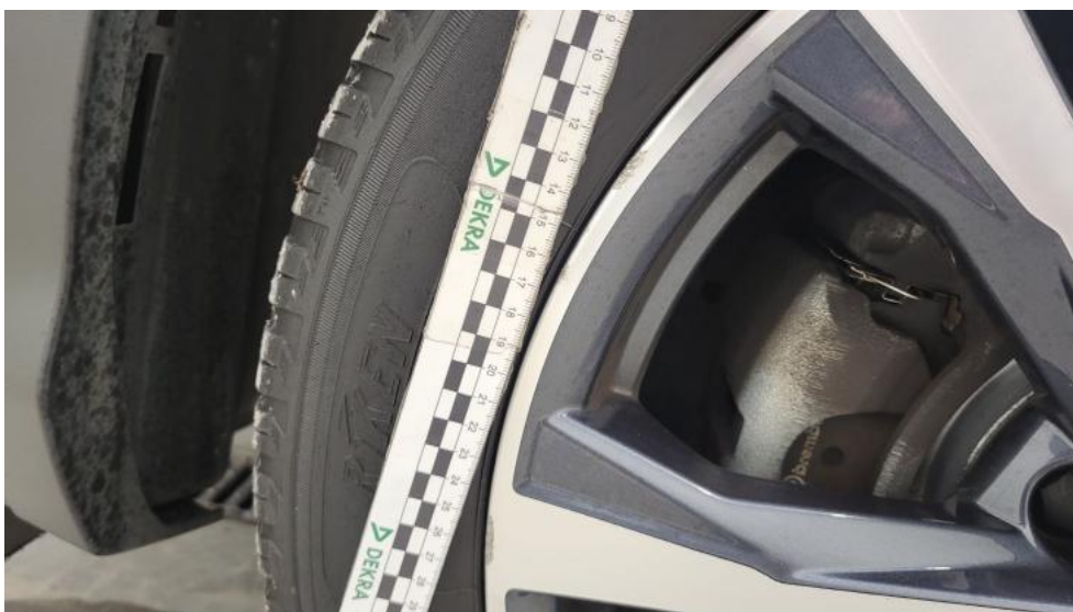
Fot. 102. Felga Aluminiowa przednia L - Rysa/odprysk 1
