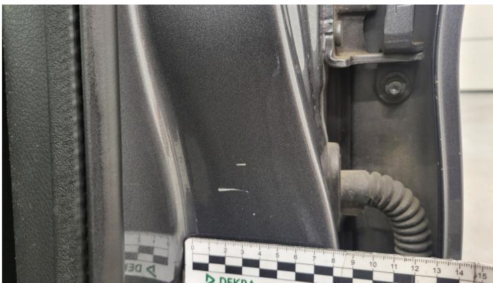
Fot. 95. Słupek środkowy L - Rysa/odprysk 1
