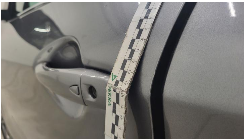
Fot. 88. Drzwi przed L() - Rysa/odprysk 3
