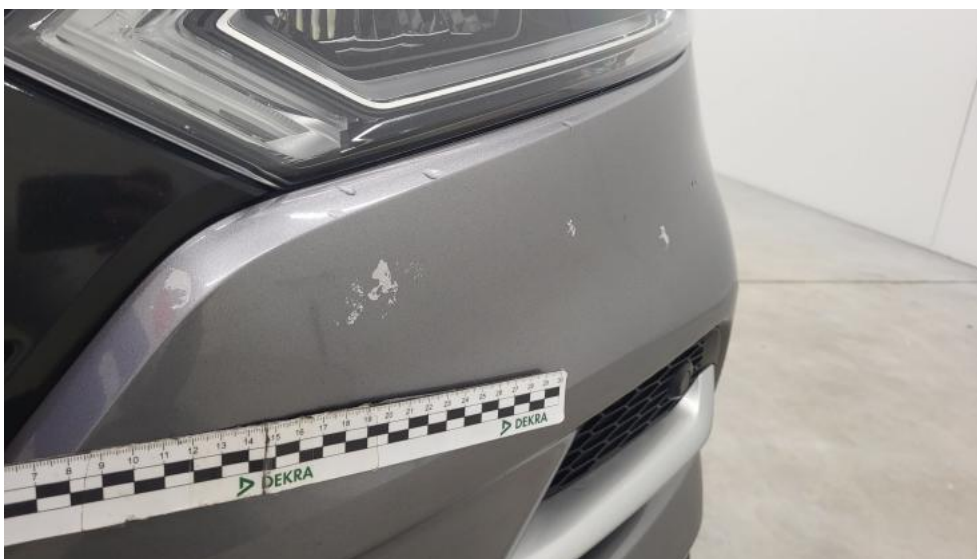
Fot. 43. Zderzak - Rysa/odprysk 1
