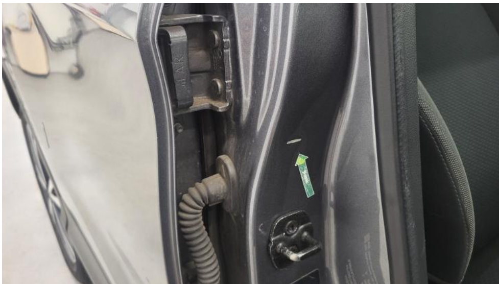
Fot. 65. Słupek środkowy P - Wgniecenie/odkształcenie 1
