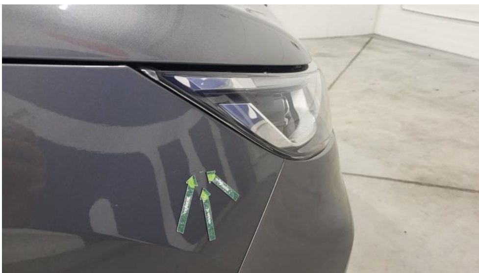
Fot. 48. Błotnik przedni P - Wgniecenie/odkształcenie 2
