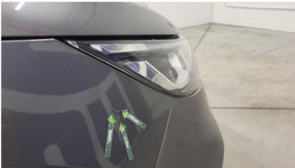
Fot. 47. Błotnik przedni P - Wgniecenie/odkształcenie 1
