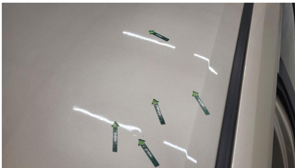
Fot. 69. Dach - Wgniecenie/odkształcenie 1
