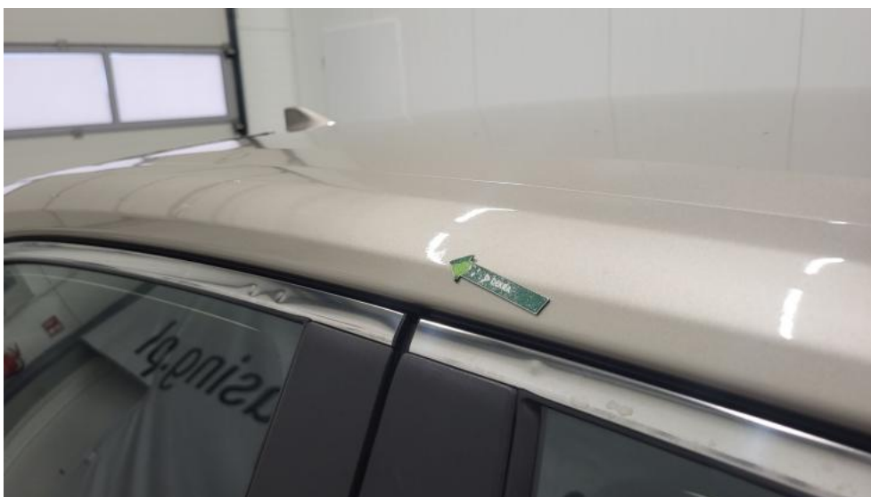
Fot. 56. Słupek przedni P - Wgniecenie/odkształcenie 1
