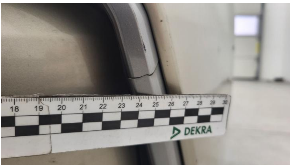
Fot. 44. Zderzak - Pęknięcie/rozerwanie 1
