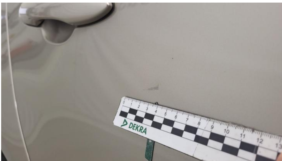
Fot. 50. Drzwi tylne P - Rysa/odprysk 1
