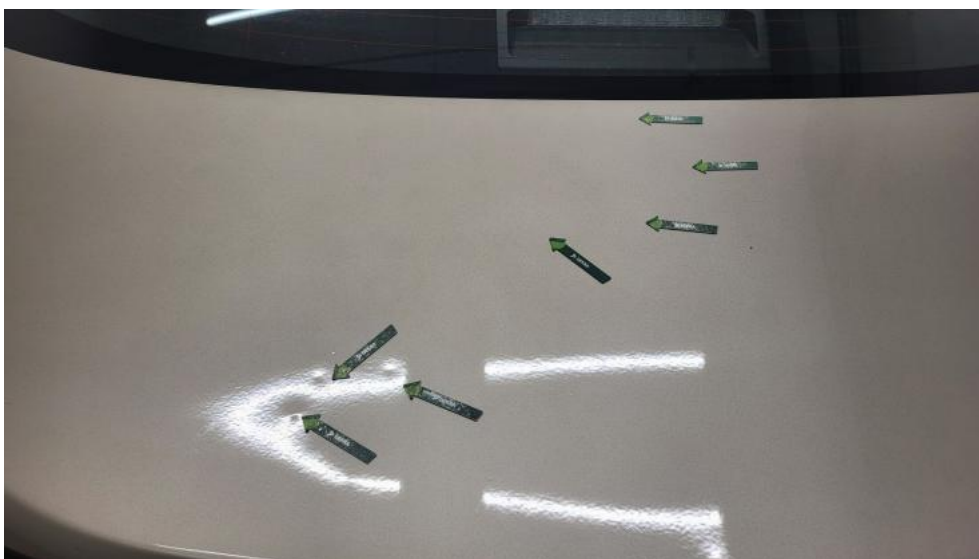
Fot. 61. Pokrywy bagażnika - Wgniecenie/odkształcenie 1
