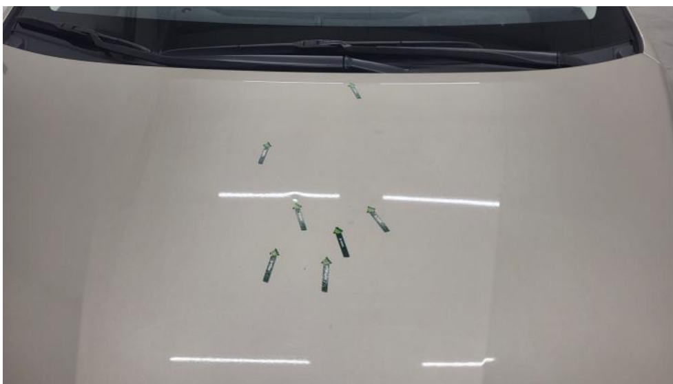
Fot. 40. Pokrywa komory silnika - Wgniecenie/odkształcenie 2
