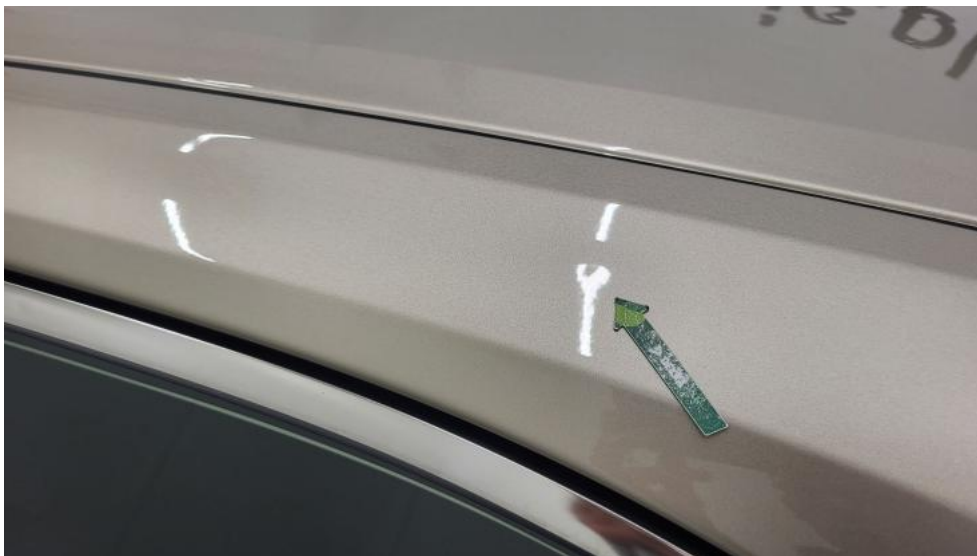
Fot. 73. Błotnik tylny L / Ściana boczna L - Wgniecenie/odkształcenie 2
