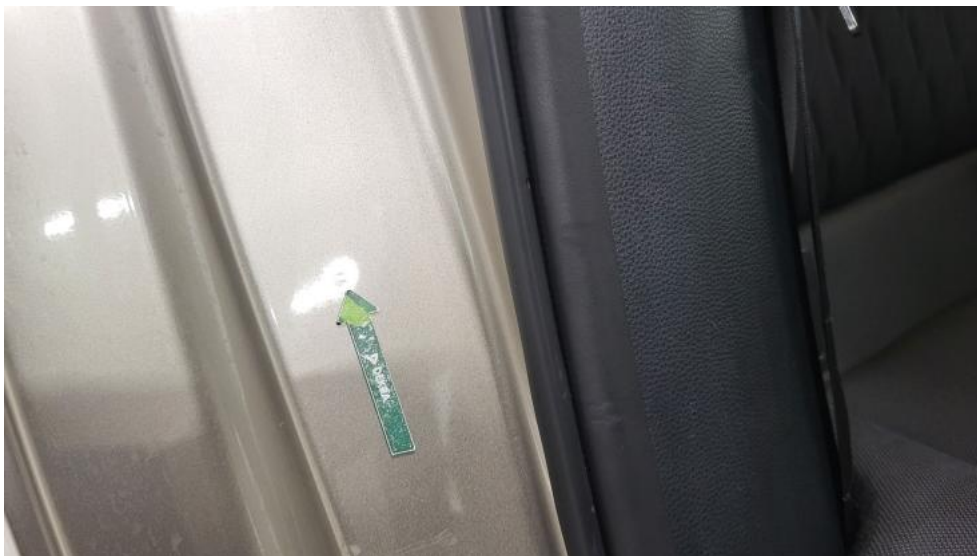
Fot. 57. Stupek przedni P - Wgniecenie/odkształcenie 2
