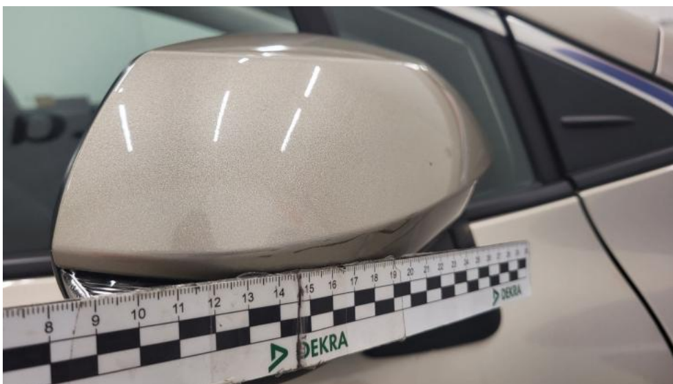
Fot. 54. Lusterko zew P - Rysa/odprysk 1
