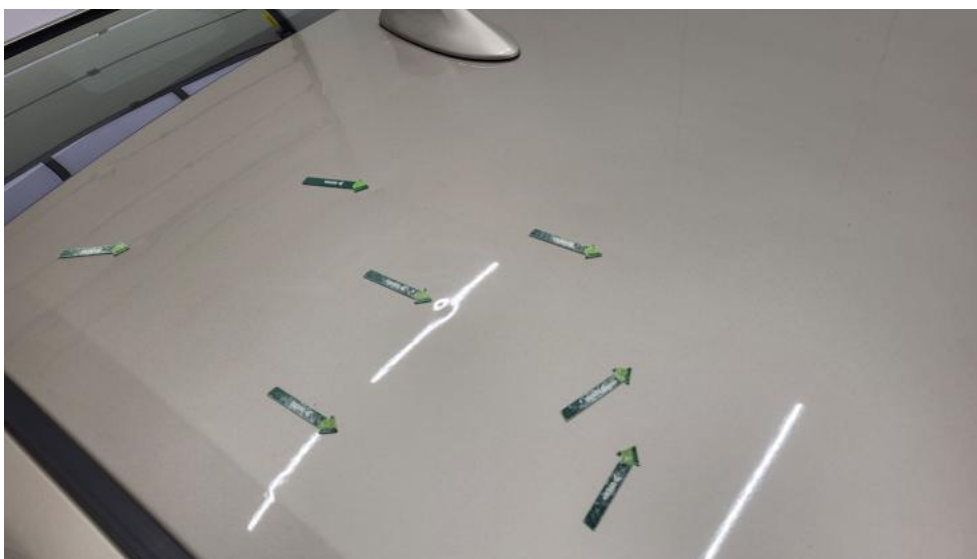
Fot. 71. Dach() - Wgniecenie/odkształcenie 3
