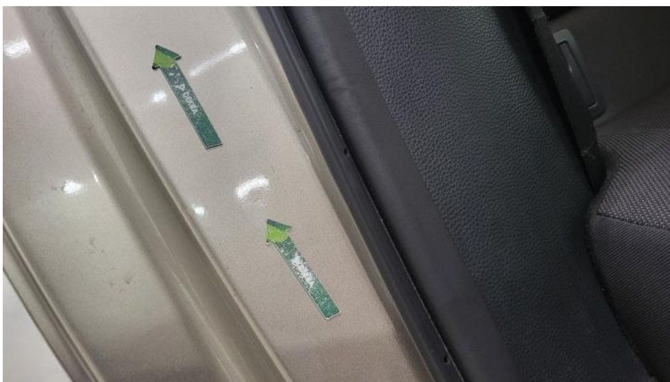
Fot. 58. Stupek przedni P() - Wgniecenie/odkształcenie 3
