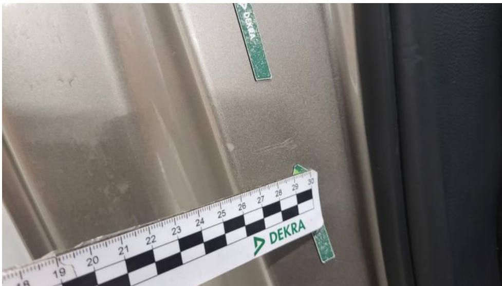
Fot. 55. Słupek przedni P - Rysa/odprysk 1
