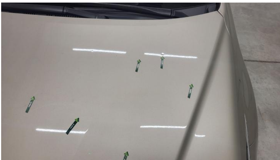
Fot. 39. Pokrywa komory silnika - Wgniecenie/odkształcenie 1
