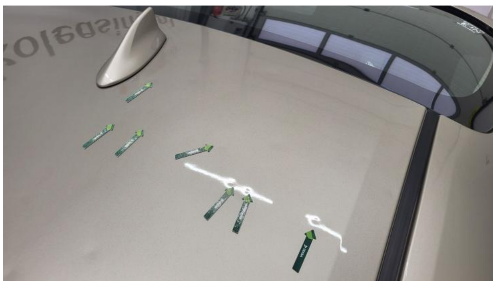
Fot. 70. Dach - Wgniecenie/odkształcenie 2
