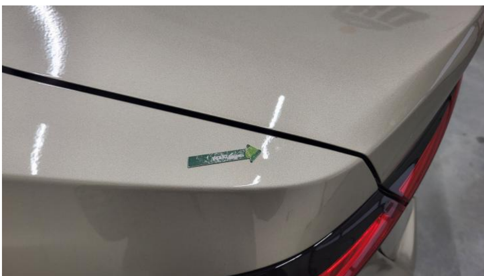
Fot. 72. Błotnik tylny L / Ściana boczna L - Wgniecenie/odkształcenie 1
