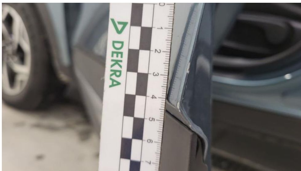
Fot. 63. Drzwi przed L - Rysa/odprysk 2
