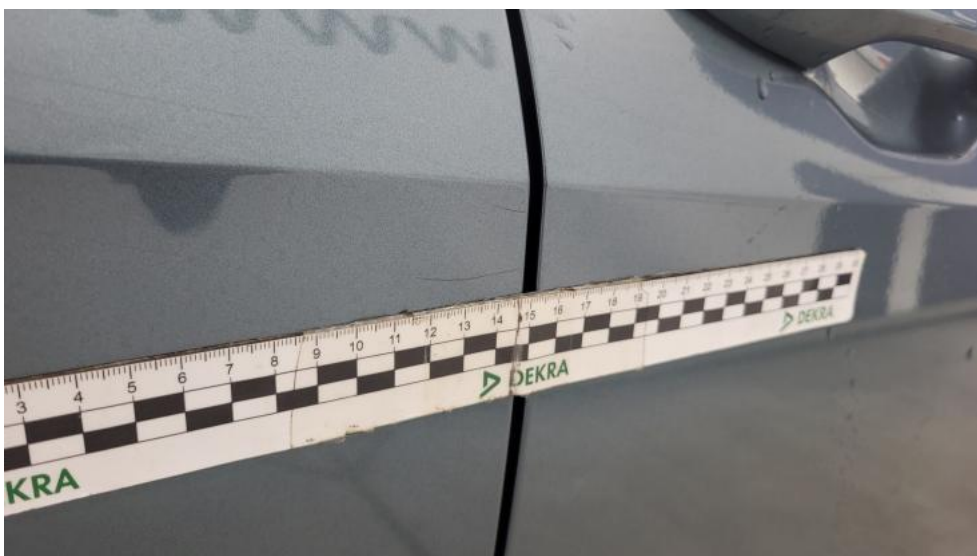
Fot. 42. Drzwi tylne P - Rysa/odprysk 1
