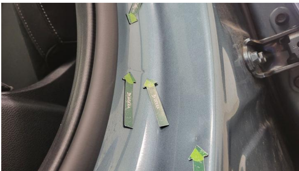
Fot. 70. Słupek środkowy L - Wgniecenie/odkształcenie 2
