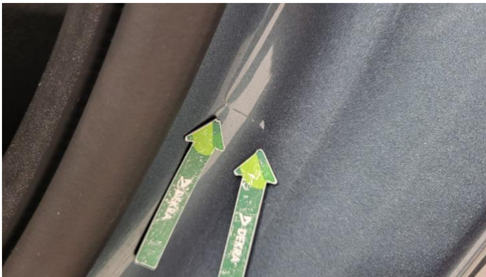
Fot. 67. Słupek środkowy L - Rysa/odprysk 1
