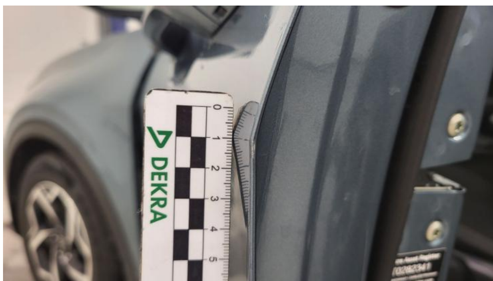
Fot. 64. Drzwi przed L() - Rysa/odprysk 3
