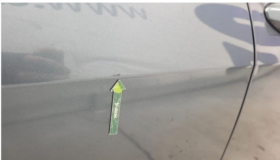
Fot. 43. Drzwi tylne P - Rysa/odprysk 2
