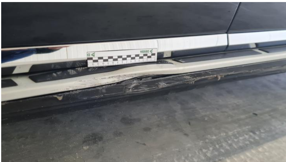
Fot. 53. Próg L - Wgniecenie/odkształcenie 1
