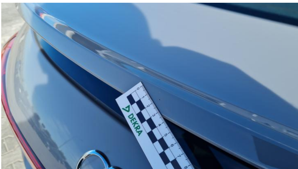
Photo 44. Pokrywy bagażnika - Rysa/odprysk 1
