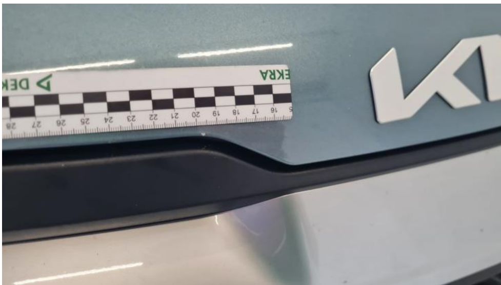
Fot. 33. Pokrywa komory silnika - Rysa/odprysk 1
