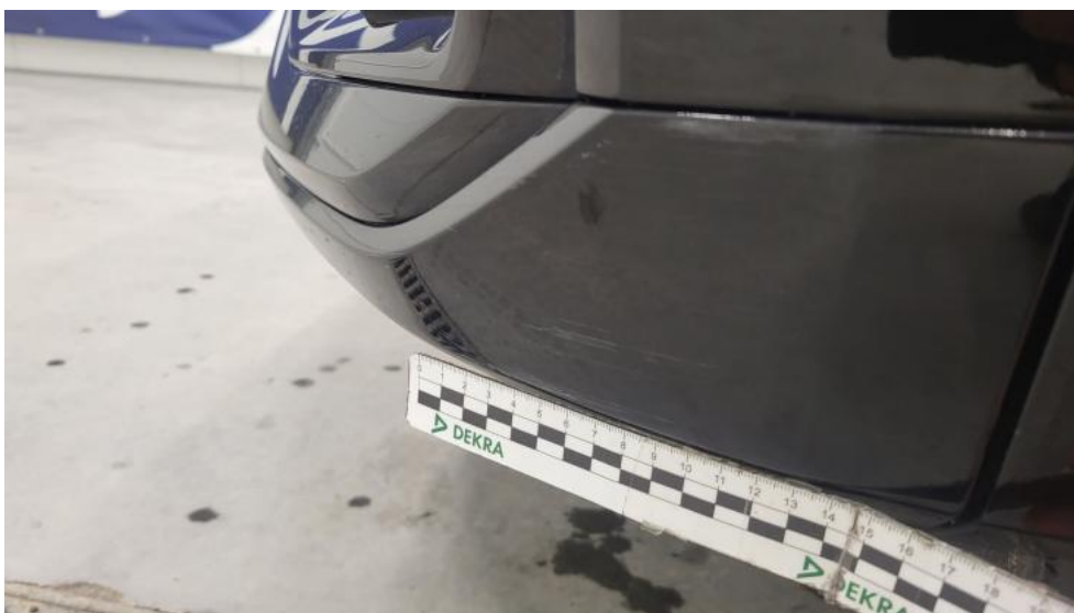
Fot. 58. Zderzak przedni cz L - Rysa/odprysk 1
