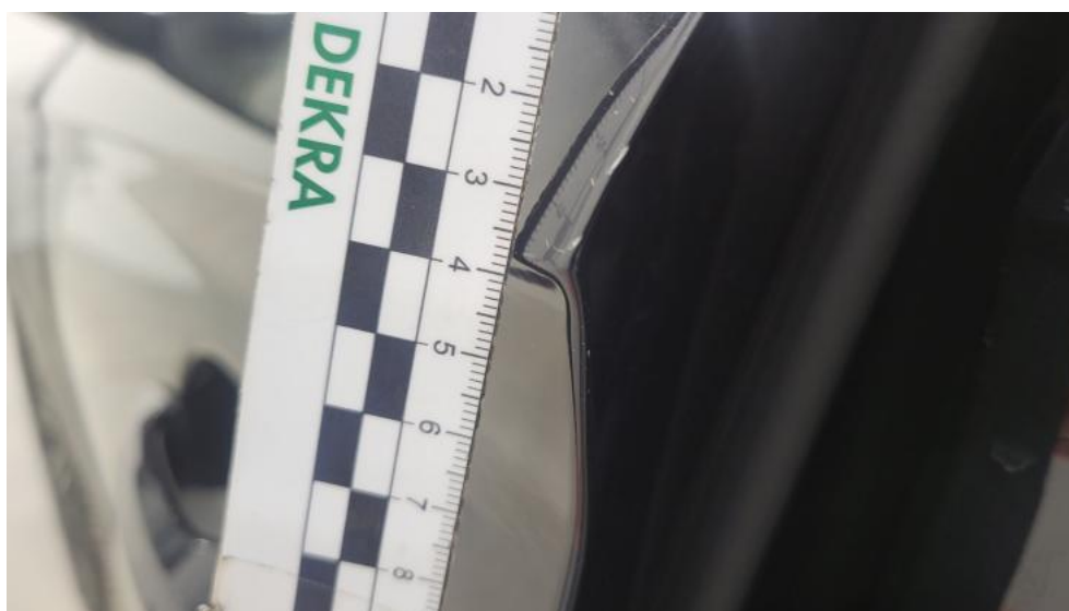
Fot. 70. Drzwi przed L - Rysa/odprysk 1
