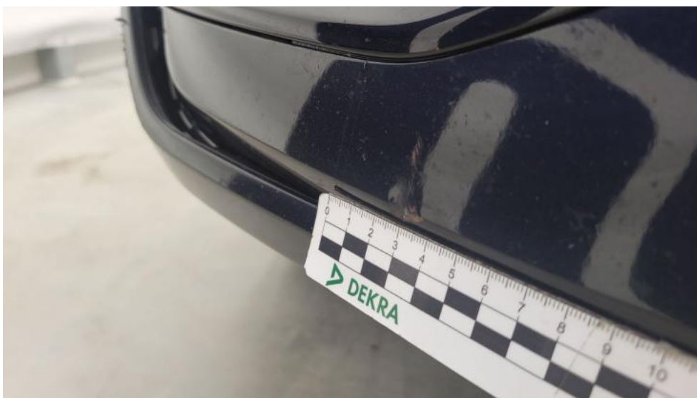
Fot. 56. Zderzak przedni cz dolna - Rysa/odprysk 1
