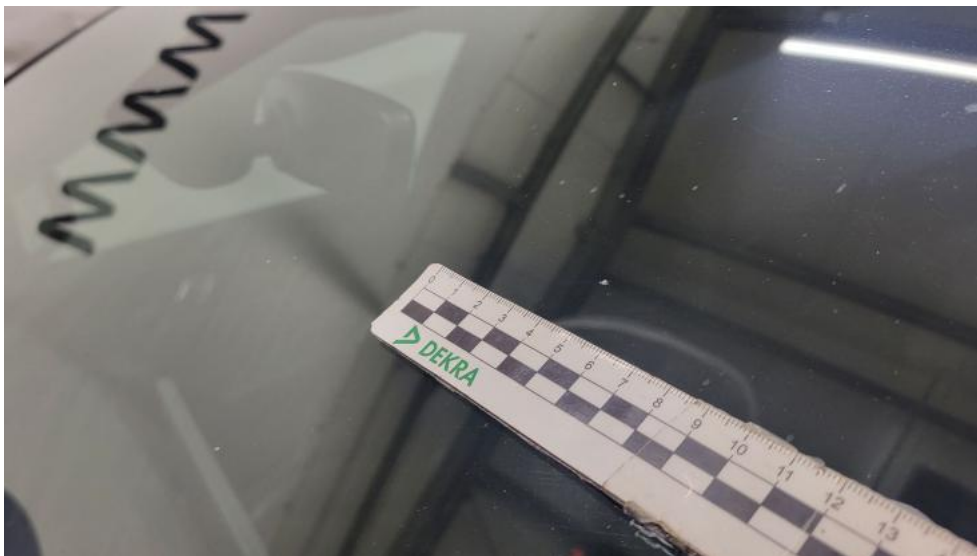
Fot. 49. Szyba czołowa - Rysa/odprysk 1
