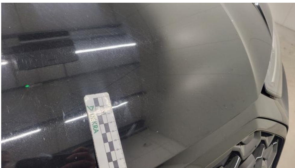
Fot. 48. Pokrywa komory silnika - Wgniecenie/odkształcenie 1
