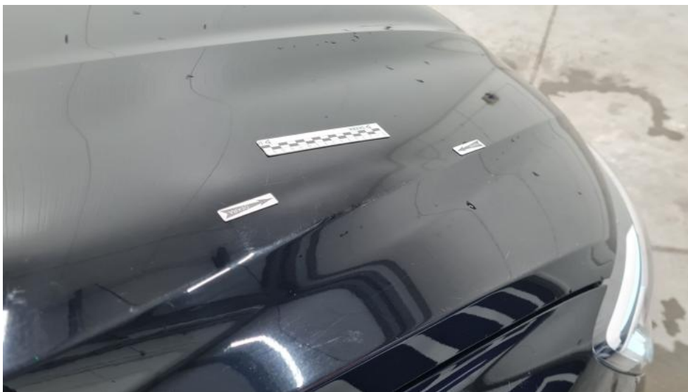
Fot. 39. Pokrywa komory silnika - Wgniecenie/odkształcenie 1
