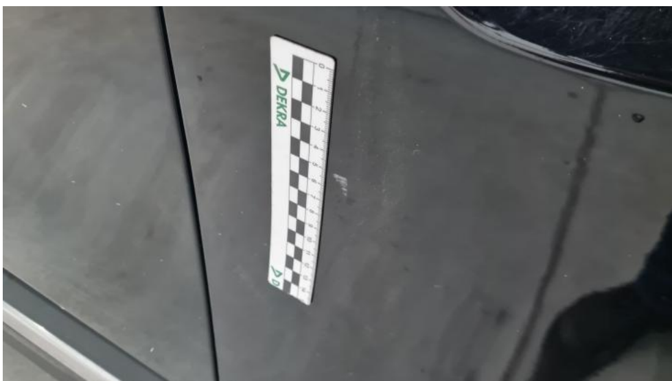
Fot. 46. Drzwi przednie P - Rysa/odprysk 1
