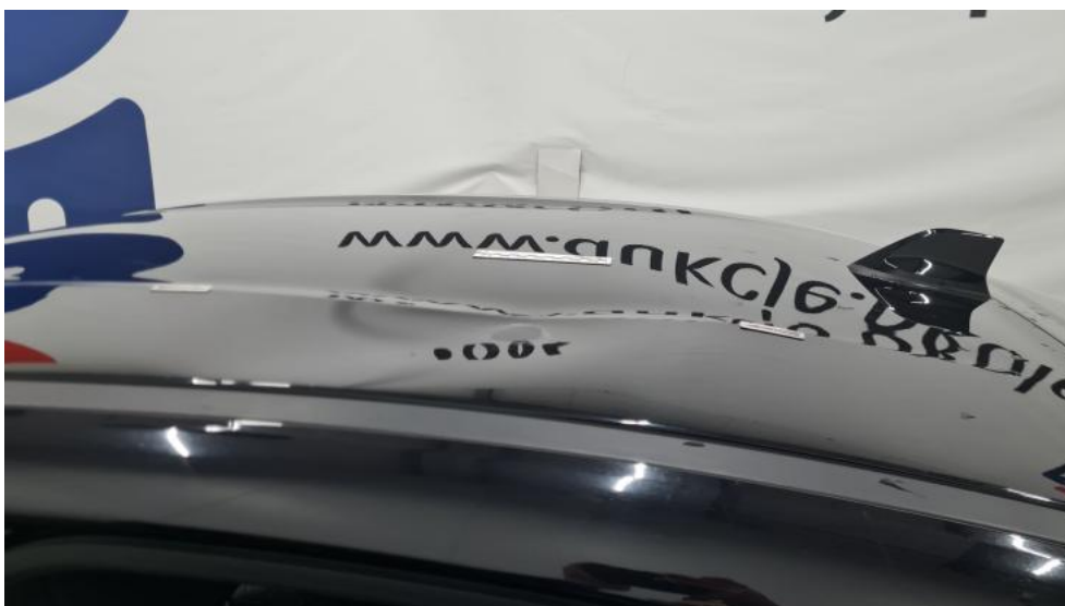
Fot. 60. Dach - Wgniecenie/odkształcenie 1
