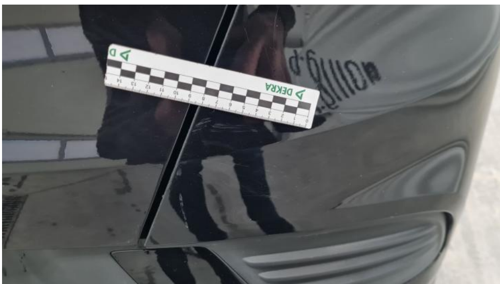
Fot. 58. Zderzak tylny - Rysa/odprysk 1
