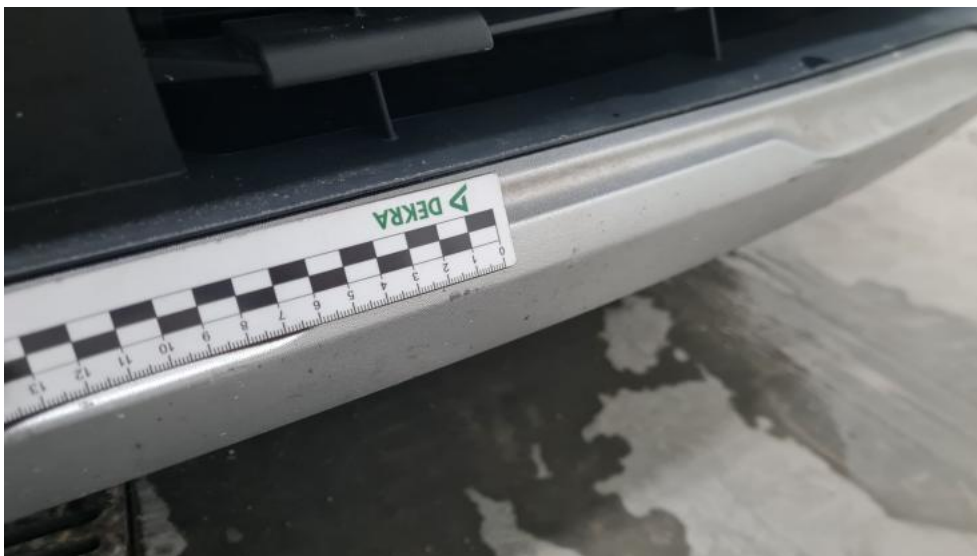
Fot. 43. Spoiler zderzaka przedniego - Rysa/odprysk 1
