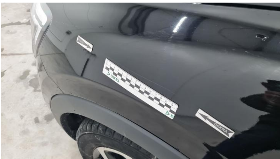
Fot. 72. Błotnik przedni L - Rysa/odprysk 1
