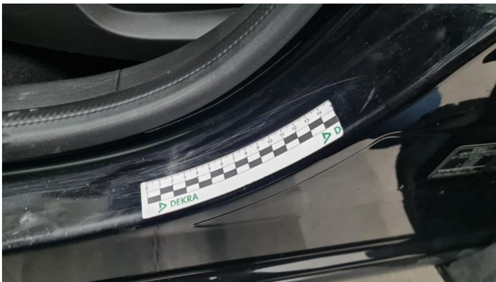
Fot. 71. Słupek środkowy L - Rysa/odprysk 1
