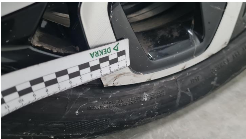
Fot. 73. Felga Aluminiowa przednia L - Rysa/odprysk 1
