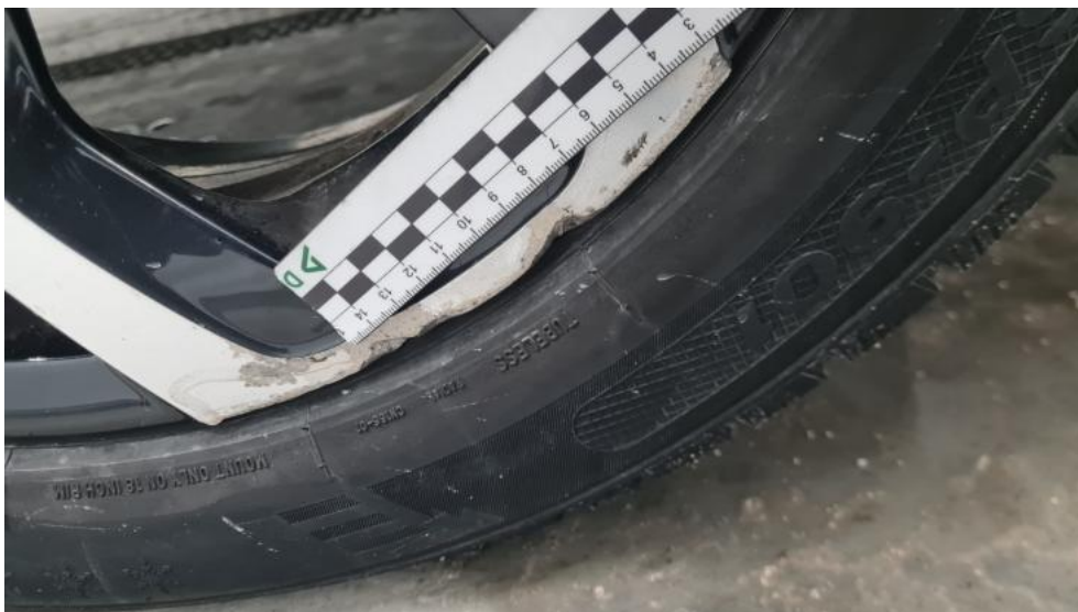
Fot. 45. Felga aluminiowa przednia P - Rysa/odprysk 1
