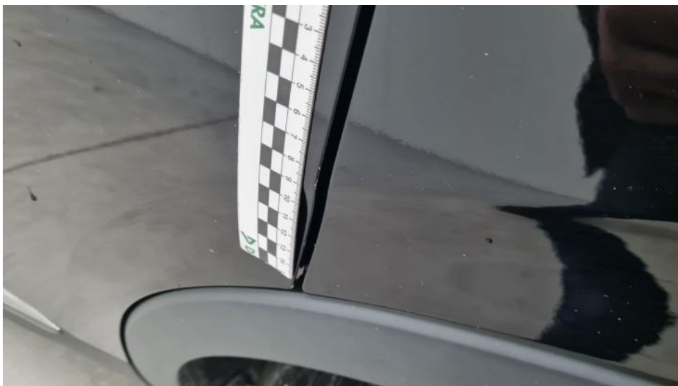
Fot. 65. Drzwi tylne L - Rysa/odprysk 1
