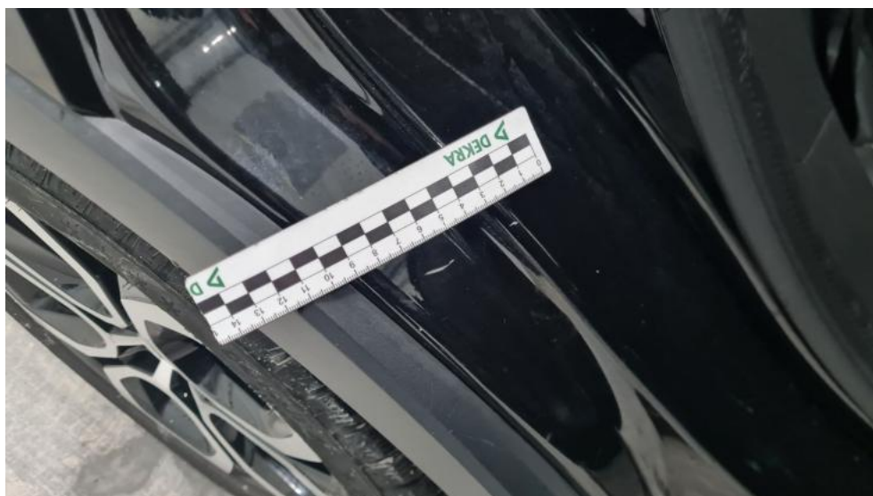
Fot. 52. Błotnik tylny P / Ściana boczna P - Rysa/odprysk 1
