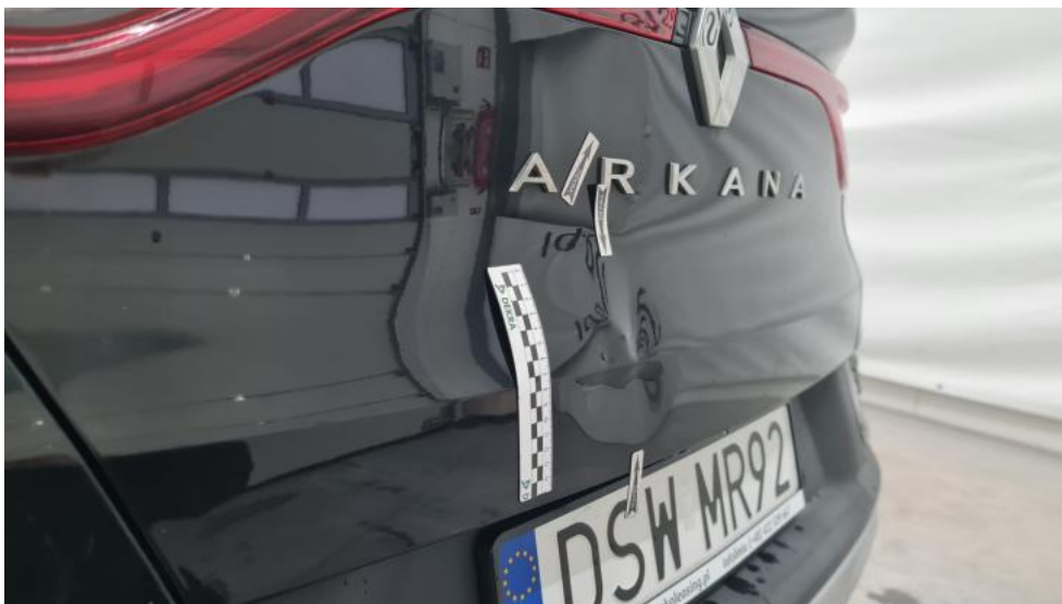
Fot. 57. Pokrywy bagażnika - Wgniecenie/odkształcenie 1
