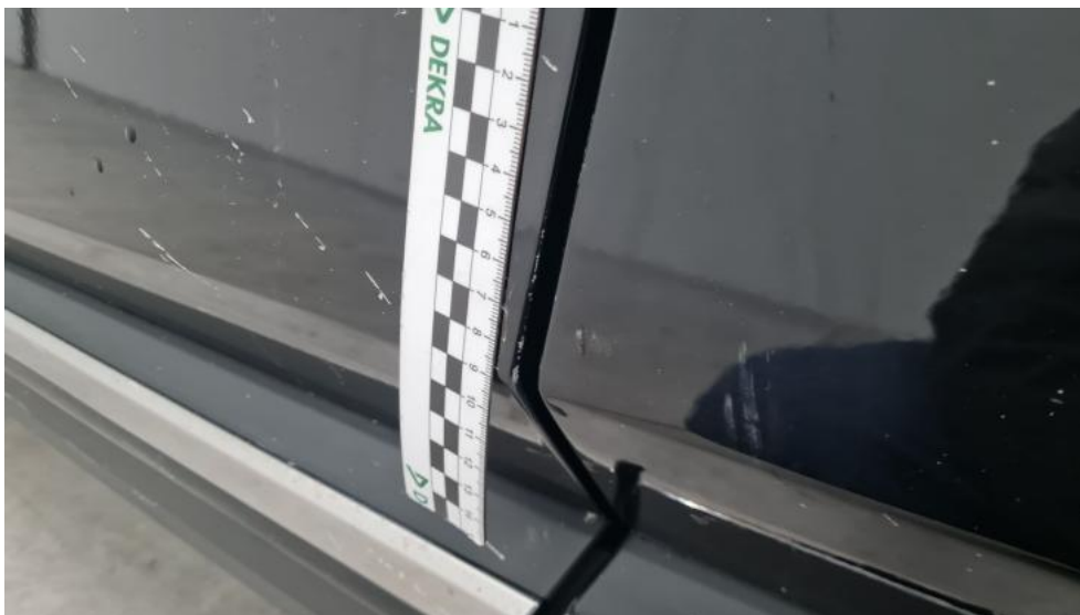
Fot. 63. Drzwi przed L - Rysa/odprysk 1
