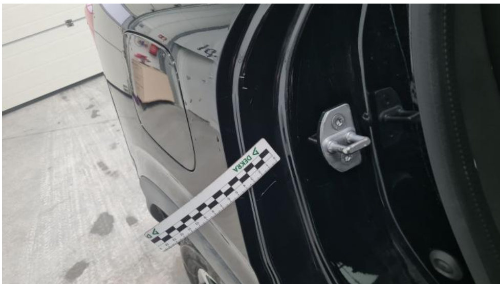
Fot. 53. Błotnik tylny P / Ściana boczna P - Rysa/odprysk 2
