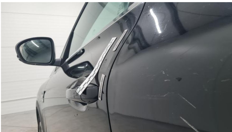
Fot. 64. Drzwi przed L - Wgniecenie/odkształcenie 1
