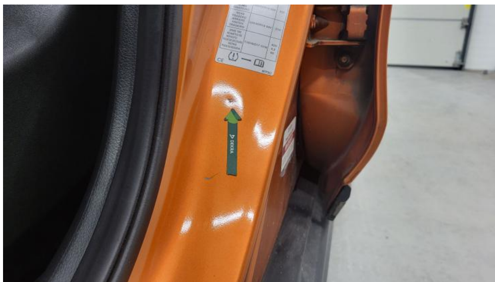
Fot. 111. Stupek środkowy L - Wgniecenie/odkształcenie 1
