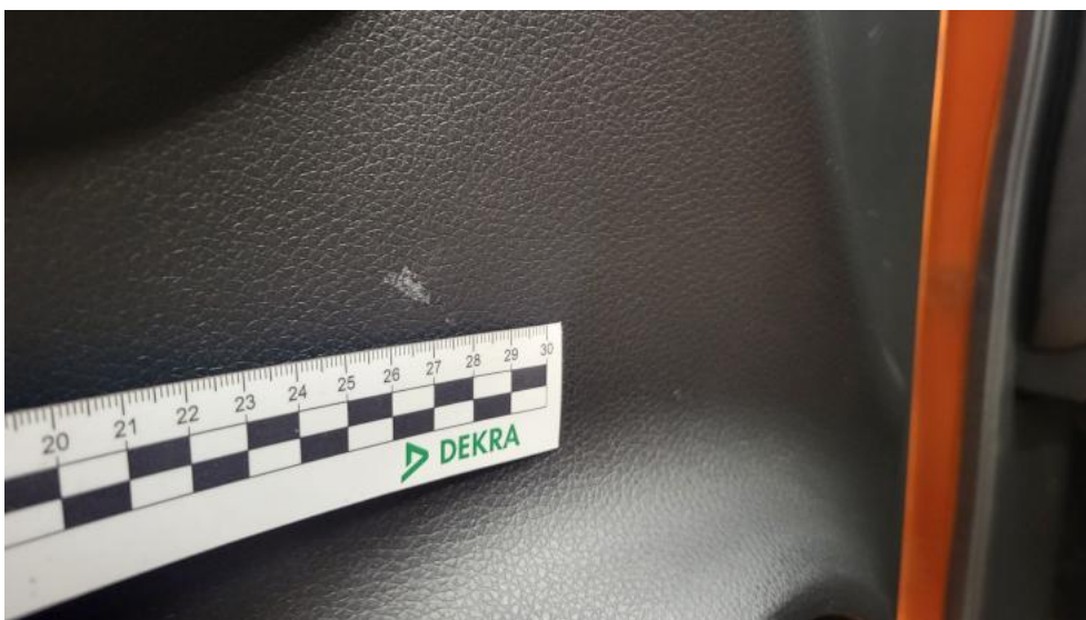
Fot. 120. Tapicerka drzwi przednich L - Rysa/odprysk 1
