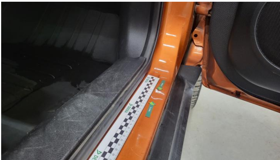
Fot. 71. Próg P - Wgniecenie/odkształcenie 1
