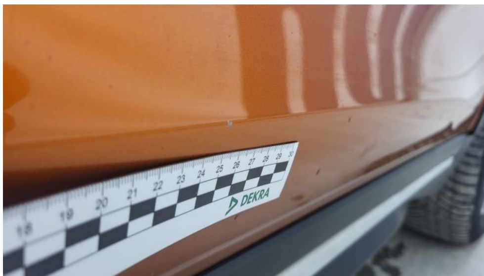
Fot. 59. Drzwi przednie P - Rysa/odprysk 2
