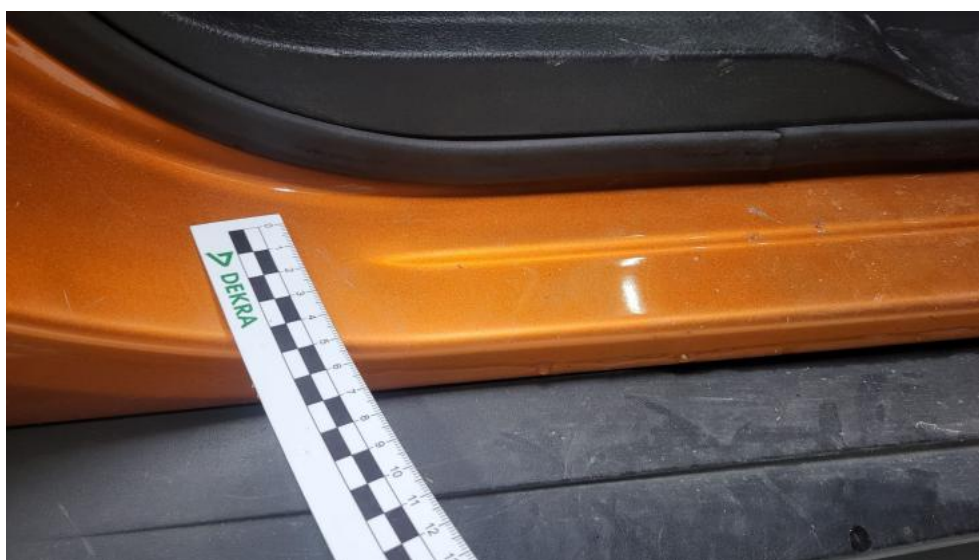
Fot. 70. Próg P - Rysa/odprysk 2
