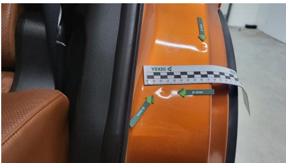
Fot. 96. Błotnik tylny L / Ściana boczna L - Wgniecenie/odkształcenie 1
