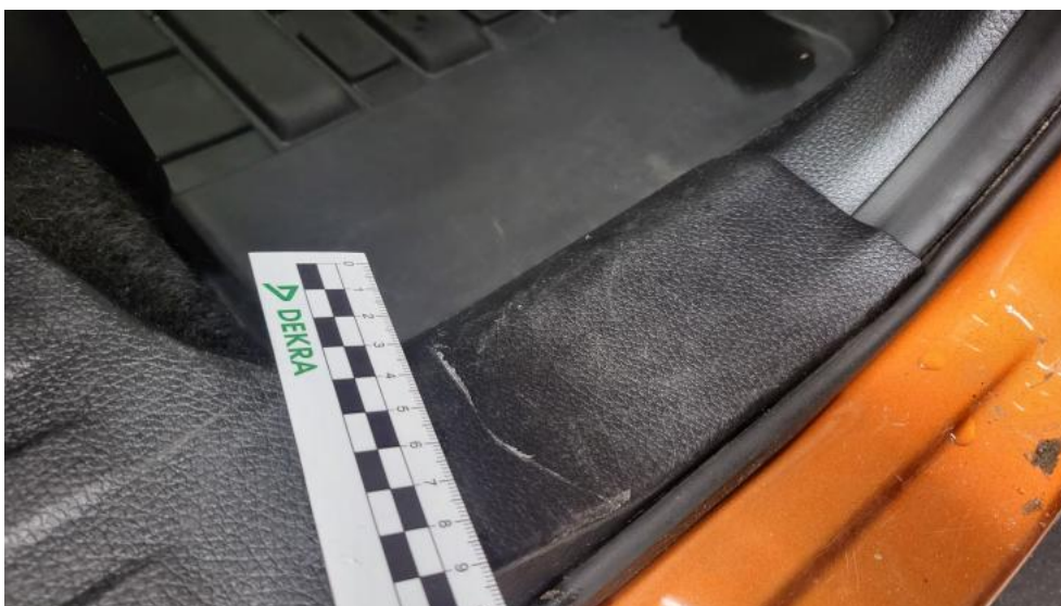
Fot. 124. Listwy progowe praw. - Rysa/odprysk 1
