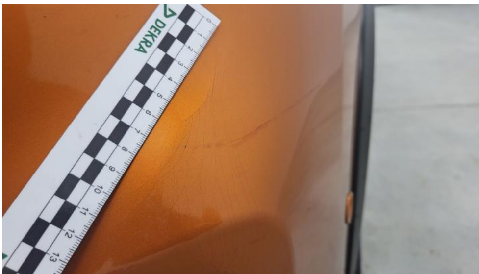
Fot. 53. Zderzak - Pęknięcie/rozerwanie 1
