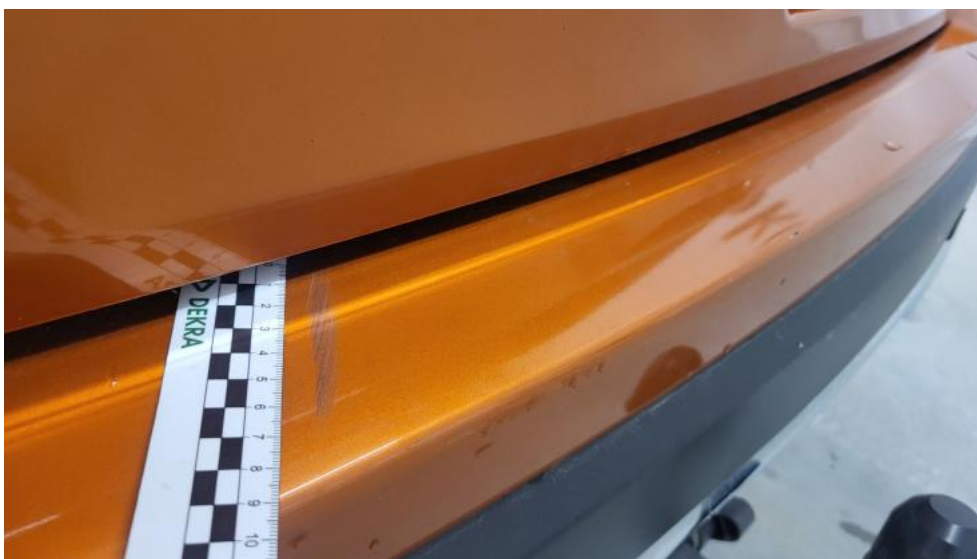
Fot. 87. Zderzak tylny - Rysa/odprysk 2
