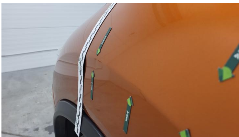
Fot. 116. Błotnik przedni L - Wgniecenie/odkształcenie 2
