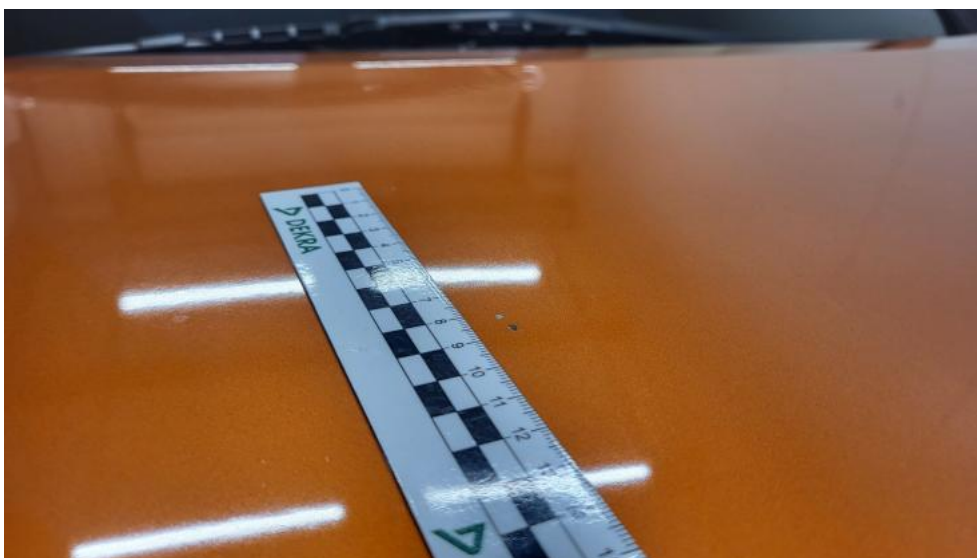
Fot. 44. Pokrywa komory silnika - Rysa/odprysk 1
