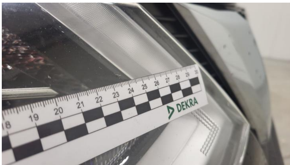
Fot. 57. Reflektor P - Rysa/odprysk 1
