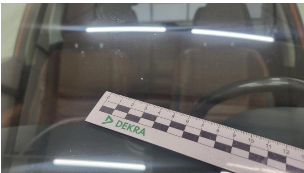
Fot. 48. Szyba czołowa - Rysa/odprysk 1
