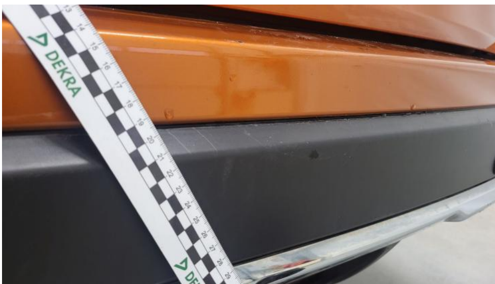
Fot. 91. Zderzak tylny cz dolna() - Rysa/odprysk 3
