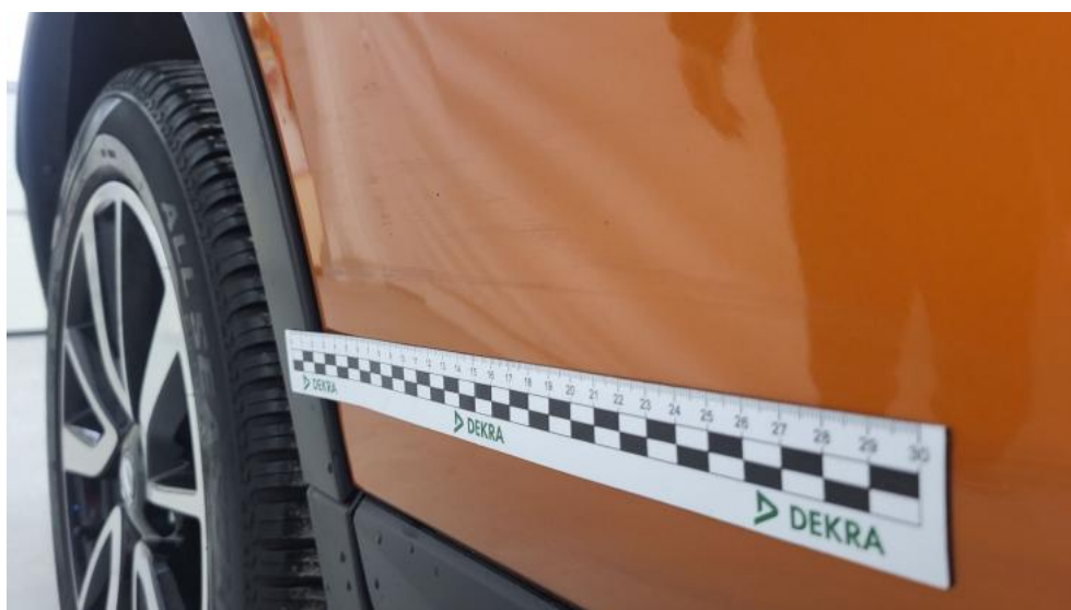
Fot. 66. Drzwi tylne P() - Rysa/odprysk 3
