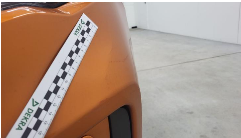
Fot. 52. Zderzak - Wgniecenie/odkształcenie 1
