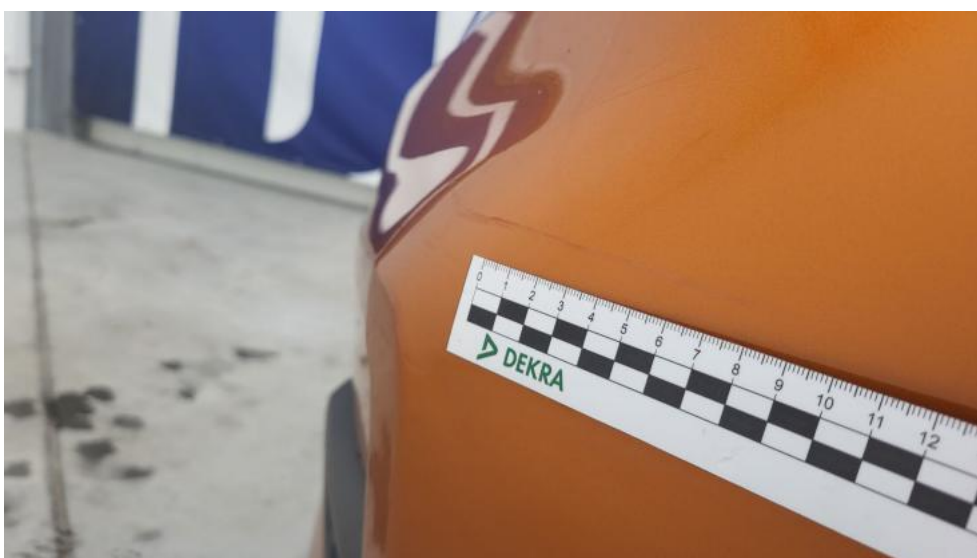
Fot. 50. Zderzak - Rysa/odprysk 1
