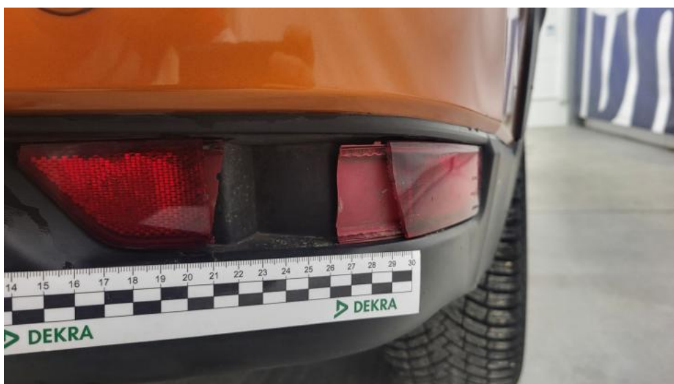
Fot. 80. Lampa przeciwmgielna tylna P - Pęknięcie/rozerwanie 1
