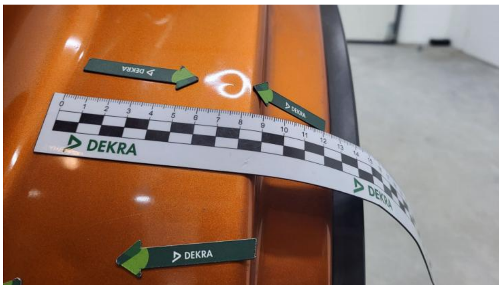
Fot. 97. Błotnik tylny L / Ściana boczna L - Wgniecenie/odkształcenie 2
