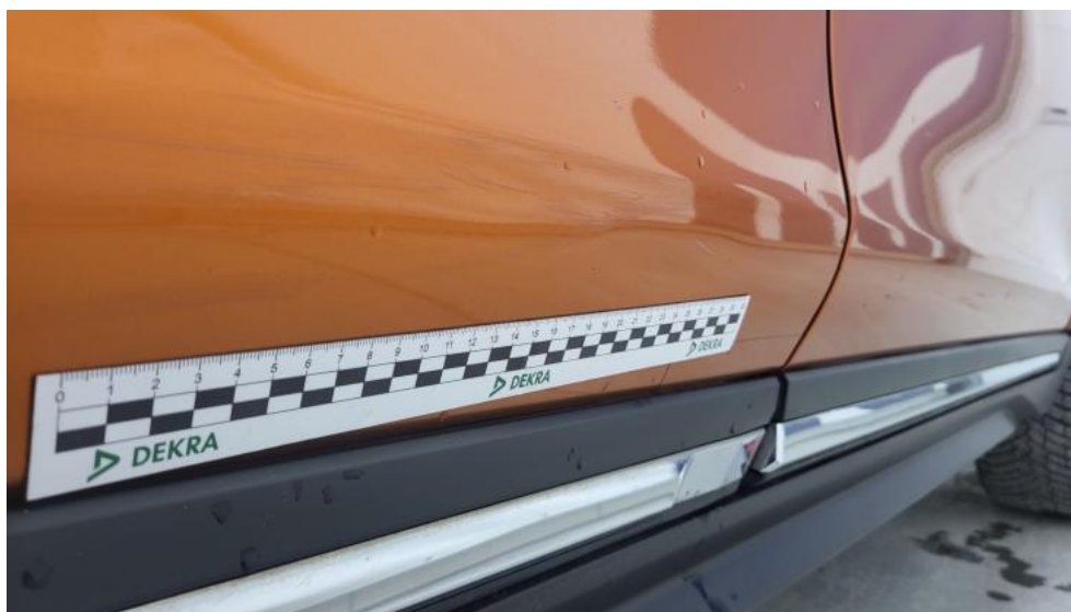
Fot. 65. Drzwi tylne P - Rysa/odprysk 2
