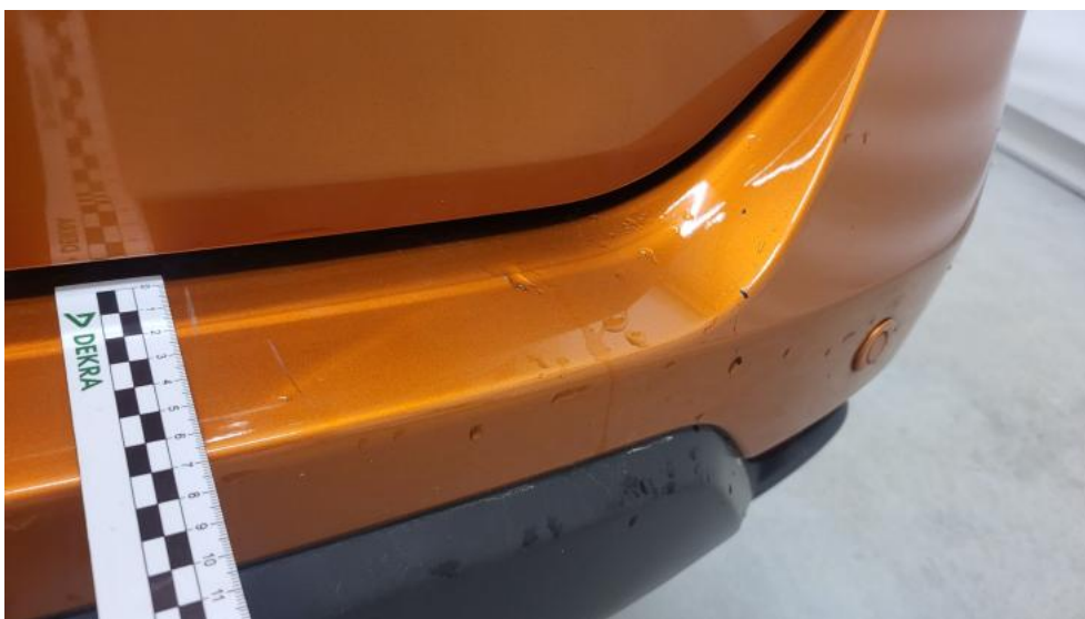
Fot. 86. Zderzak tylny - Rysa/odprysk 1
