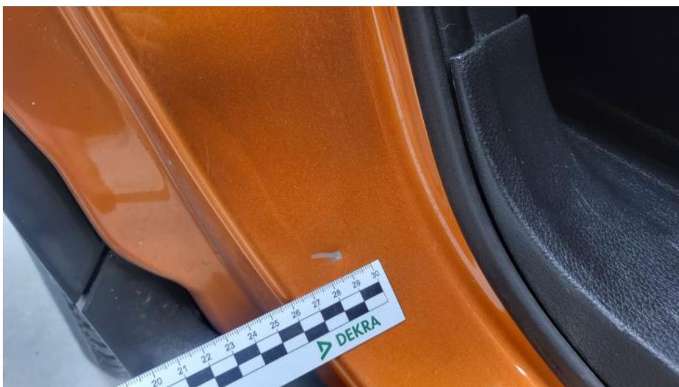
Fot. 74. Błotnik tylny P / Ściana boczna P - Rysa/odprysk 1
