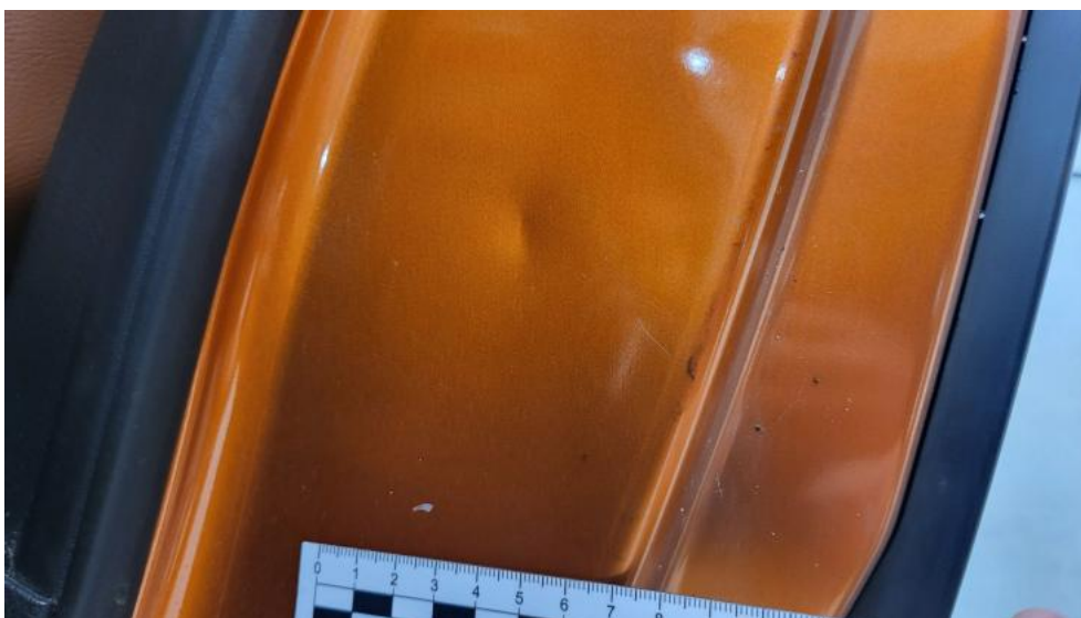
Fot. 95. Błotnik tylny L / Ściana boczna L - Rysa/odprysk 1
