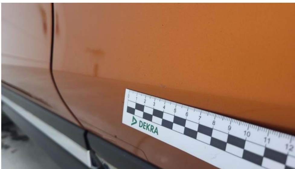
Fot. 103. Drzwi tylne L - Rysa/odprysk 1
