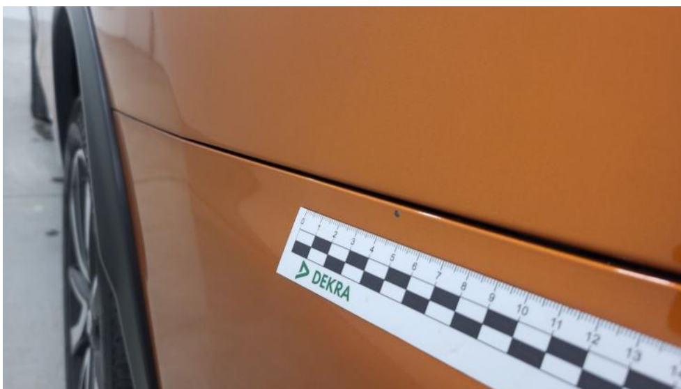
Fot. 88. Zderzak tylny() - Rysa/odprysk 3
