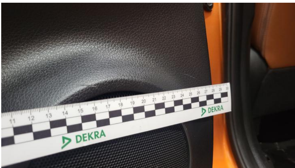
Fot. 122. Tapicerka drzwi tylnych L - Rysa/odprysk 1
