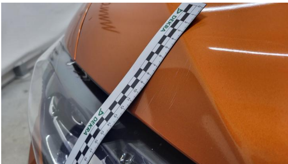
Fot. 46. Pokrywa komory silnika() - Rysa/odprysk 3
