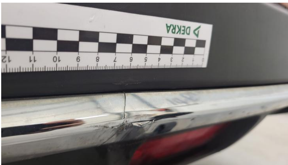
Fot. 90. Zderzak tylny cz dolna - Rysa/odprysk 2
