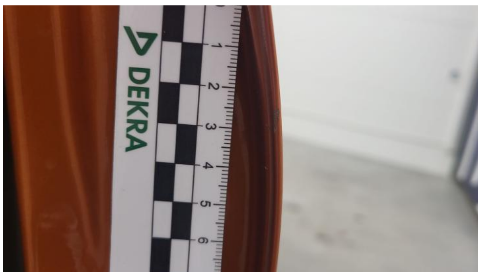
Fot. 60. Drzwi przednie P() - Rysa/odprysk 3
