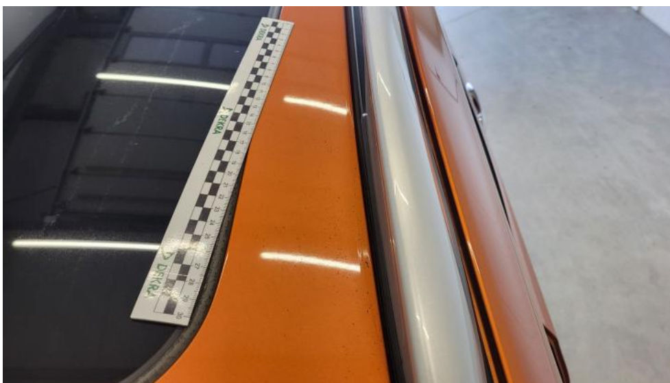
Fot. 93. Dach - Rysa/odprysk 2
