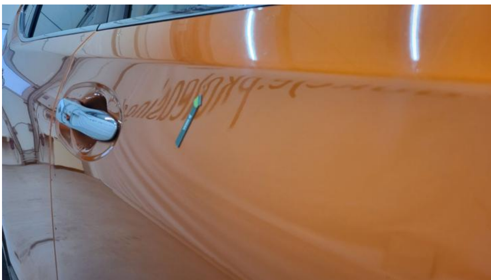
Fot. 61. Drzwi przednie P - Wgniecenie/odkształcenie 1
