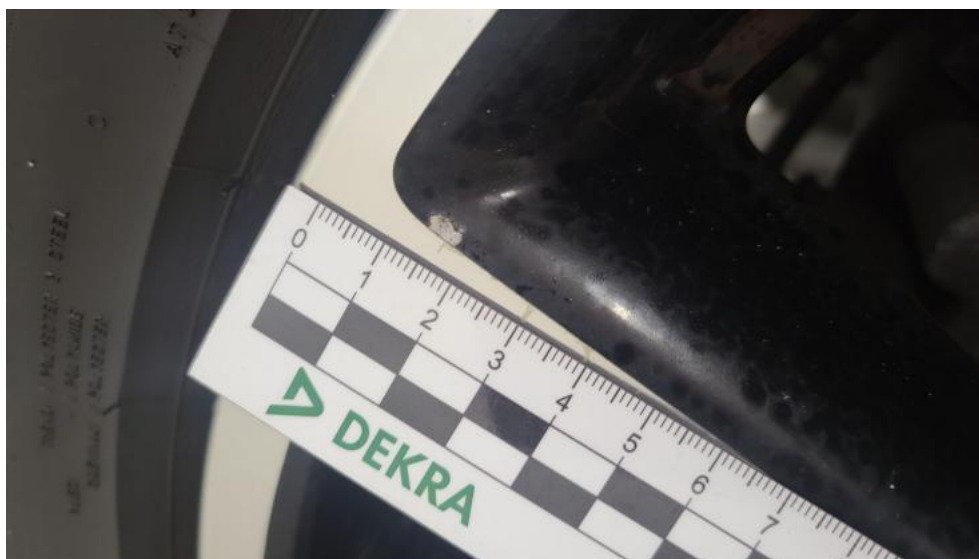
Fot. 79. Felga aluminiowa tylna P - Rysa/odprysk 1
