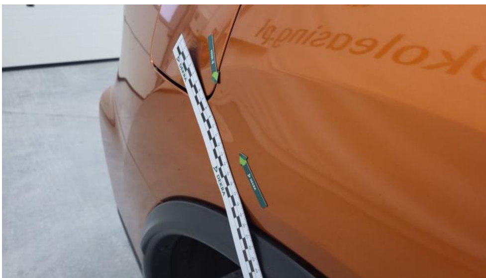
Fot. 77. Błotnik tylny P / Ściana boczna P - Wgniecenie/odkształcenie 1
