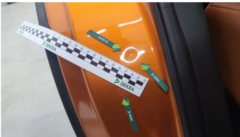
Fot. 78. Błotnik tylny P / Ściana boczna P - Wgniecenie/odkształcenie 2
