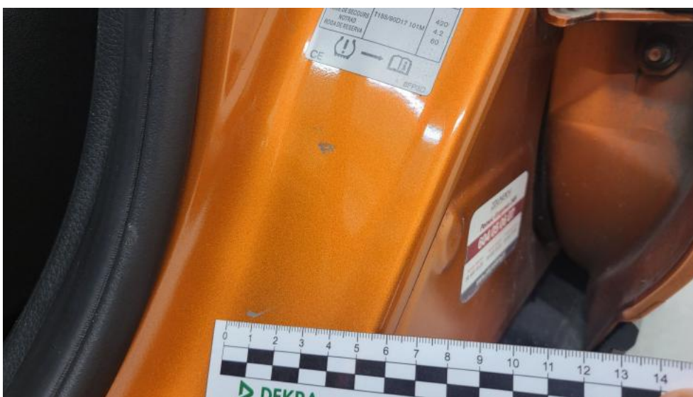
Fot. 110. Słupek środkowy L - Rysa/odprysk 1
