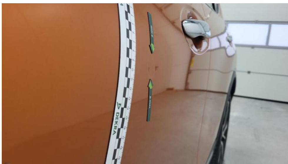
Fot. 102. Drzwi przed L - Wgniecenie/odkształcenie 2
