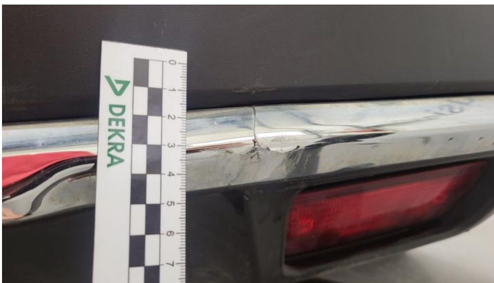
Fot. 83. Spojler zderzaka tylnego - Pęknięcie/rozerwanie 1
