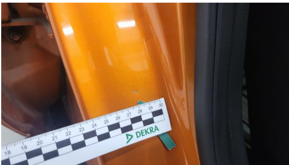
Fot. 72. Słupek środkowy P - Rysa/odprysk 1
