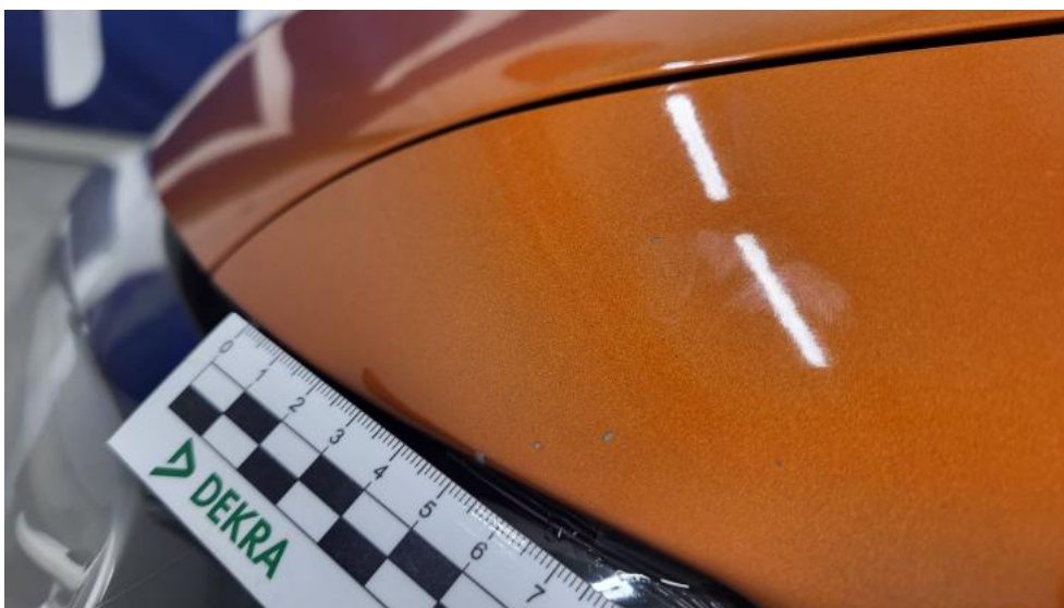
Fot. 113. Błotnik przedni L - Rysa/odprysk 1
