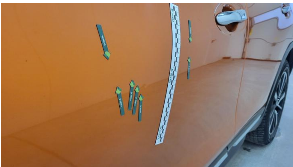
Fot. 100. Drzwi przed L() - Rysa/odprysk 3
