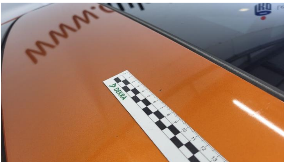
Fot. 92. Dach - Rysa/odprysk 1
