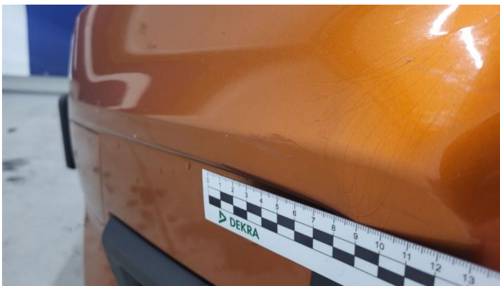
Fot. 51. Zderzak - Rysa/odprysk 2
