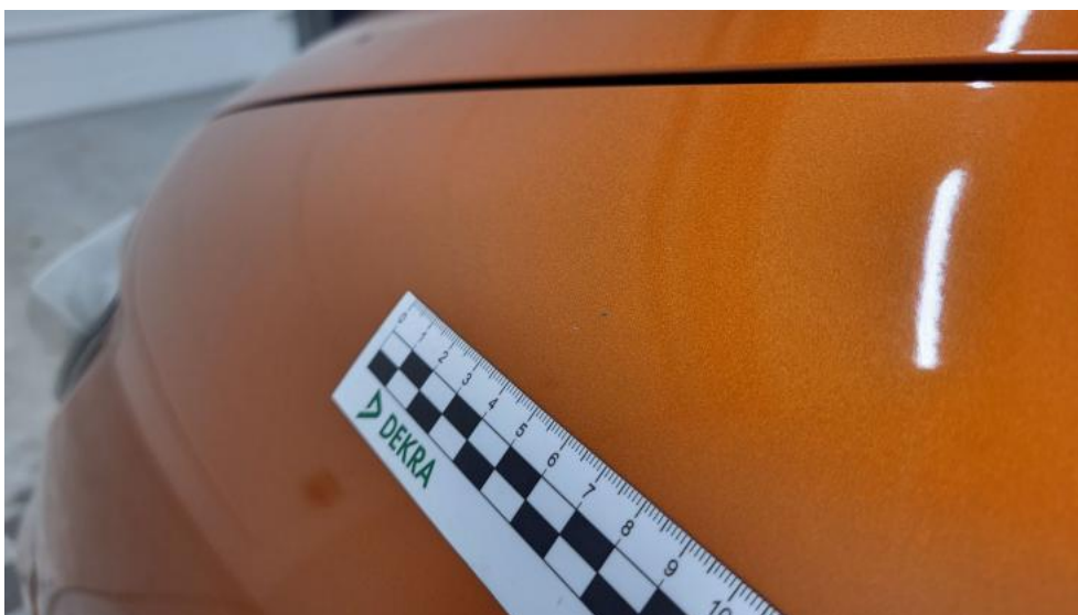
Fot. 114. Błotnik przedni L - Rysa/odprysk 2
