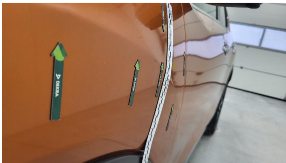
Fot. 115. Błotnik przedni L - Wgniecenie/odkształcenie 1
