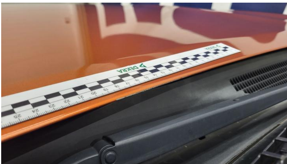
Fot. 45. Pokrywa komory silnika - Rysa/odprysk 2
