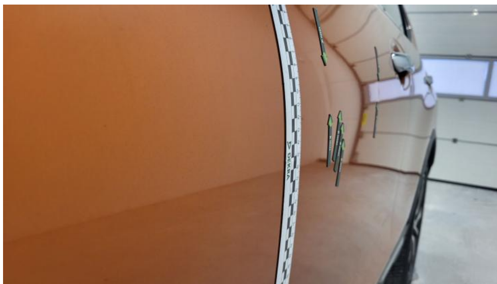
Fot. 101. Drzwi przed L - Wgniecenie/odkształcenie 1
