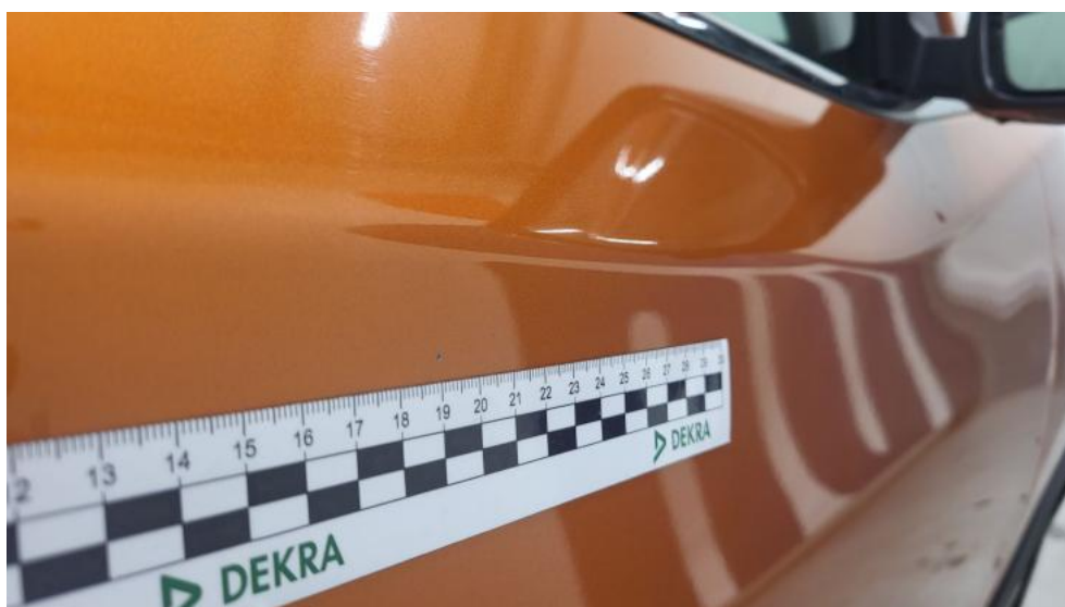
Fot. 58. Drzwi przednie P - Rysa/odprysk 1
