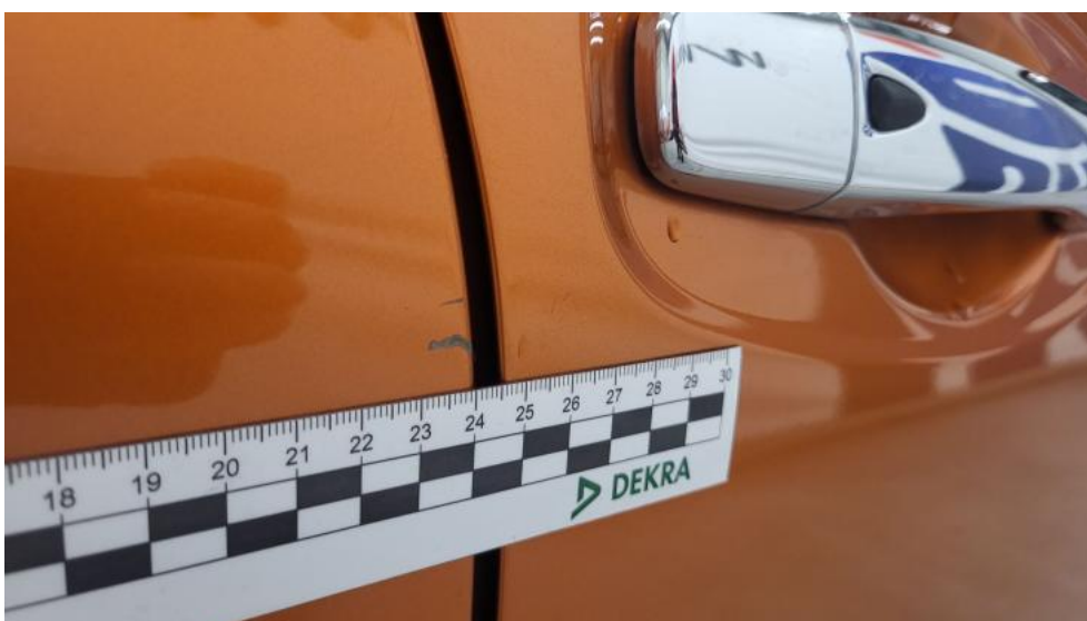
Fot. 64. Drzwi tylne P - Rysa/odprysk 1
