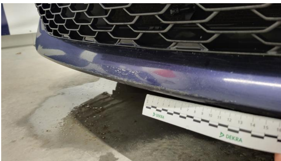
Fot. 40. Spoiler zderzaka przedniego - Rysa/odprysk 1
