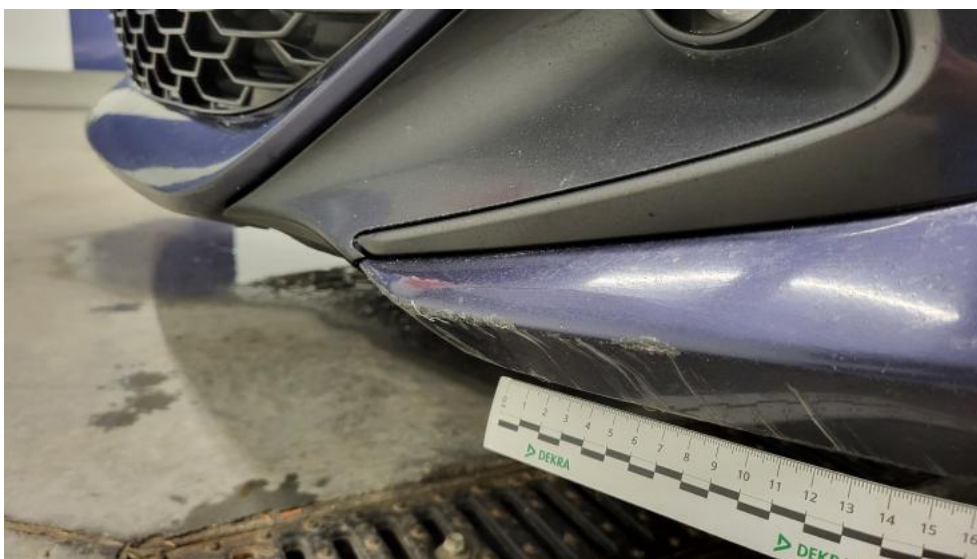
Fot. 43. Zderzak - Rysa/odprysk 1
