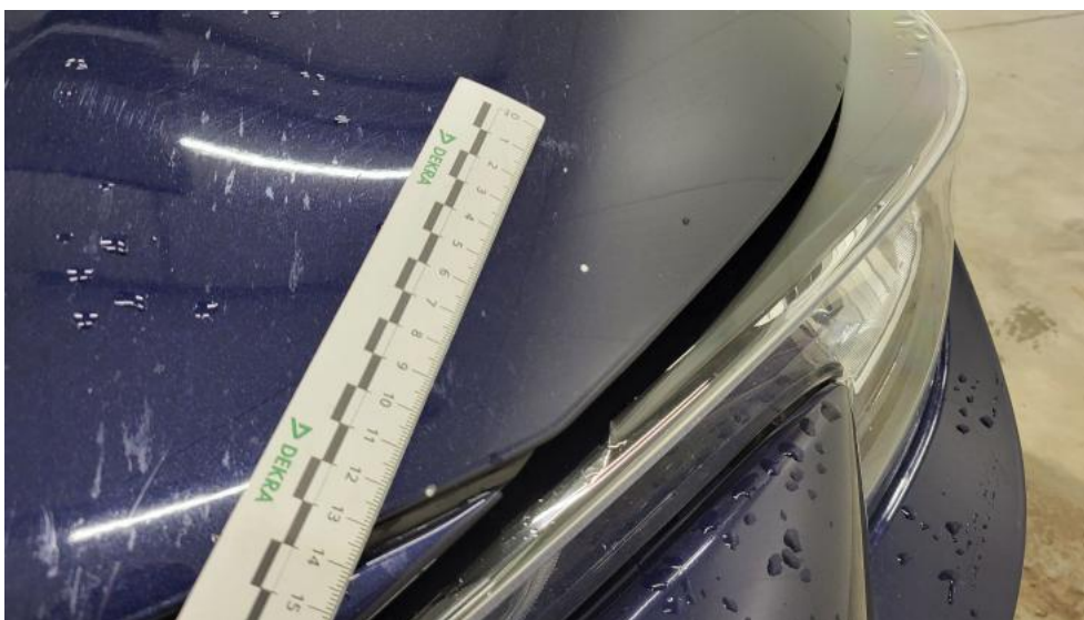
Fot. 39. Pokrywa komory silnika - Rysa/odprysk 1
