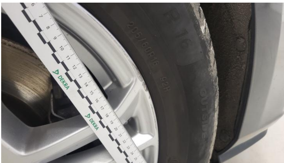
Fot. 41. Felga aluminiowa przednia P - Rysa/odprysk 1
