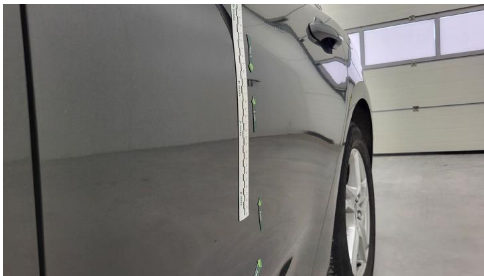
Fot. 55. Drzwi tylne L - Wgniecenie/odkształcenie 1
