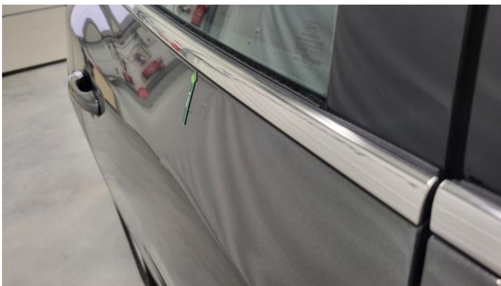
Fot. 45. Listwa drzwi tylnych P - Wgniecenie/odkształcenie 1
