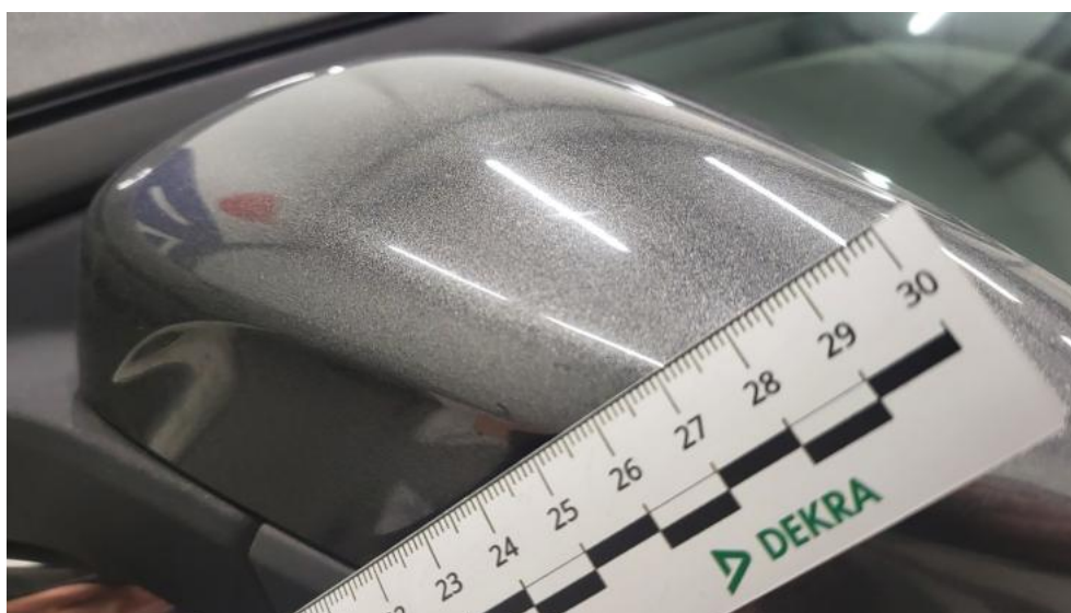
Fot. 56. Lusterko zew L - Rysa/odprysk 1
