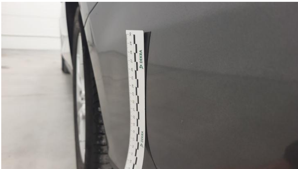
Fot. 53. Zderzak tylny - Wgniecenie/odkształcenie 1
