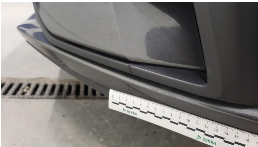
Fot. 40. Zderzak - Rysa/odprysk 1
