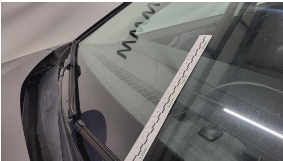
Fot. 39. Szyba czołowa - Pęknięcie/rozerwanie 1
