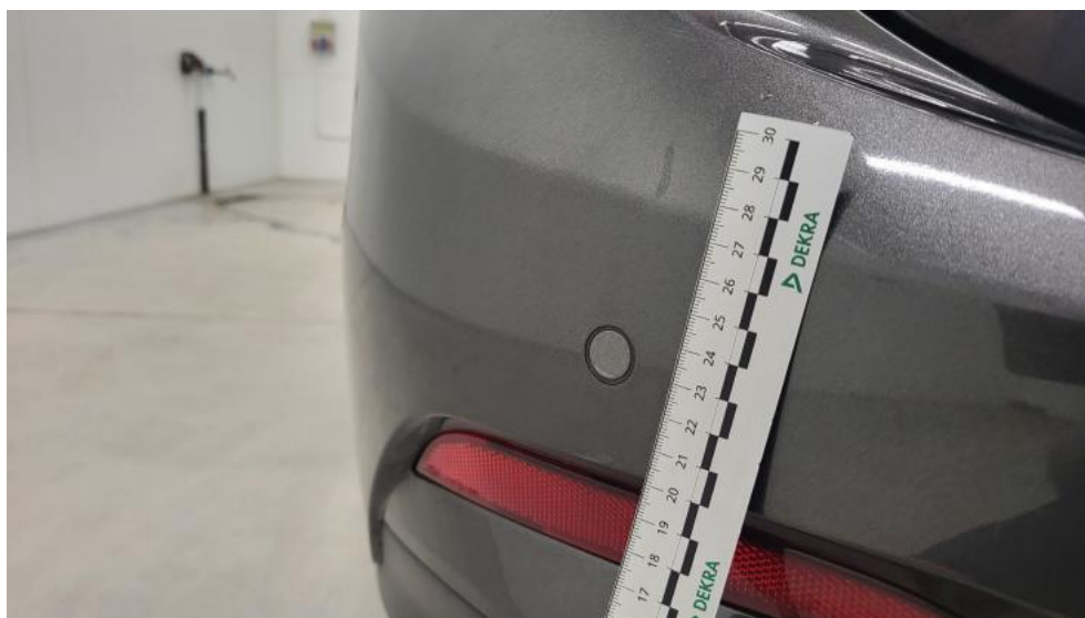
Fot. 52. Zderzak tylny - Rysa/odprysk 1
