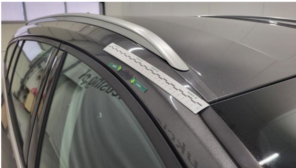
Fot. 47. Stupek przedni P - Wgniecenie/odkształcenie 1
