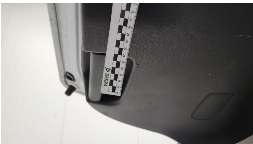
Photo 86. Wykładzina pokrywy tylnej - Rysa/odprysk 1
