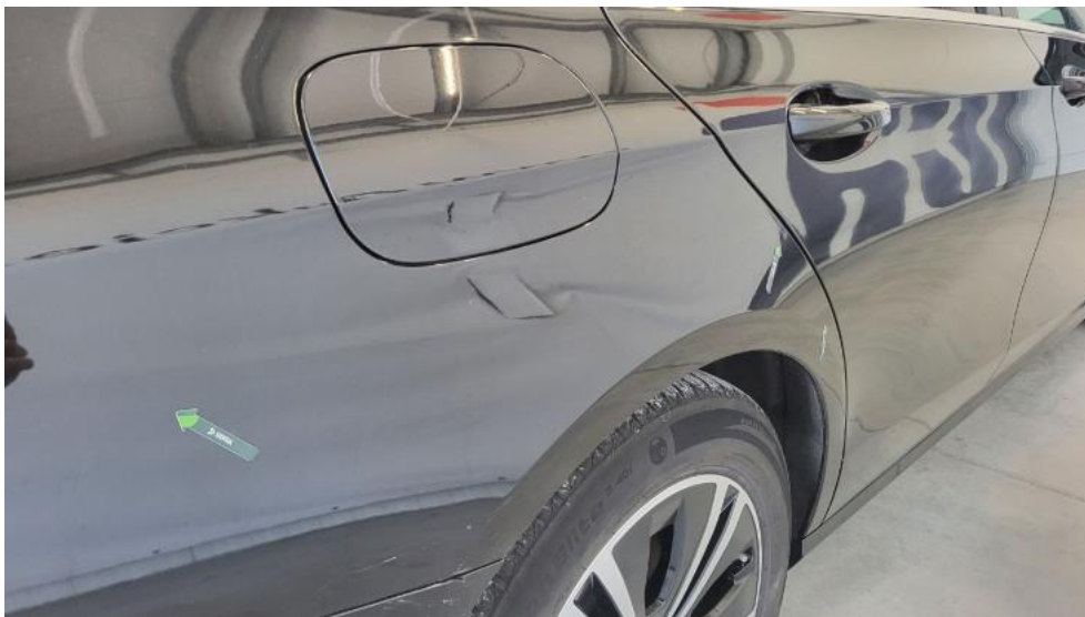
Fot. 59. Błotnik tylny P / Ściana boczna P() - Wgniecenie/odkształcenie 3
