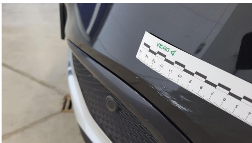
Fot. 44. Zderzak - Rysa/odprysk 1
