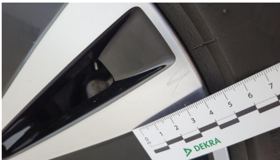
Fot. 73. Felga Aluminiowa przednia L - Rysa/odprysk 1
