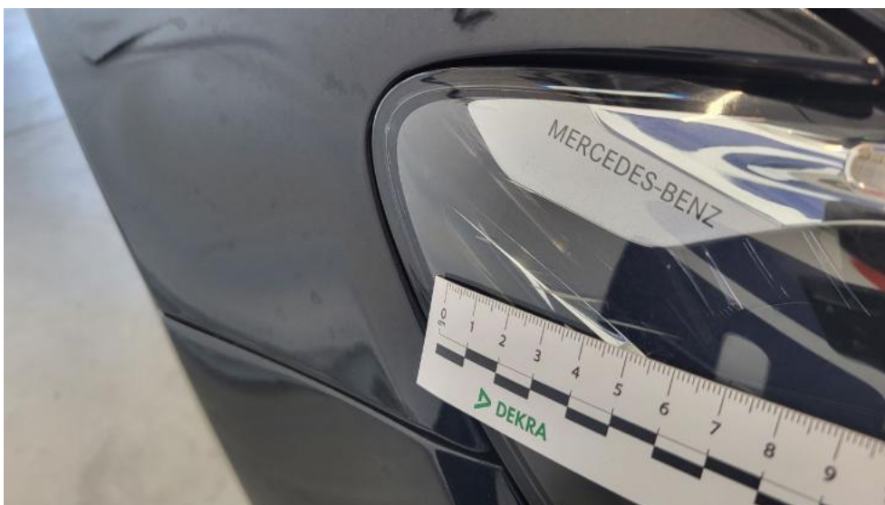
Fot. 48. Reflektor P - Rysa/odprysk 1
