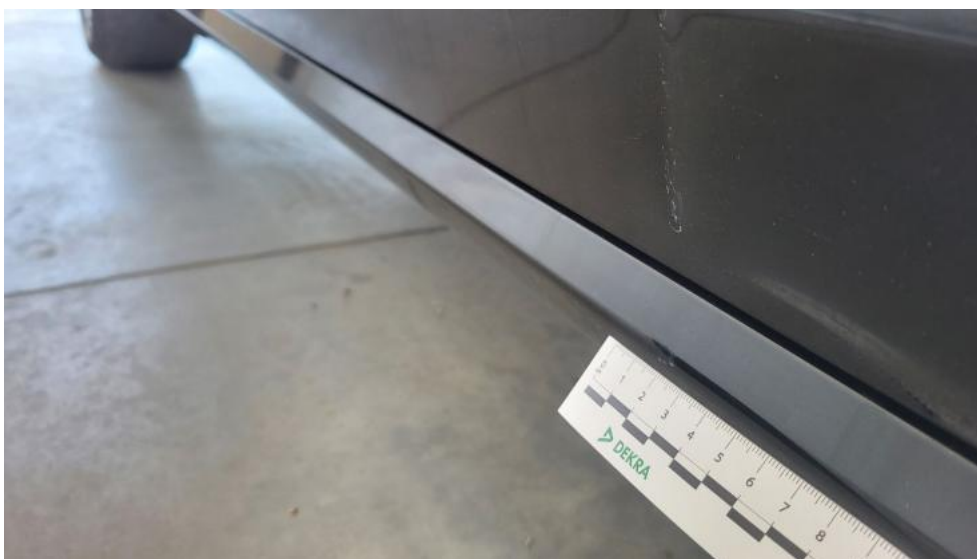
Fot. 55. Próg P - Wgniecenie/odkształcenie 2
