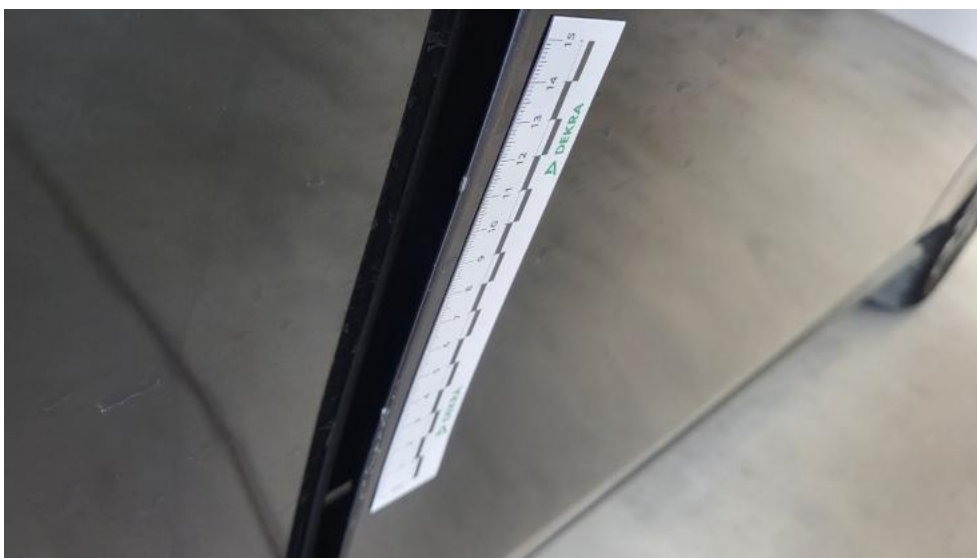
Fot. 50. Drzwi przednie P - Rysa/odprysk 2
