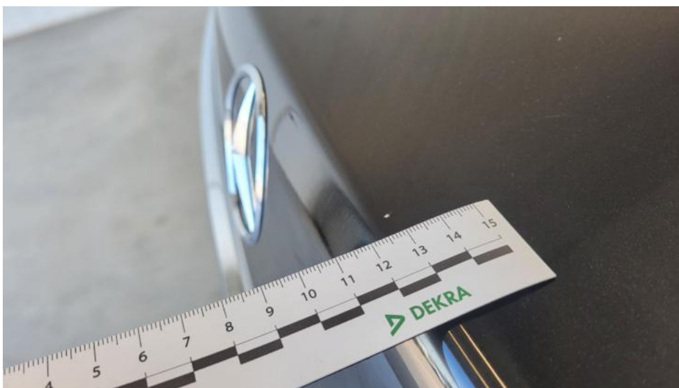
Fot. 60. Pokrywy bagażnika - Rysa/odprysk 1
