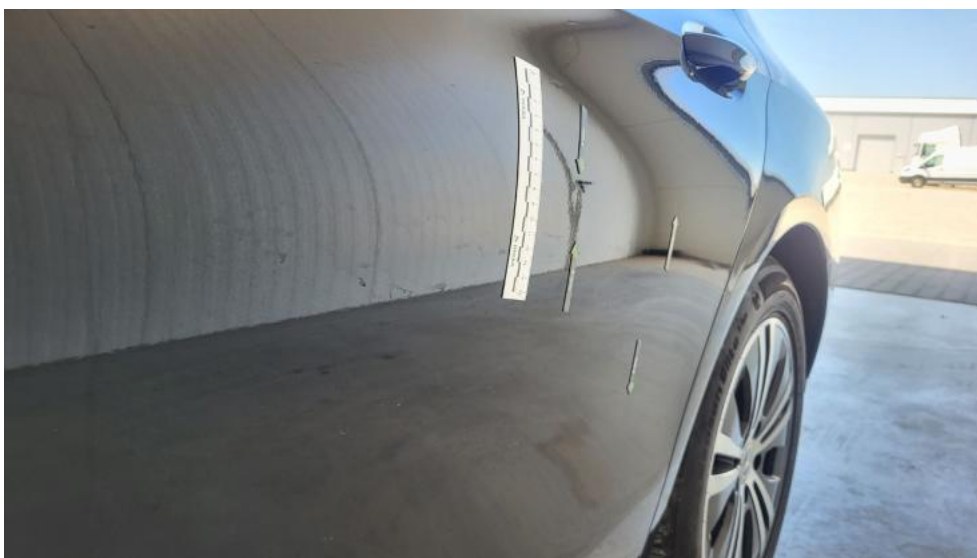
Fot. 72. Drzwi tylne L - Wgniecenie/odkształcenie 1
