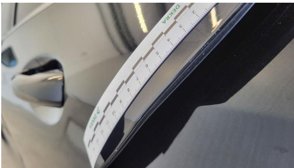
Fot. 71. Drzwi tylne L - Rysa/odprysk 1
