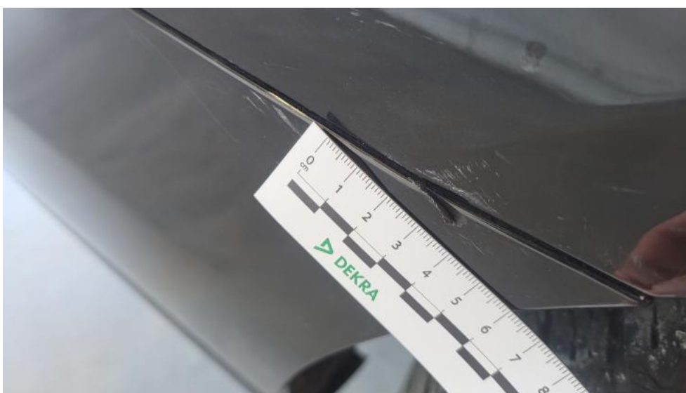
Fot. 64. Zderzak tylny - Pęknięcie/rozerwanie 1
