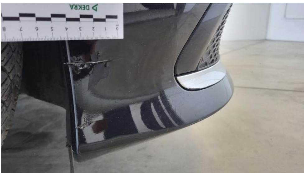
Fot. 46. Zderzak - Pęknięcie/rozerwanie 1
