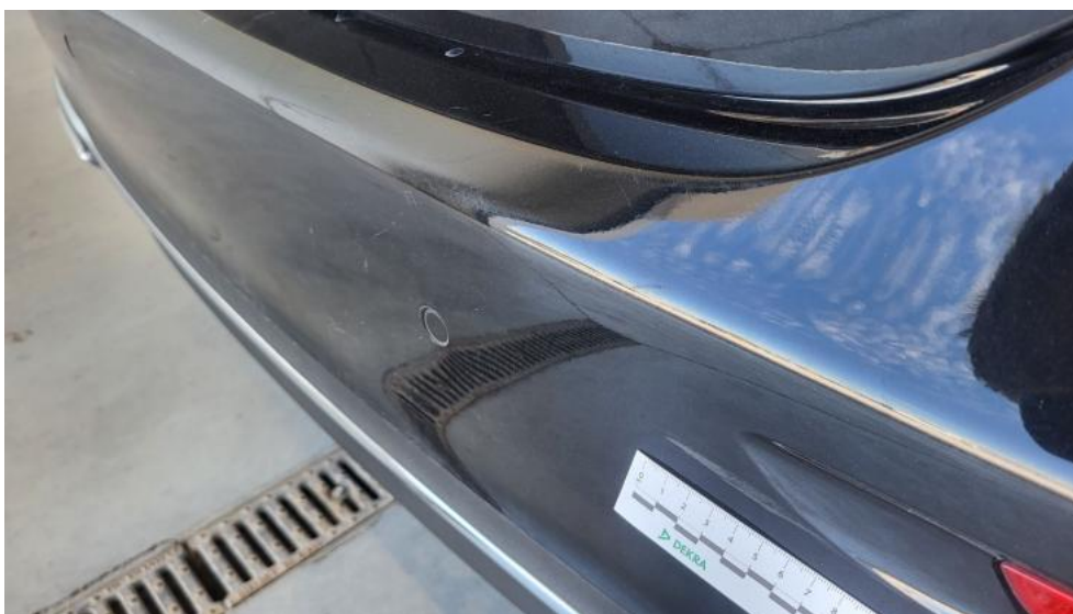
Fot. 63. Zderzak tylny - Rysa/odprysk 2
