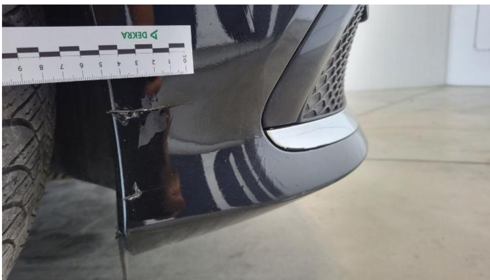
Fot. 45. Zderzak - Wgniecenie/odkształcenie 1
