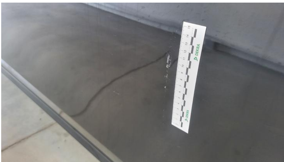
Fot. 49. Drzwi przednie P - Rysa/odprysk 1
