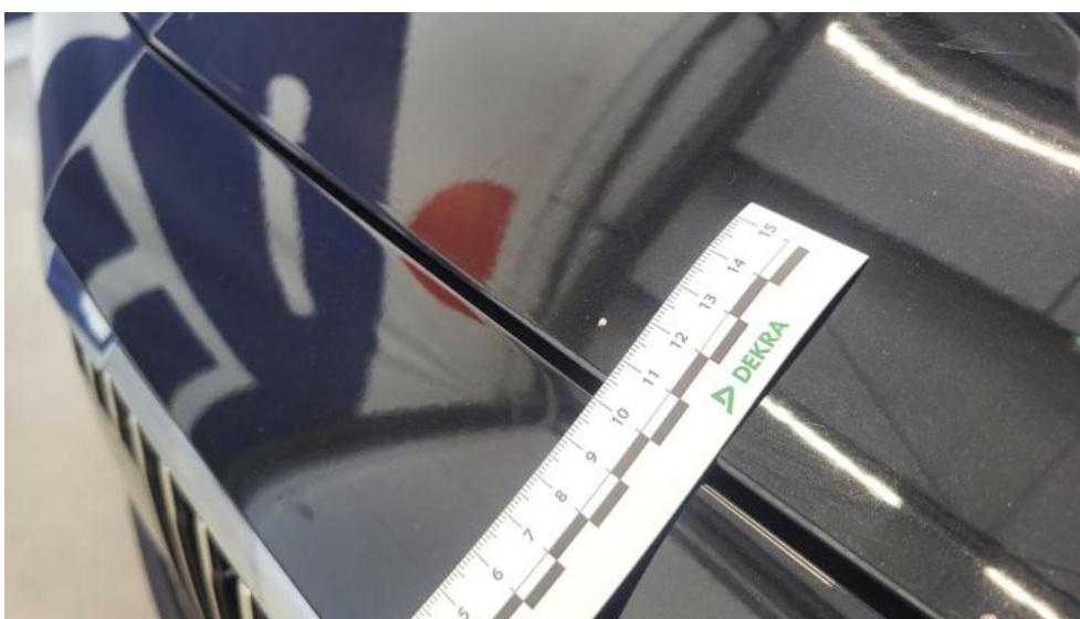
Fot. 42. Pokrywa komory silnika - Rysa/odprysk 1
