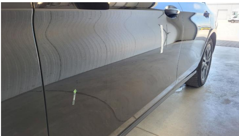
Fot. 70. Drzwi przed L - Wgniecenie/odkształcenie 1
