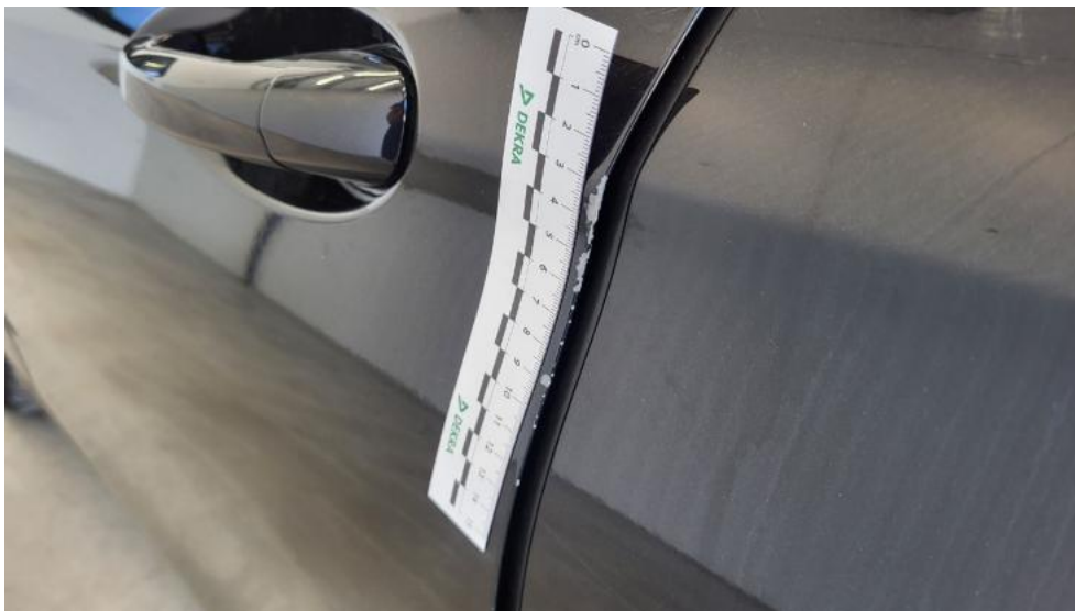
Fot. 69. Drzwi przed L - Rysa/odprysk 1
