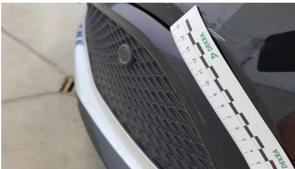
Fot. 41. Kratka/zaślepka halogenu L - Rysa/odprysk 1
