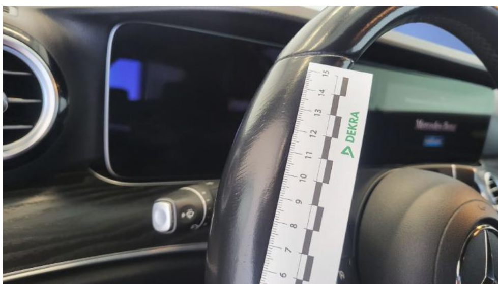
Fot. 74. Koło kierownicy - Rysa/odprysk 1
