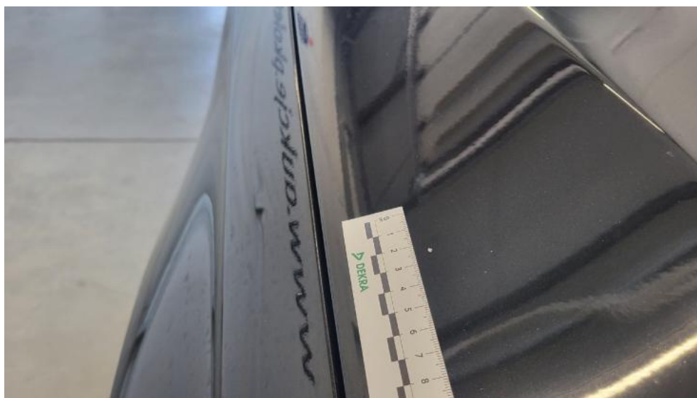
Fot. 43. Pokrywa komory silnika - Rysa/odprysk 2
