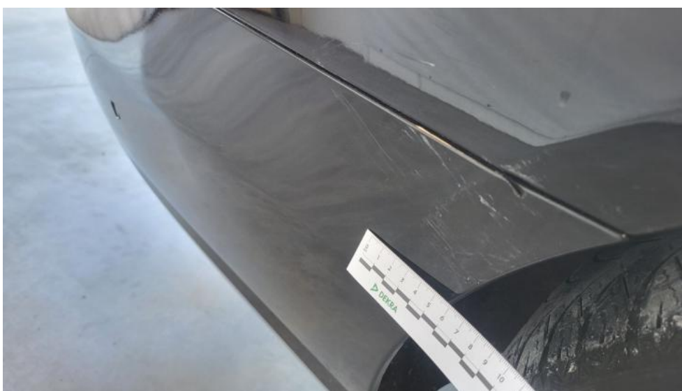
Fot. 62. Zderzak tylny - Rysa/odprysk 1
