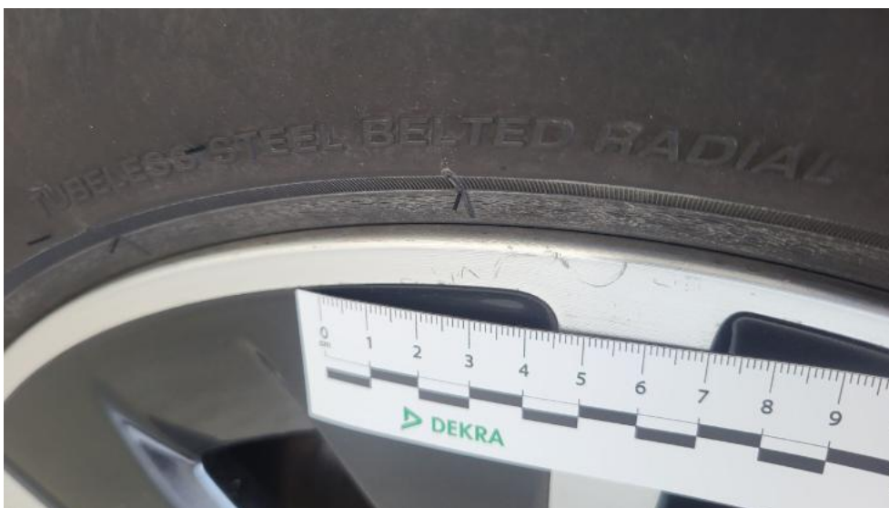
Fot. 68. Felga aluminiowa tylna L - Rysa/odprysk 1
