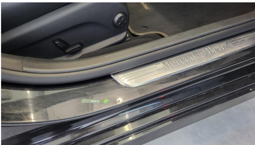
Fot. 54. Próg P - Wgniecenie/odkształcenie 1
