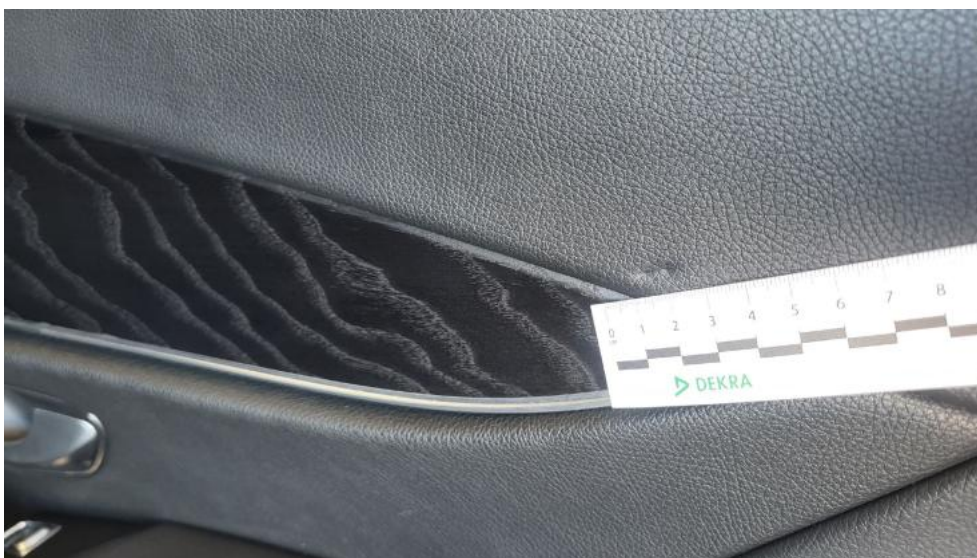
Fot. 82. Tapicerka drzwi tylnych P - Wgniecenie/odkształcenie 1
