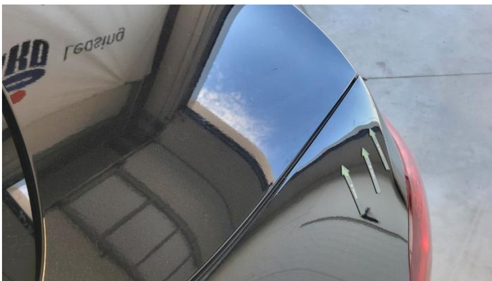
Fot. 67. Błotnik tylny L / Ściana boczna L - Wgniecenie/odkształcenie 2
