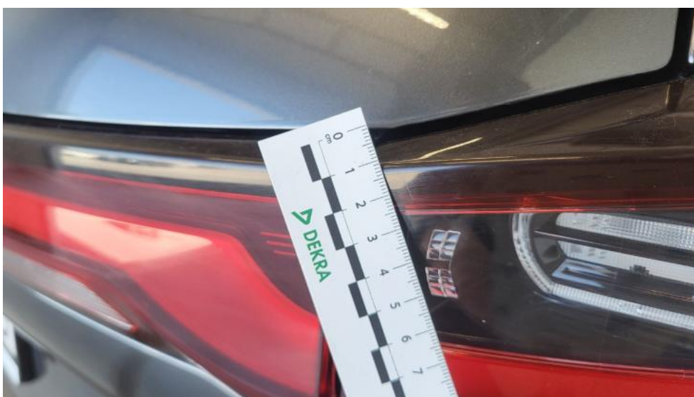
Fot. 48. Lampa tylna zew P - Rysa/odprysk 1
