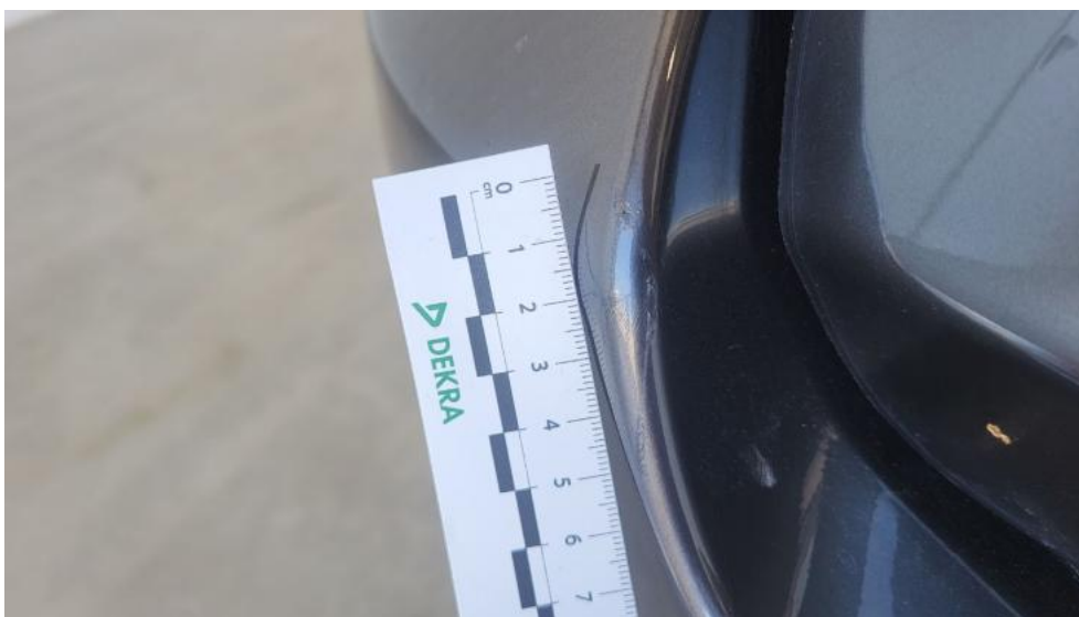
Fot. 51. Zderzak tylny - Rysa/odprysk 2
