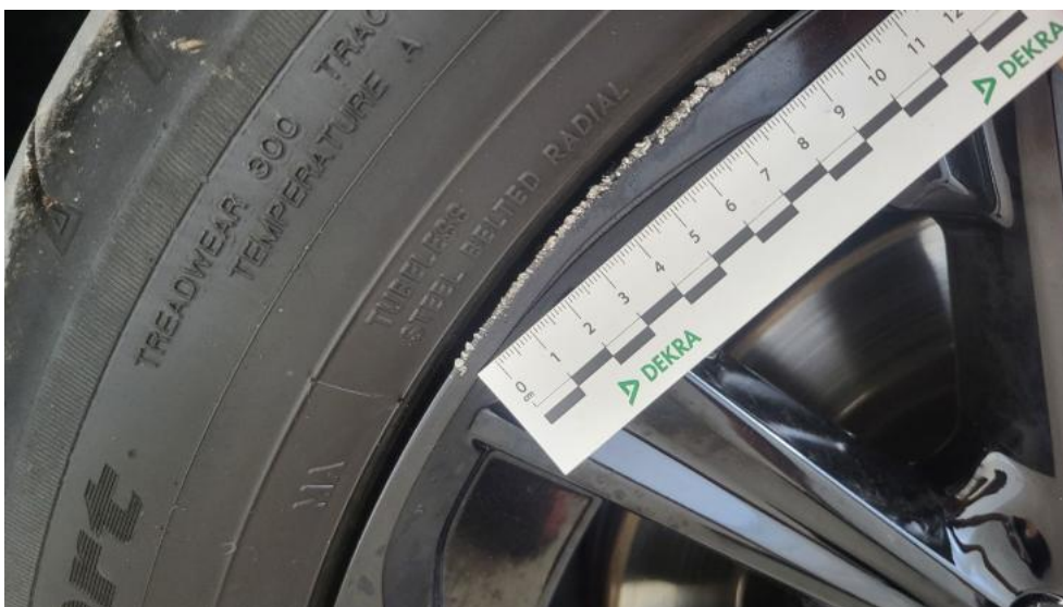
Fot. 56. Felga Aluminiowa przednia L - Rysa/odprysk 1
