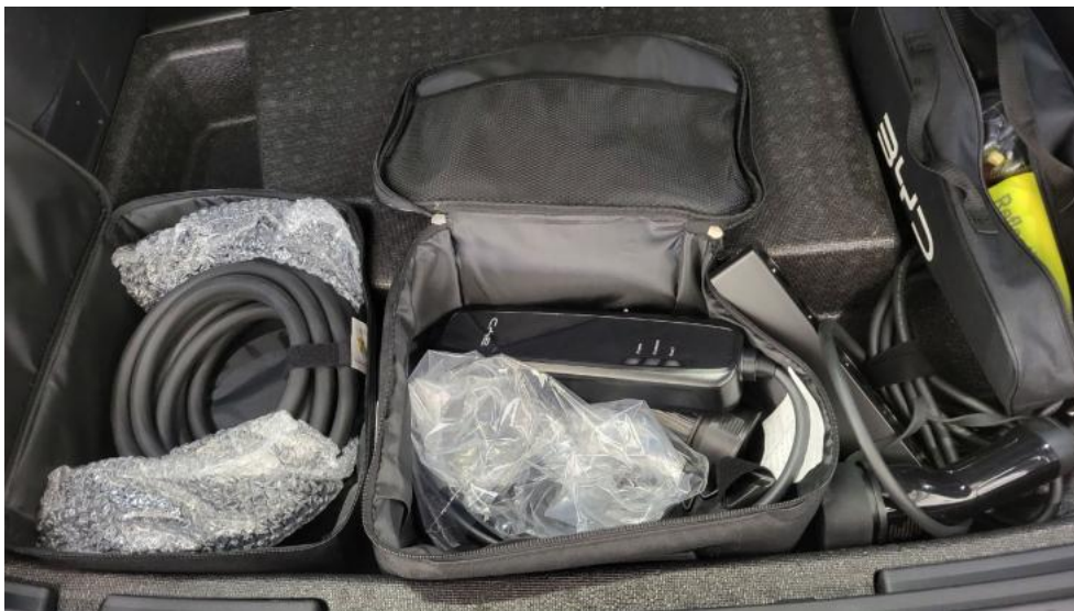
Fot. 35. Przewód ładowania baterii trakcyjnej
