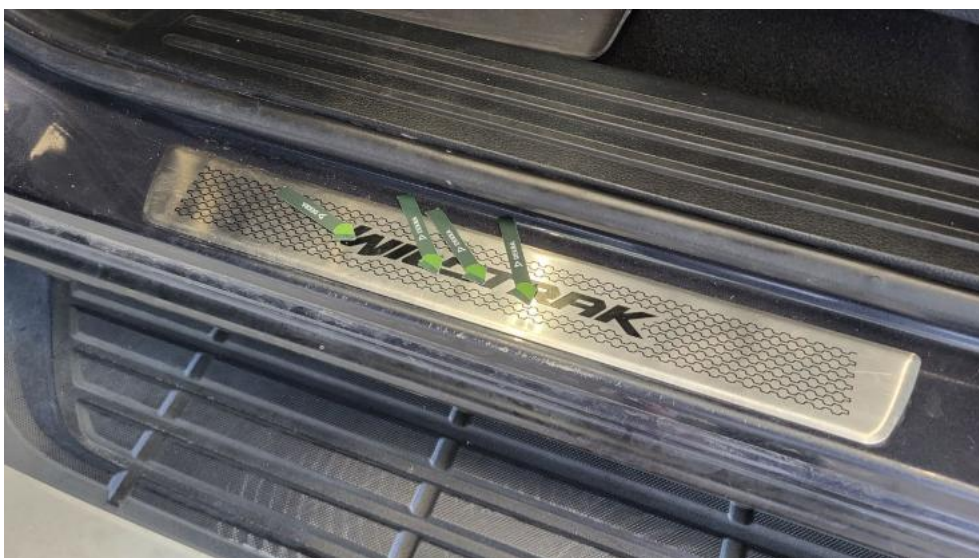
Photo 62. Listwy progowe lew. - Wgniecenie/odkształcenie 1
