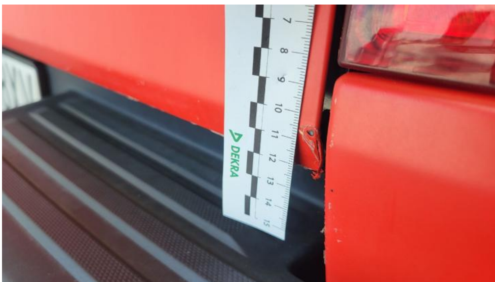
Photo 50. Pokrywy bagażnika - Rysa/odprysk 1
