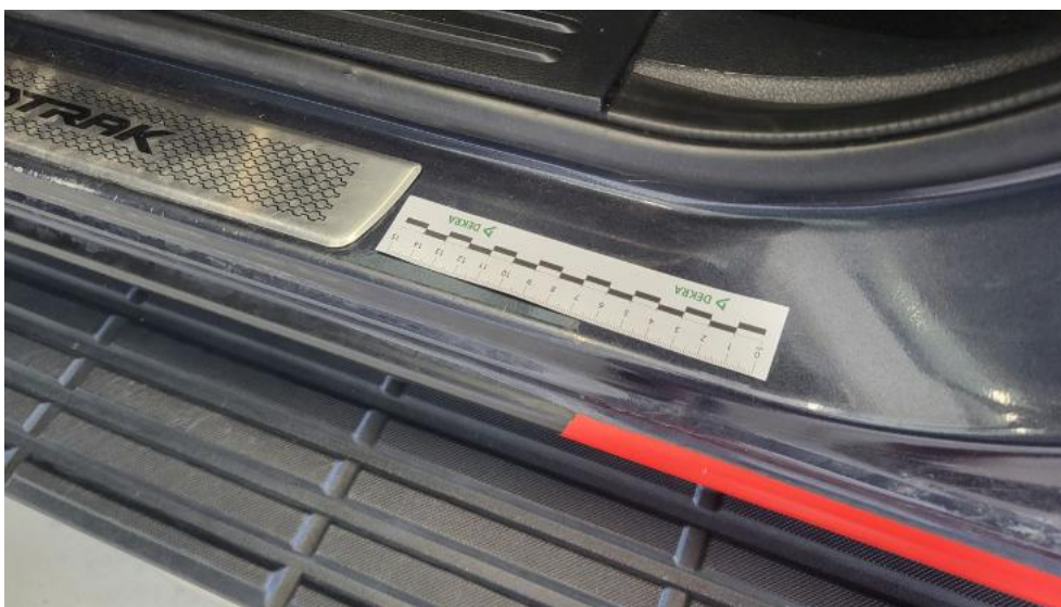
Photo 55. Próg L - Rysa/odprysk 1
