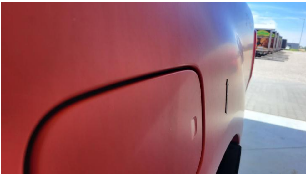
Photo 53. Błotnik tylny L / Ściana boczna L - Wgniecenie/odkształcenie 1
