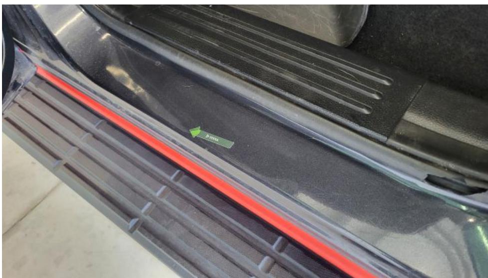
Photo 56. Próg L - Wgniecenie/odkształcenie 1
