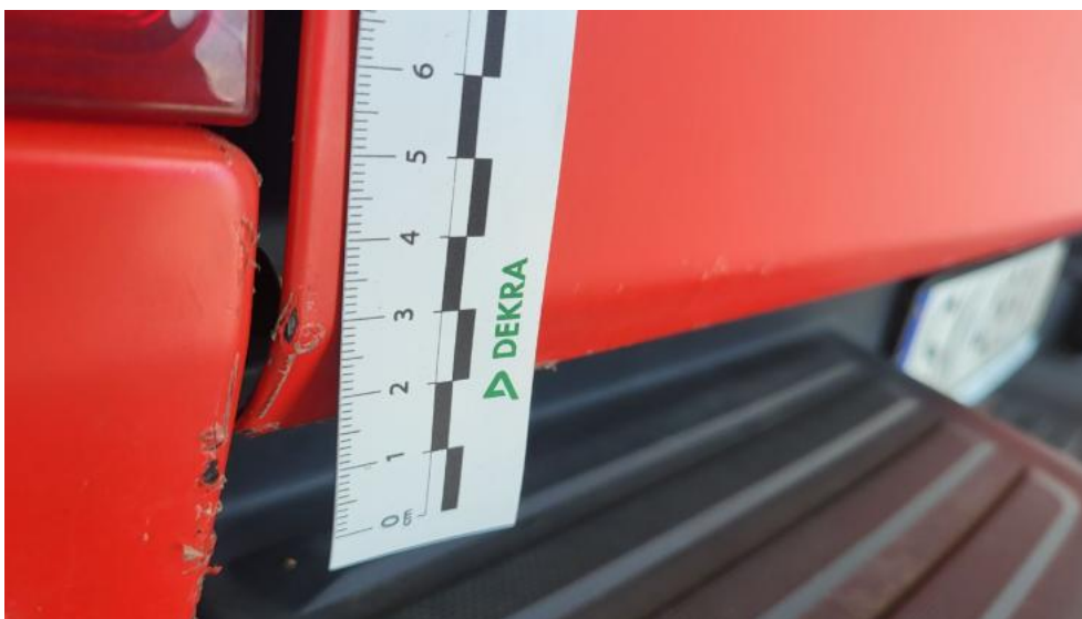
Photo 51. Pokrywy bagażnika - Rysa/odprysk 2
