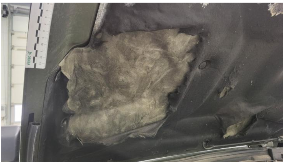
Photo 43. Wykładzina pokrywy komory silnika - Pęknięcie/rozerwanie 1
