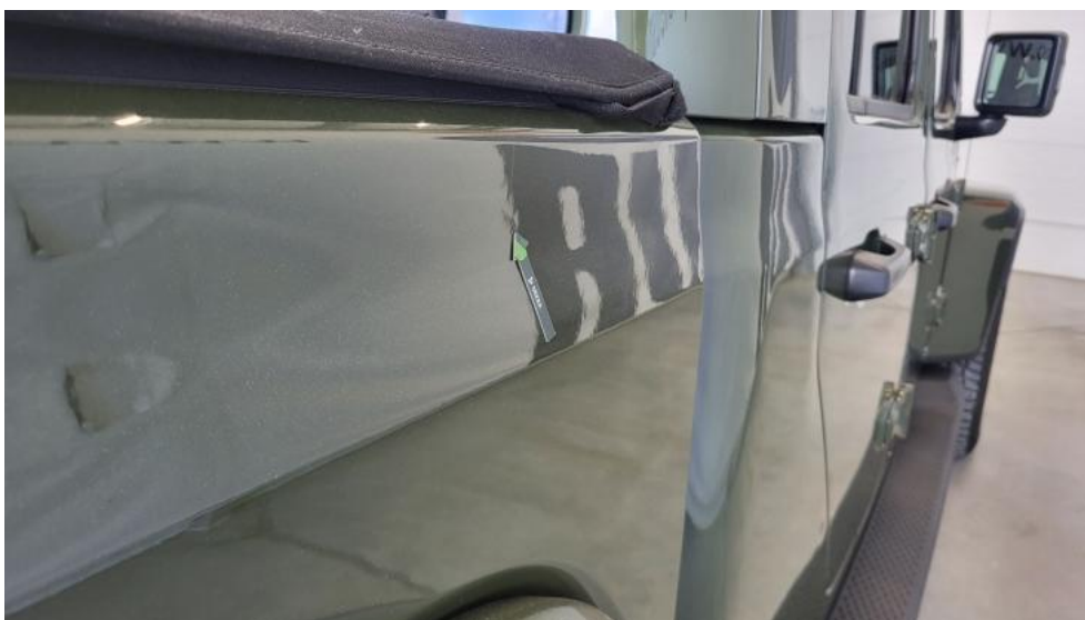
Photo 54. Błotnik tylny P / Ściana boczna P - Wgniecenie/odkształcenie 2
