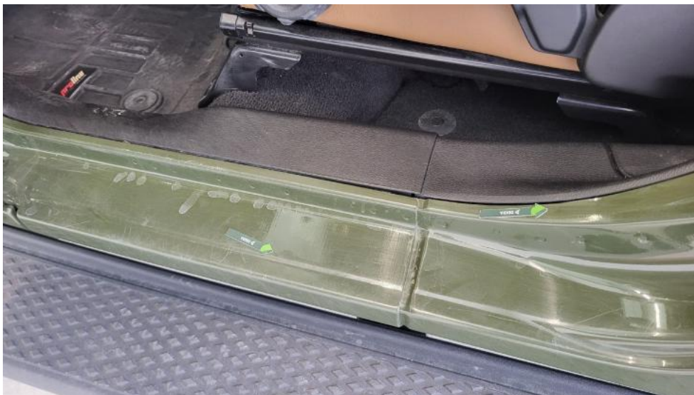
Photo 67. Próg L - Wgniecenie/odkształcenie 1
