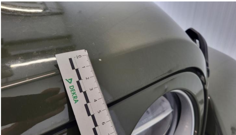
Photo 41. Pokrywa komory silnika - Rysa/odprysk 1
