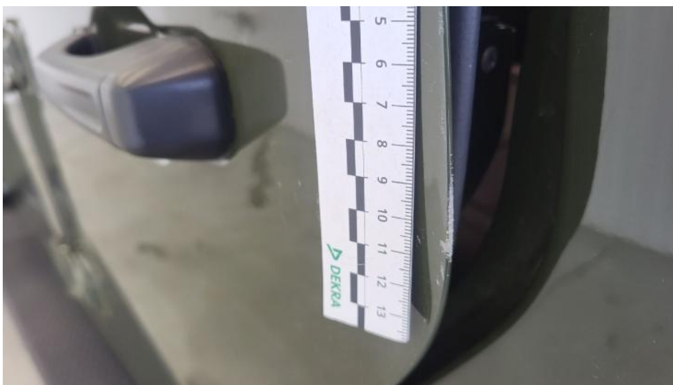
Photo 63. Drzwi tylne L - Rysa/odprysk 1
