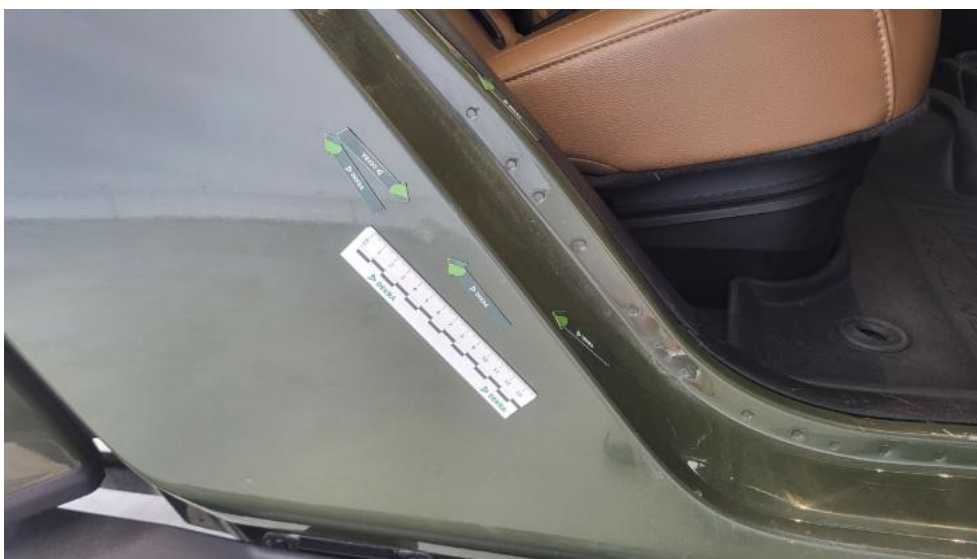
Photo 53. Błotnik tylny P / Ściana boczna P - Wgniecenie/odkształcenie 1
