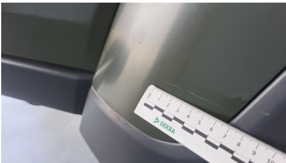
Photo 52. Błotnik tylny P / Ściana boczna P - Rysa/odprysk 1
