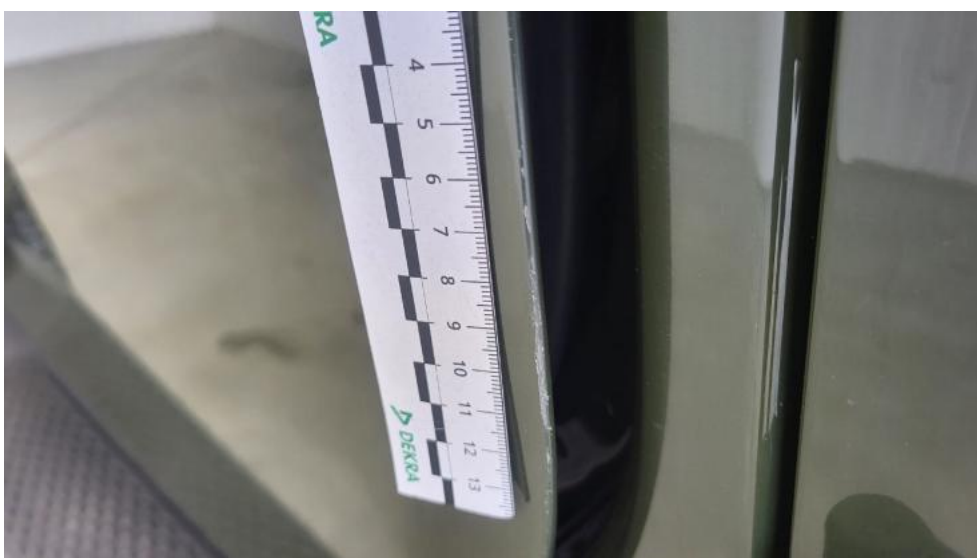
Photo 62. Drzwi przed L - Rysa/odprysk 1
