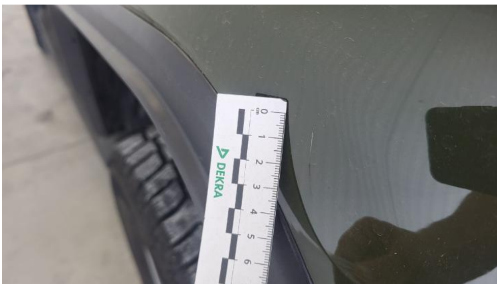
Photo 59. Błotnik tylny L / Ściana boczna L - Rysa/odprysk 1
