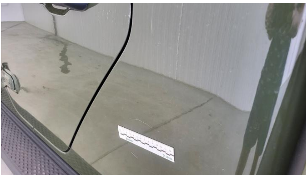
Photo 60. Błotnik tylny L / Ściana boczna L - Rysa/odprysk 2
