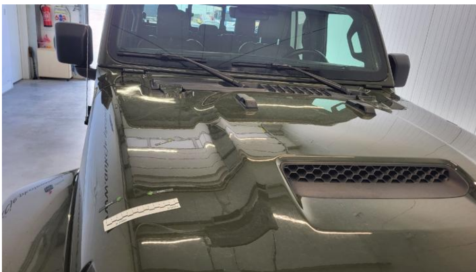
Photo 42. Pokrywa komory silnika - Wgniecenie/odkształcenie 1
