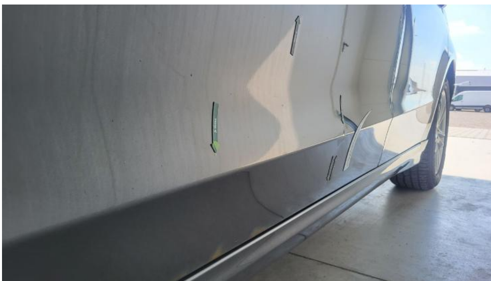
Fot. 91. Drzwi przed L - Wgniecenie/odkształcenie 2
