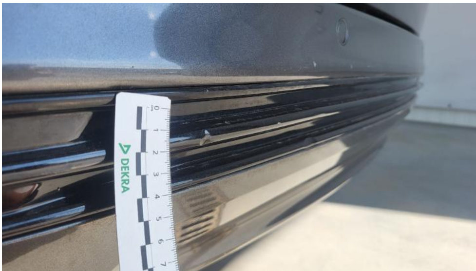
Fot. 73. Listwa śr zderzaka tylnego - Wgniecenie/odkształcenie 2
