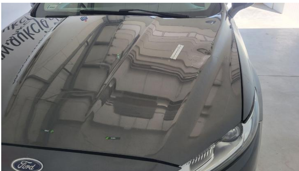
Fot. 39. Pokrywa komory silnika - Wgniecenie/odkształcenie 1
