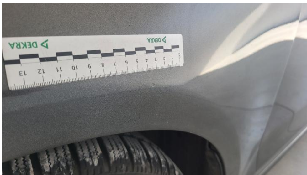
Fot. 99. Błotnik przedni L - Rysa/odprysk 1
