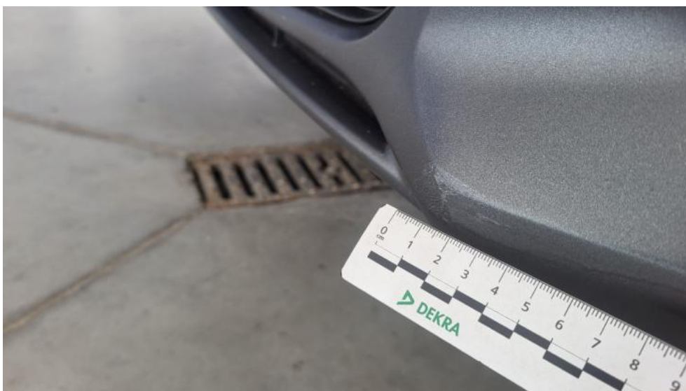
Fot. 45. Zderzak - Rysa/odprysk 1
