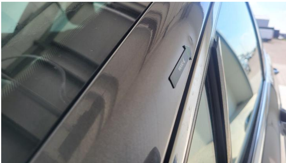
Fot. 97. Słupek przedni L - Wgniecenie/odkształcenie 1
