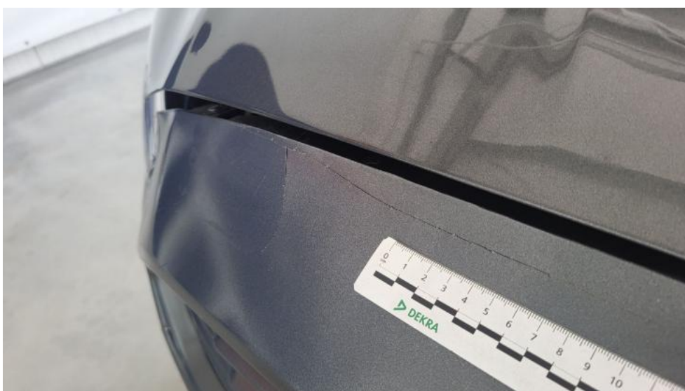
Fot. 50. Zderzak - Pęknięcie/rozerwanie 2
