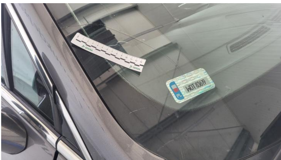
Fot. 44. Szyba czołowa - Pęknięcie/rozerwanie 2
