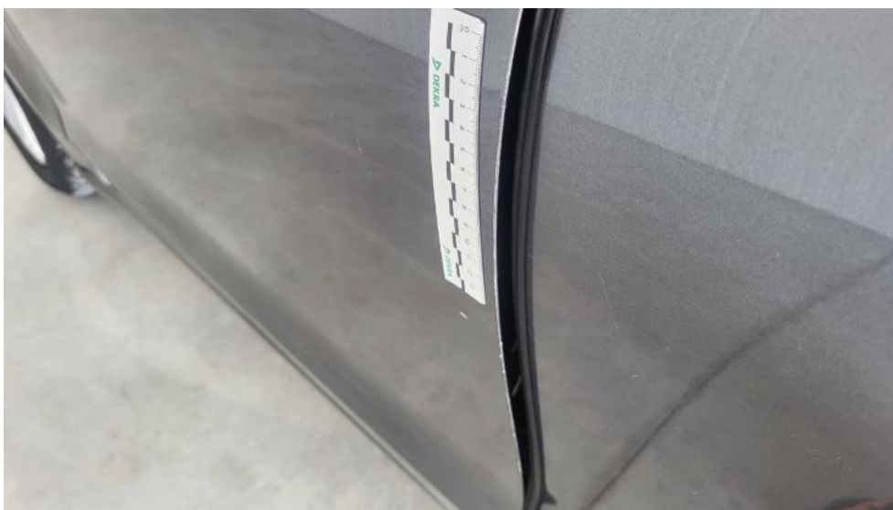
Fot. 89. Drzwi przed L - Rysa/odprysk 1
