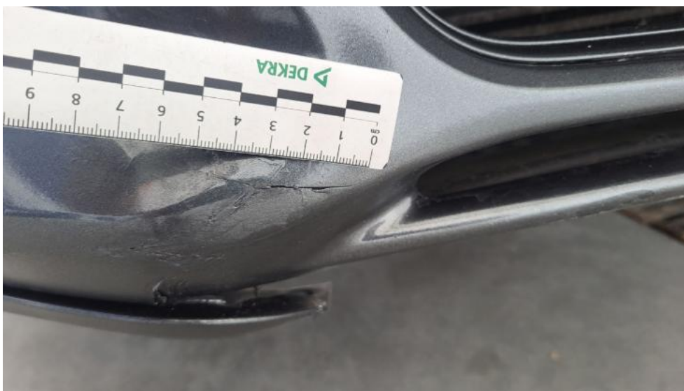
Fot. 51. Zderzak() - Pęknięcie/rozerwanie 3
