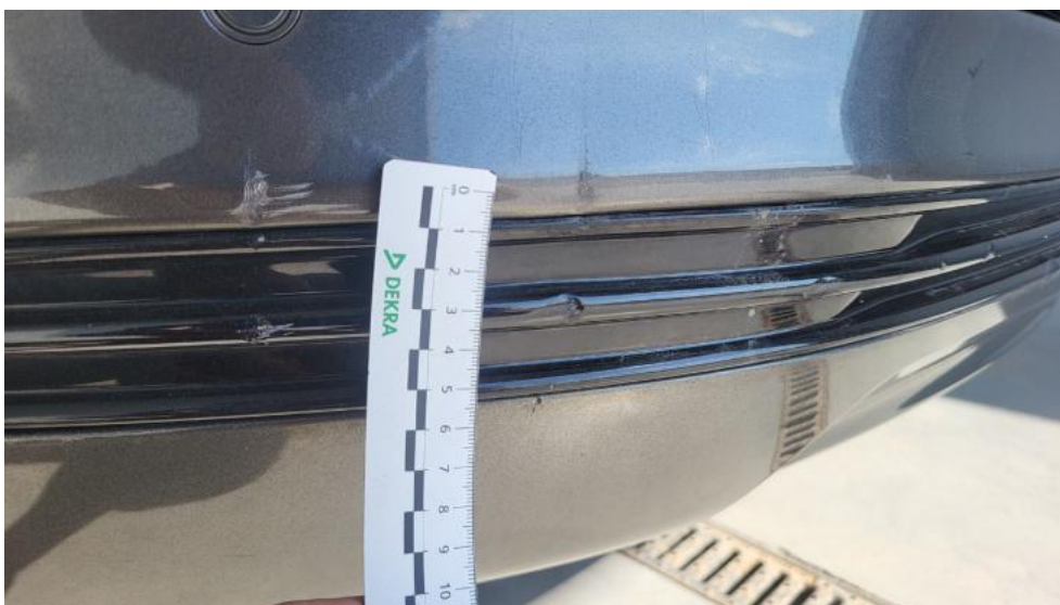
Fot. 72. Listwa śr zderzaka tylnego - Wgniecenie/odkształcenie 1
