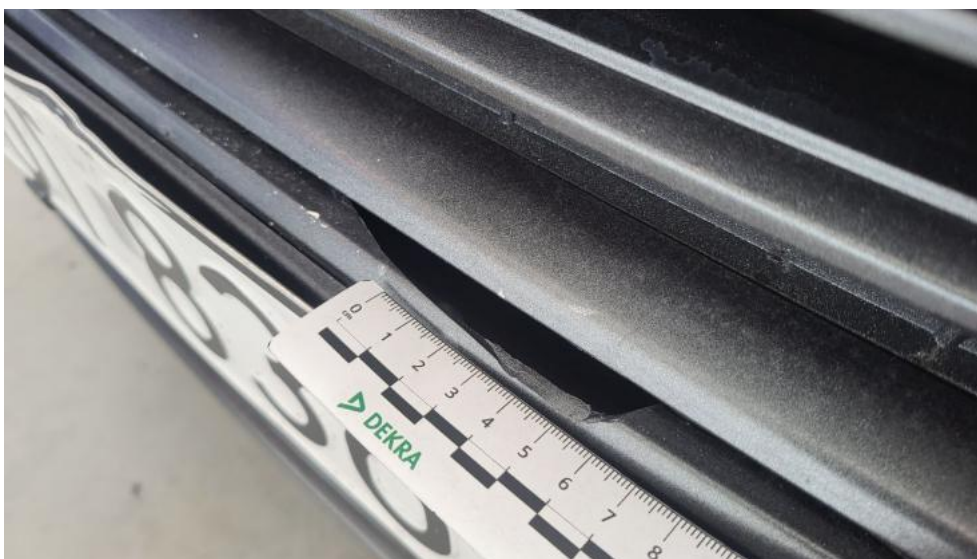
Fot. 49. Zderzak - Pęknięcie/rozerwanie 1
