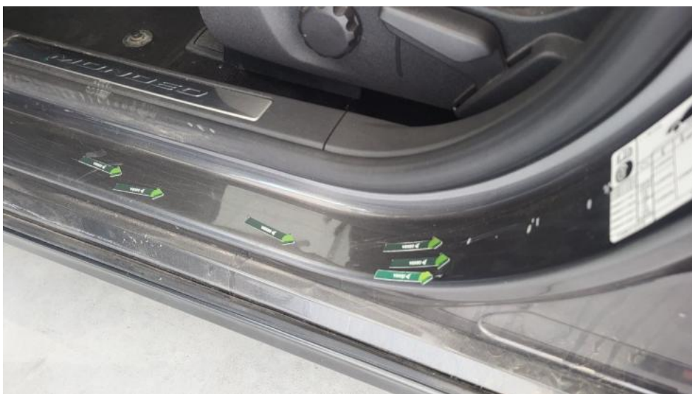
Fot. 96. Próg L - Wgniecenie/odkształcenie 1
