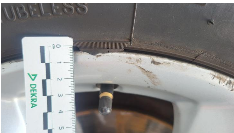
Fot. 88. Opona tylna L - Pęknięcie/rozerwanie 1
