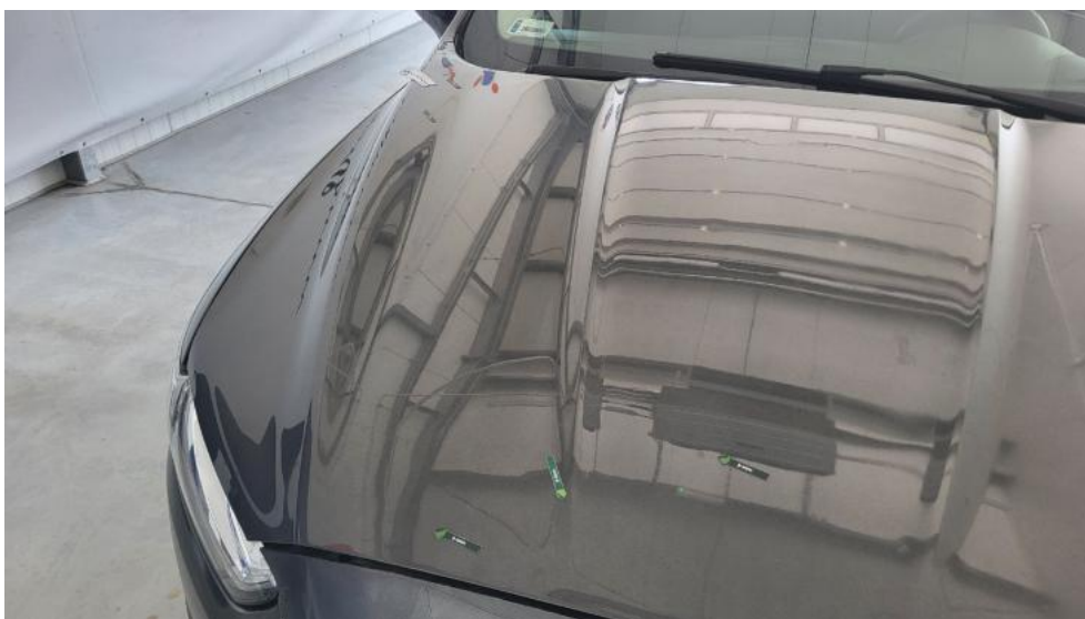
Fot. 40. Pokrywa komory silnika - Wgniecenie/odkształcenie 2
