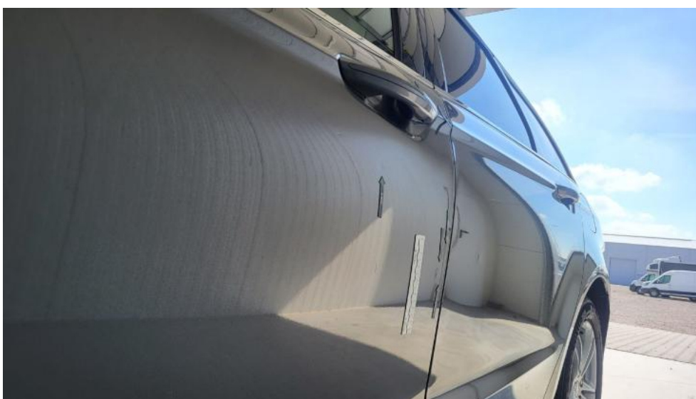
Fot. 90. Drzwi przed L - Wgniecenie/odkształcenie 1
