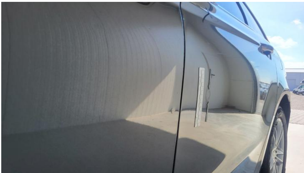
Fot. 93. Drzwi tylne L - Wgniecenie/odkształcenie 1
