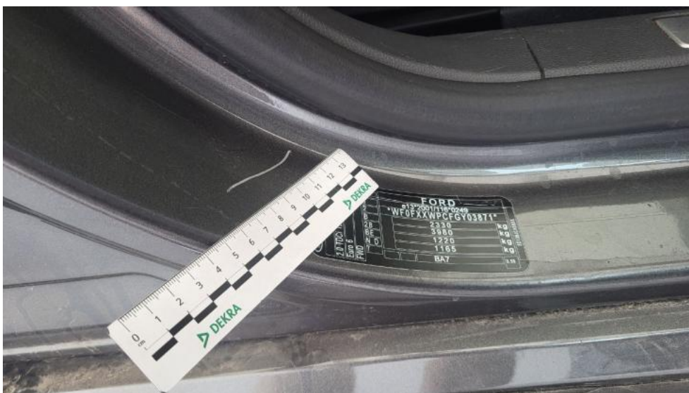
Fot. 66. Próg P - Rysa/odprysk 1
