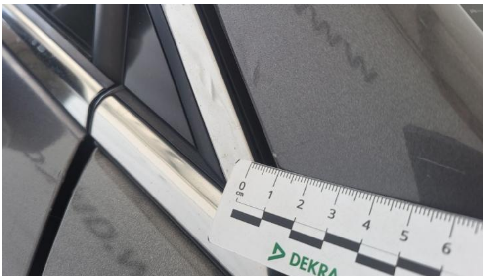
Fot. 67. Stupek przedni P - Rysa/odprysk 1
