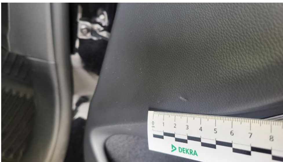
Photo 65. Tapicerka drzwi przednich P - Wgniecenie/odkształcenie 1
