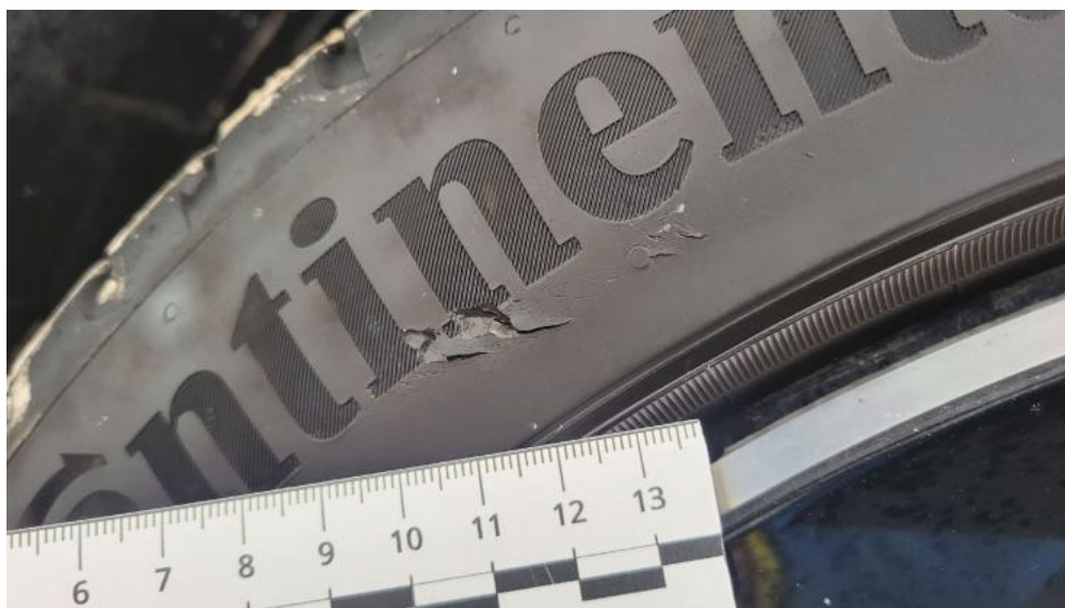
Photo 63. Opona przednia L - Pęknięcie/rozerwanie 1
