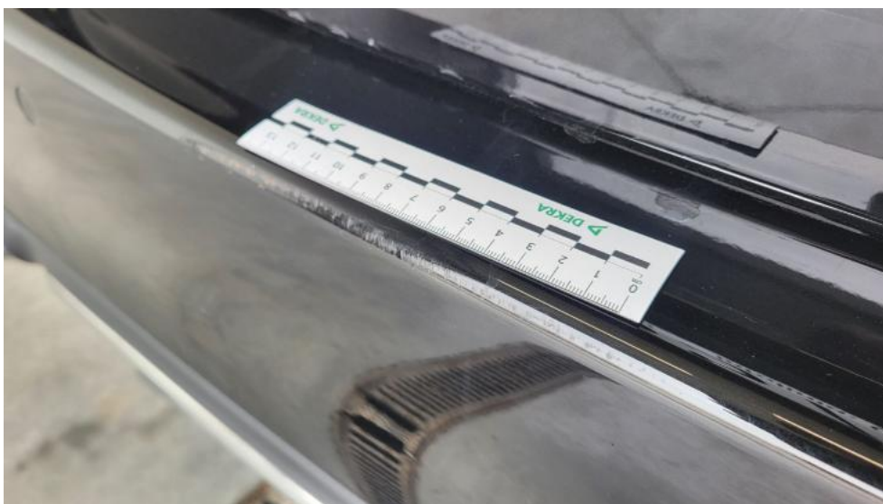
Photo 58. Zderzak tylny - Rysa/odprysk 2
