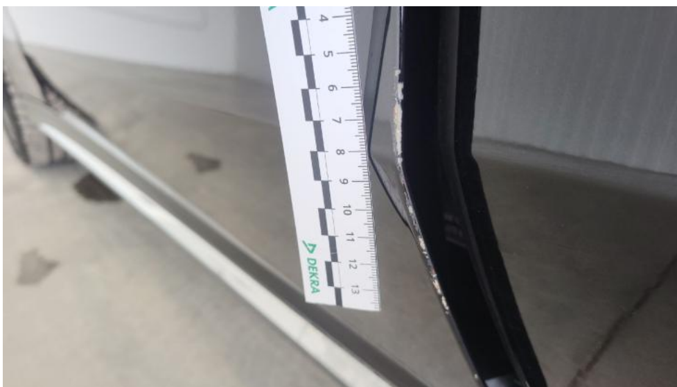
Photo 62. Drzwi przed L - Rysa/odprysk 1
