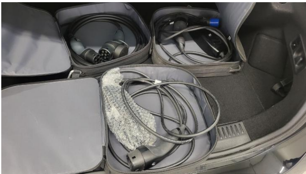
Photo 36. Przewód ładowania baterii trakcyjnej
