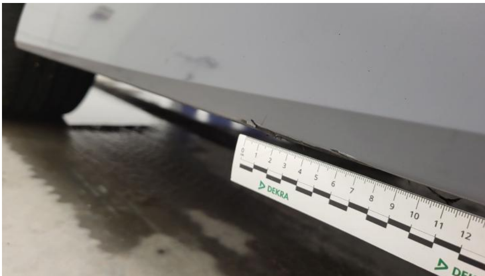
Fot. 67. Próg L - Rysa/odprysk 1
