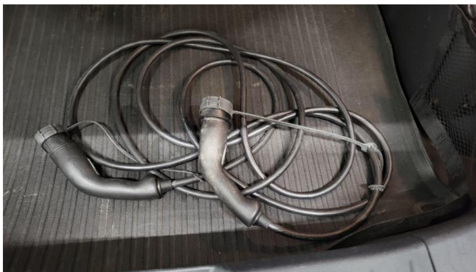
Fot. 34. Przewód ładowania baterii trakcyjnej
