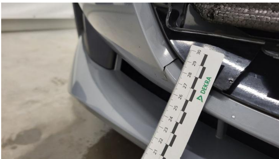
Fot. 53. Zderzak - Pęknięcie/rozerwanie 2
