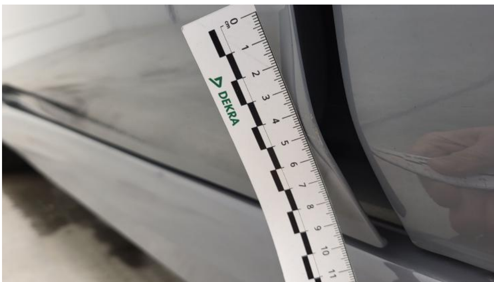
Fot. 66. Drzwi przed L - Rysa/odprysk 1
