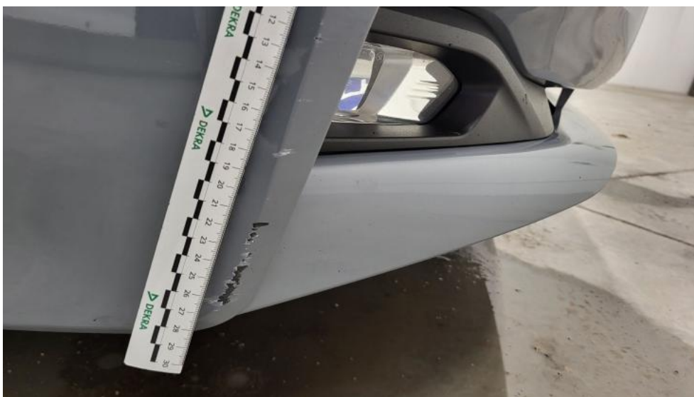
Fot. 51. Zderzak - Rysa/odprysk 1
