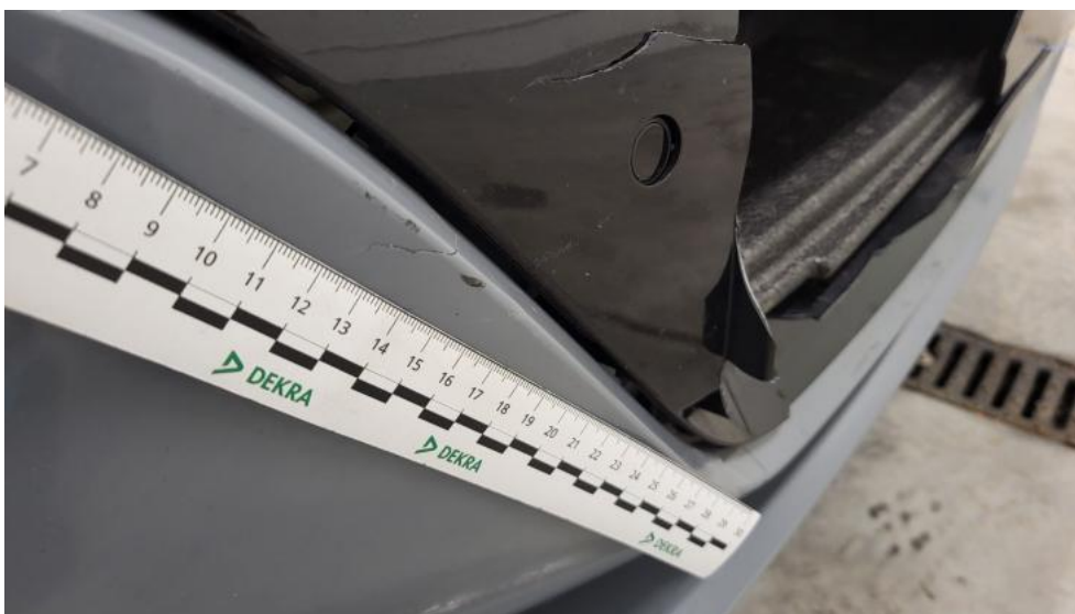
Fot. 52. Zderzak - Pęknięcie/rozerwanie 1
