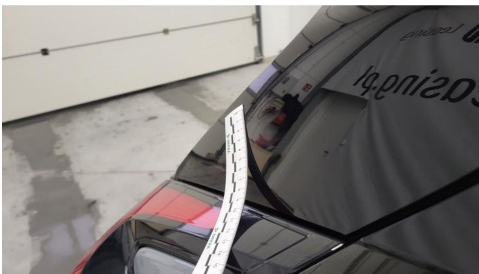
Fot. 62. Pokrywy bagażnika - Wgniecenie/odkształcenie 1
