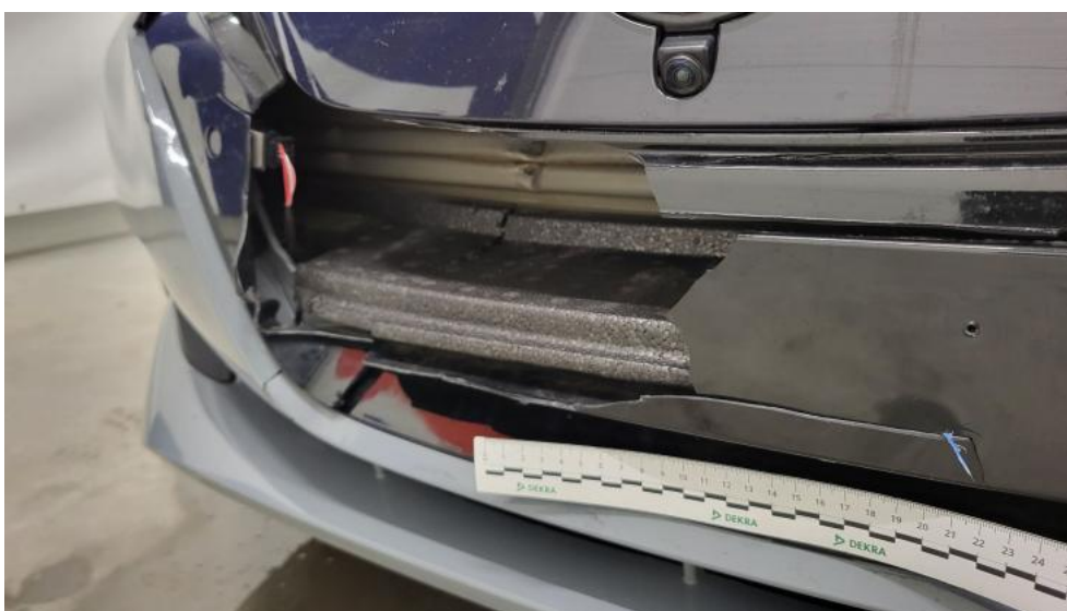
Fot. 46. Listwa śr zderzaka przedniego - Pęknięcie/rozerwanie 2
