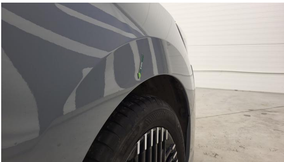
Fot. 54. Błotnik przedni P - Wgniecenie/odkształcenie 1
