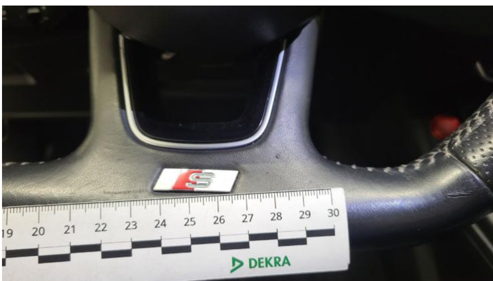
Photo 86. Koło kierownicy - Rysa/odprysk 1
