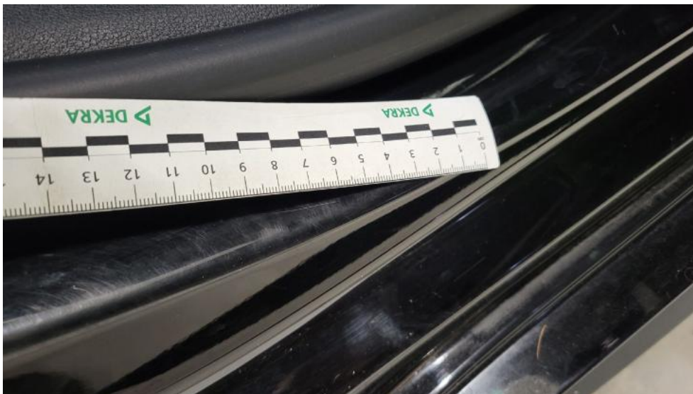
Photo 59. Próg P - Rysa/odprysk 1
