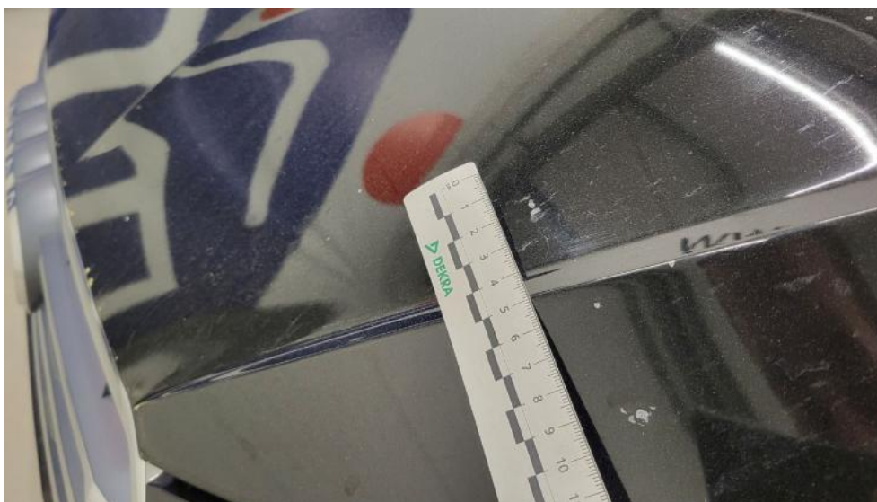
Photo 45. Pokrywa komory silnika - Rysa/odprysk 1
