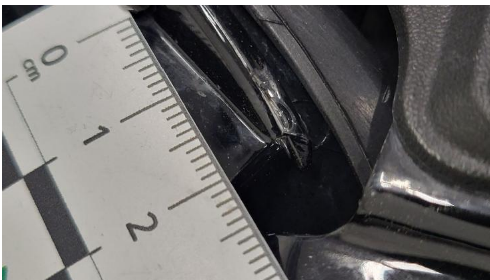
Photo 85. Reflektor L - Pęknięcie/rozerwanie 1
