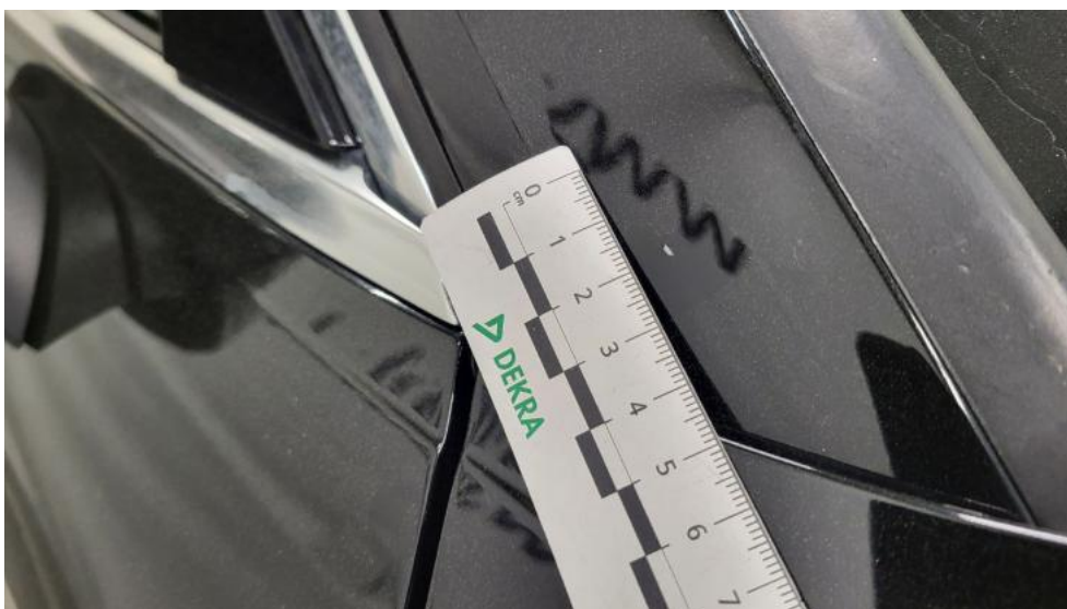
Photo 60. Słupek przedni P - Rysa/odprysk 1
