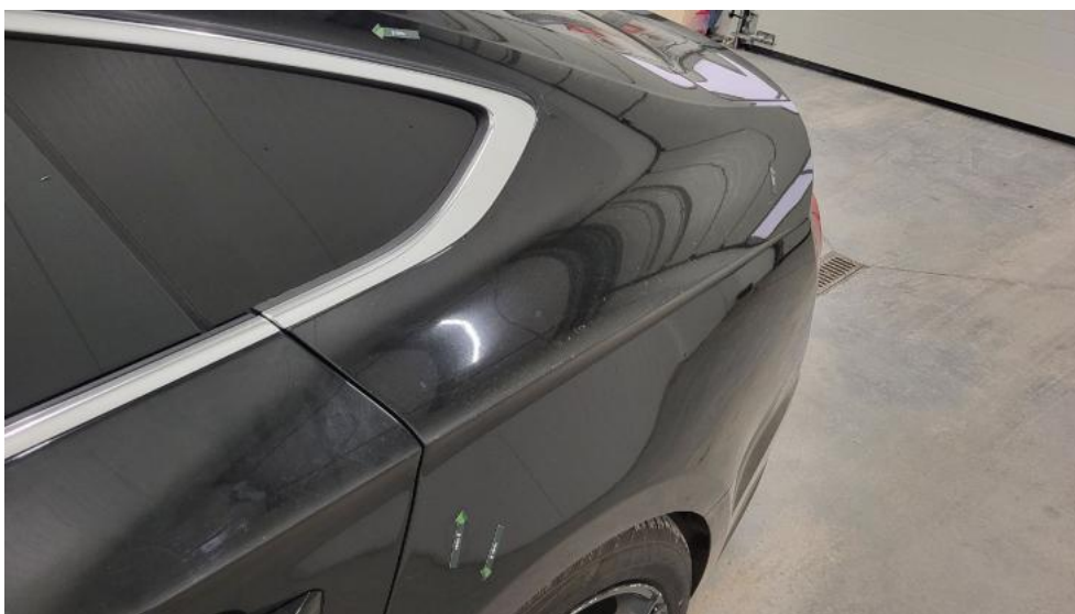
Photo 72. Błotnik tylny L / Ściana boczna L - Wgniecenie/odkształcenie 1
