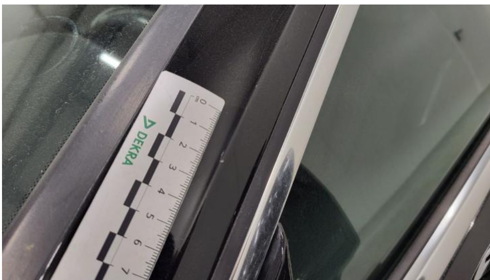
Photo 79. Stupek przedni L - Rysa/odprysk 1
