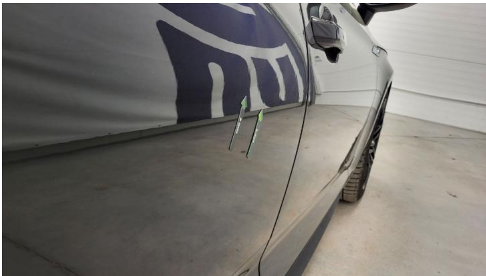
Photo 57. Drzwi tylne P - Wgniecenie/odkształcenie 1
