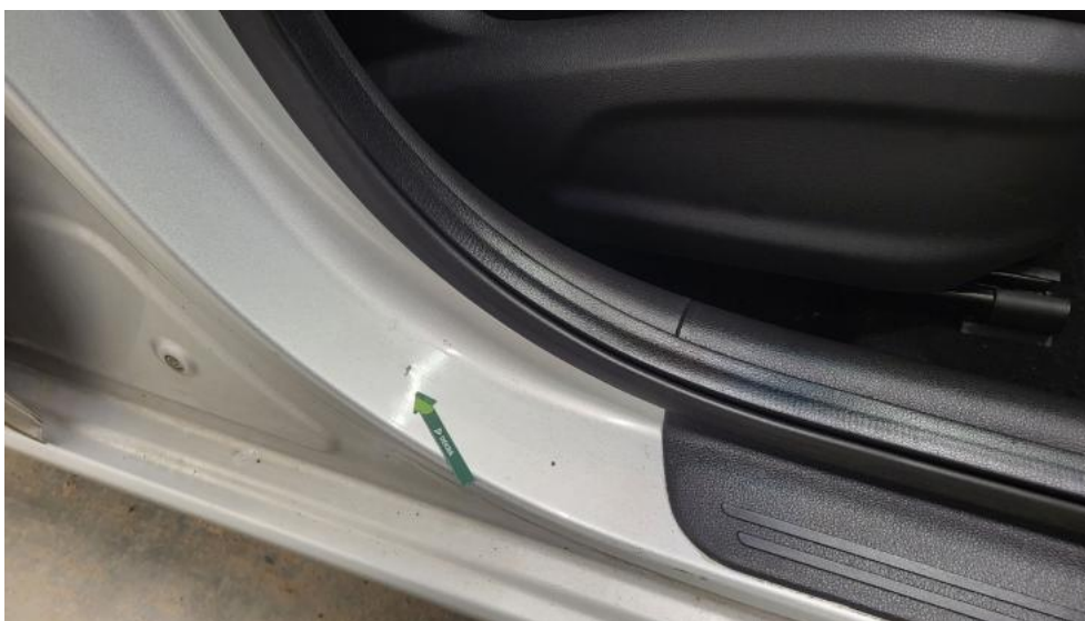
Photo 51. Próg P - Wgniecenie/odkształcenie 1
