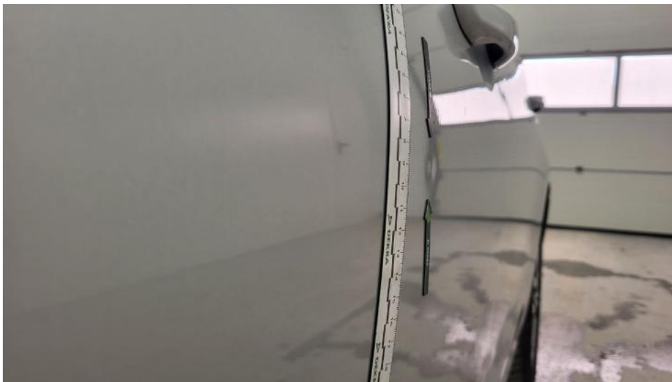
Photo 63. Drzwi przed L - Wgniecenie/odkształcenie 1
