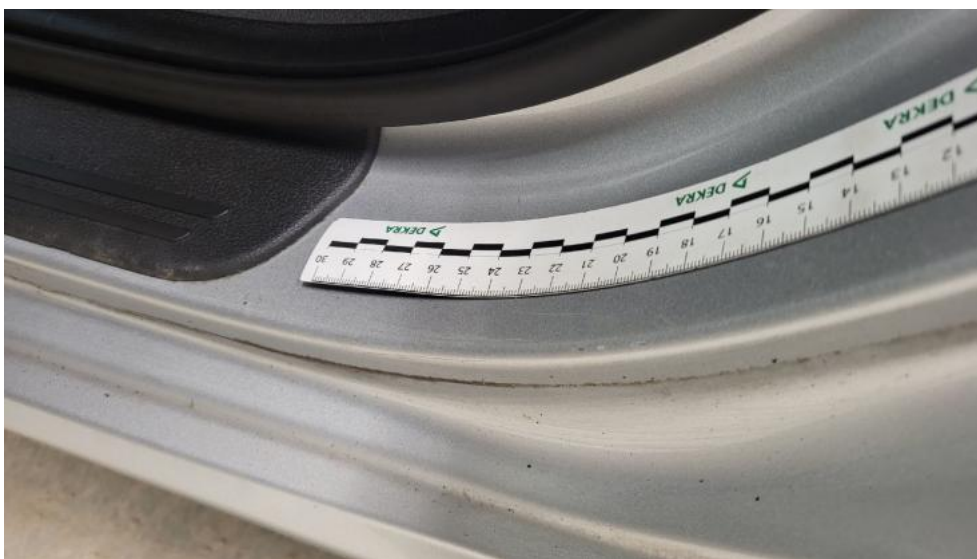
Photo 67. Próg L - Rysa/odprysk 1
