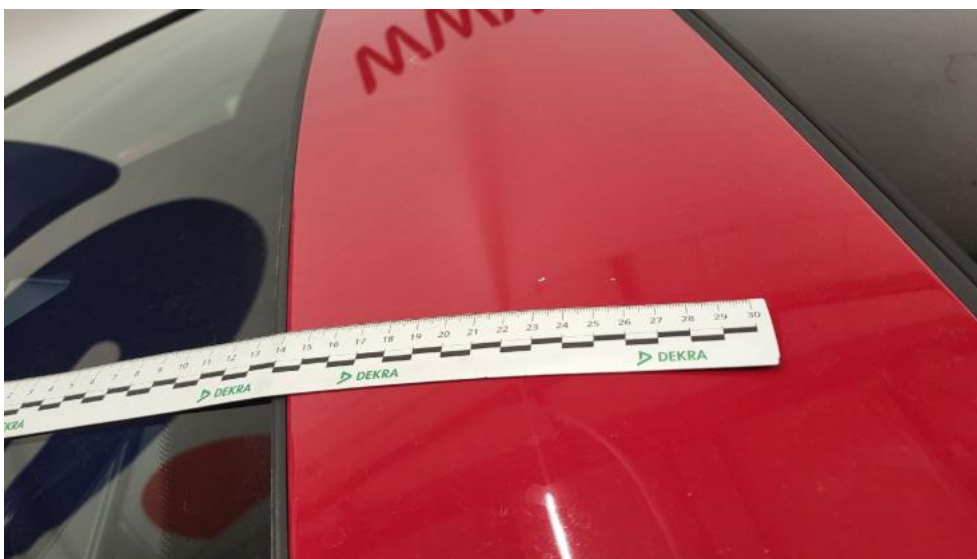
Fot. 55. Dach - Rysa/odprysk 1
