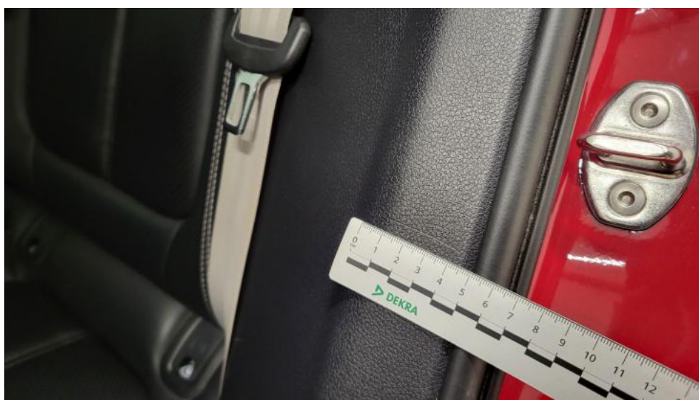
Fot. 68. Wykładzina(y) słupka tylnego L - Rysa/odprysk 1
