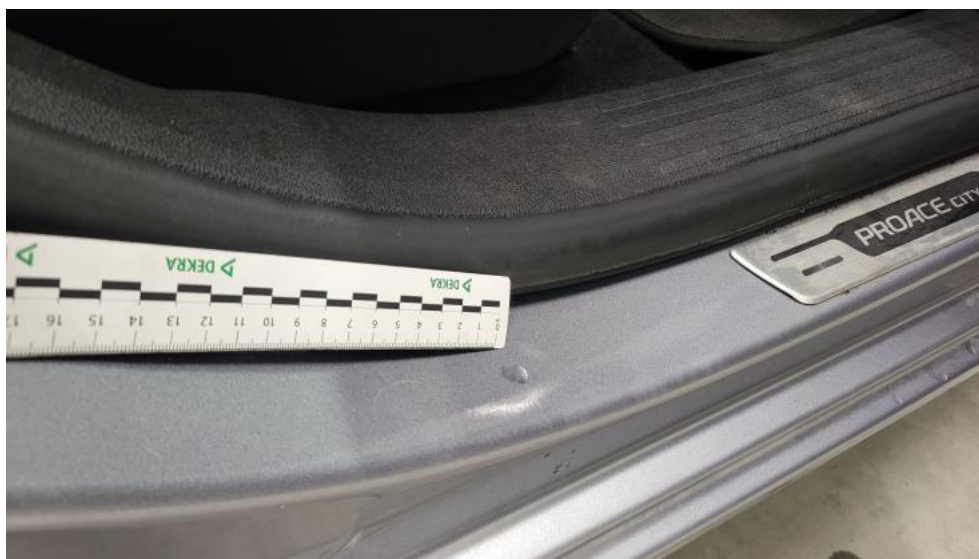
Fot. 39. Próg P - Rysa/odprysk 1
