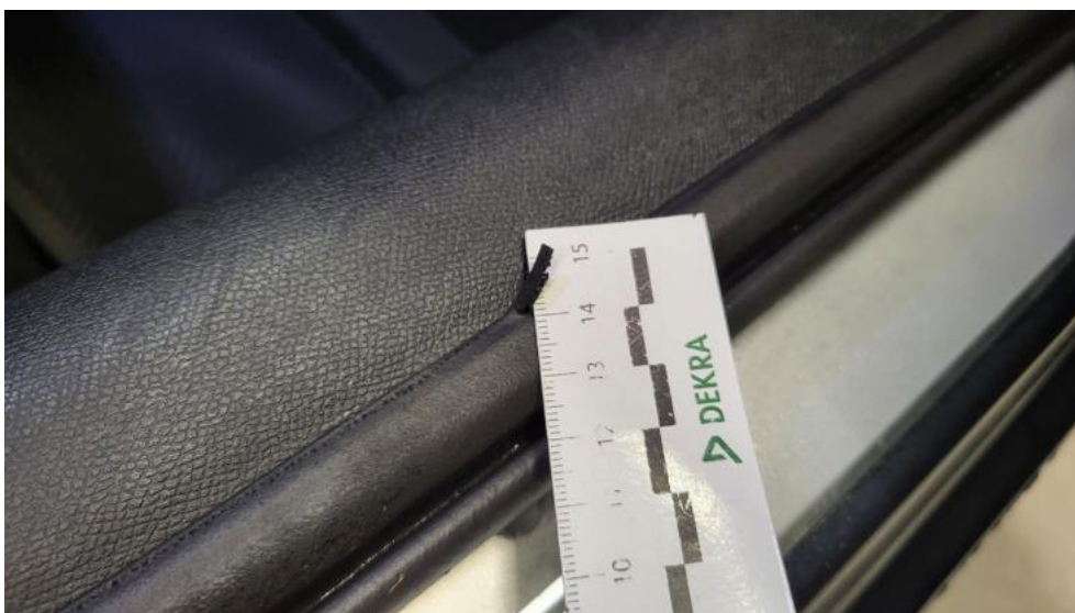
Fot. 66. Uszczelka drzwi przednich P - Pęknięcie/rozerwanie 1
