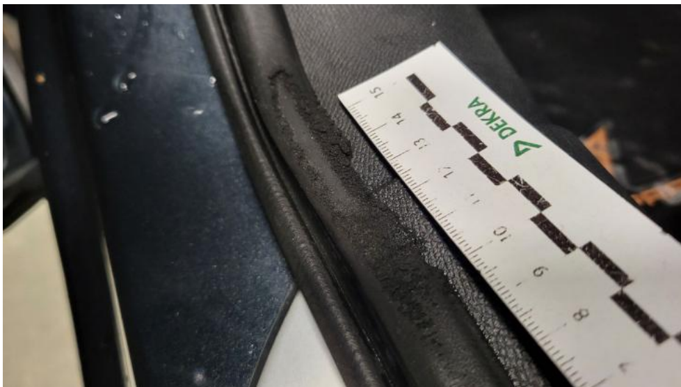
Fot. 65. Uszczelka drzwi przednich L - Pęknięcie/rozerwanie 1
