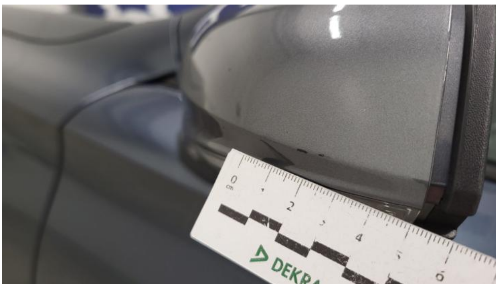
Fot. 57. Lusterko zew L - Rysa/odprysk 1
