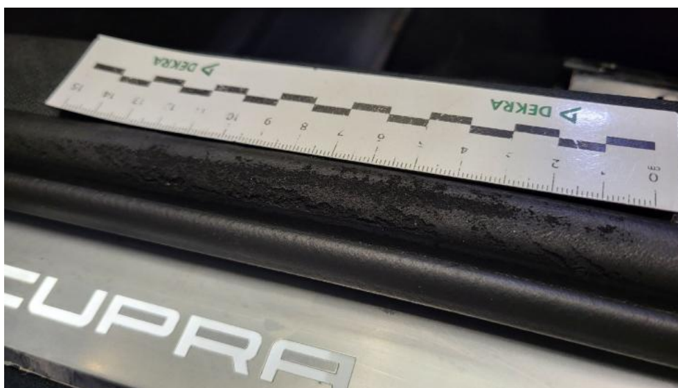
Fot. 64. Uszczelka drzwi przednich L - Rysa/odprysk 1
