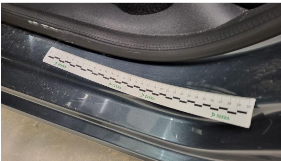
Fot. 67. Próg L - Rysa/odprysk 1
