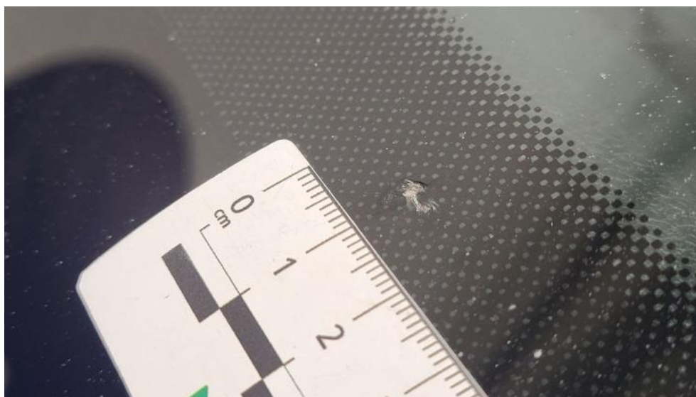
Fot. 45. Szyba czołowa - Pęknięcie/rozerwanie 1
