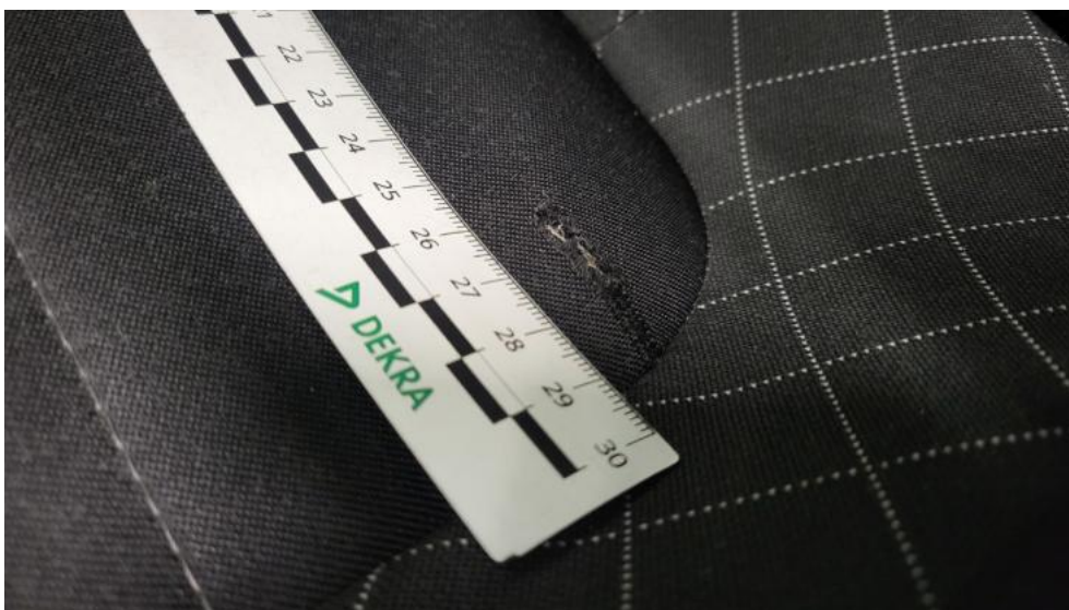
Fot. 75. Fotel prz. lew. - Pęknięcie/rozerwanie 1
