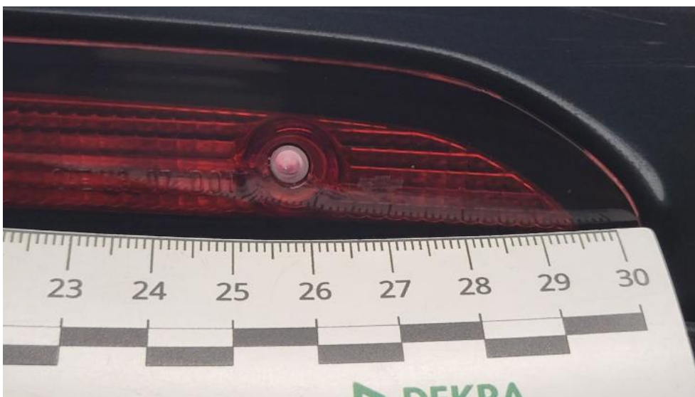
Fot. 58. Dodatkowa lampa stopu - Pęknięcie/rozerwanie 1
