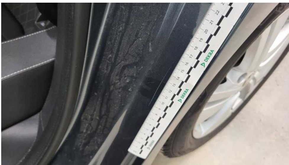
Fot. 63. Błotnik tylny L / Ściana boczna L - Rysa/odprysk 1
