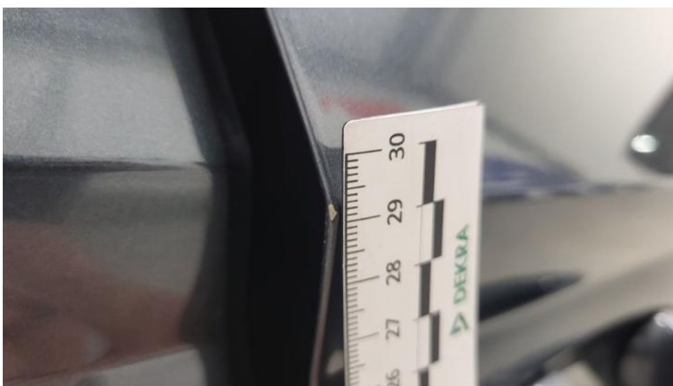
Fot. 50. Drzwi przednie P - Rysa/odprysk 1
