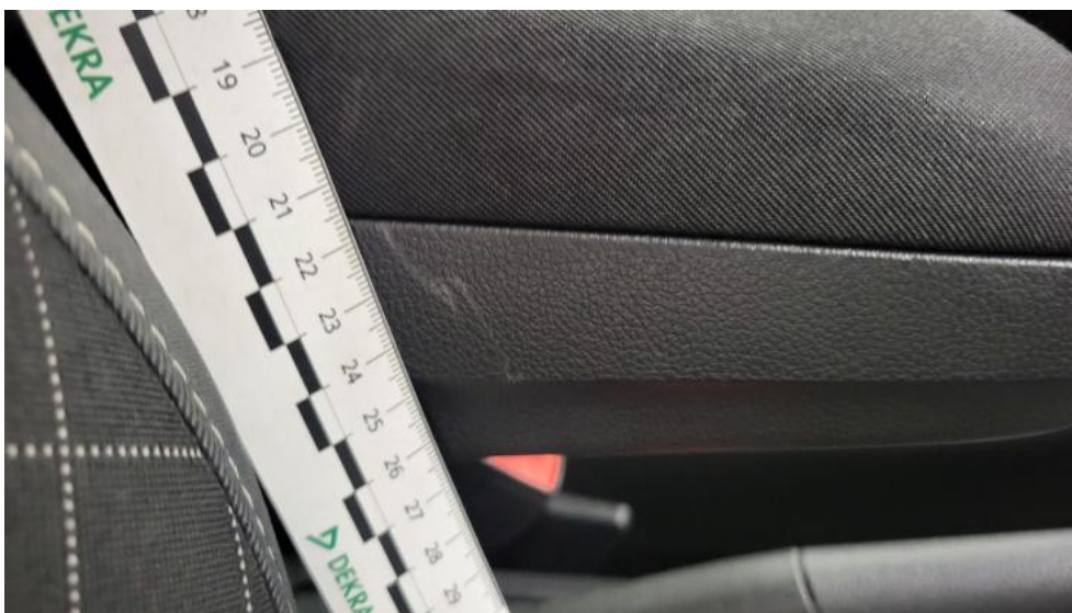
Fot. 73. Podłokietnik środkowy przedni - Rysa/odprysk 1
