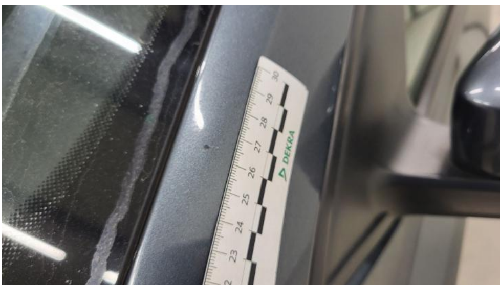
Fot. 68. Słupek przedni L - Rysa/odprysk 1
