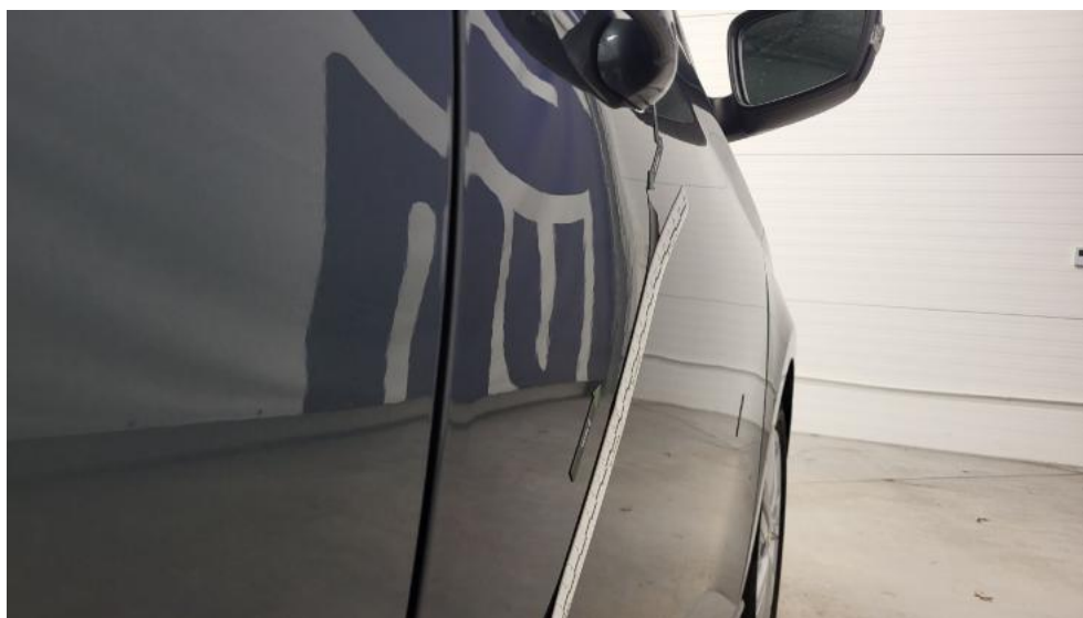
Fot. 51. Drzwi przednie P - Wgniecenie/odkształcenie 1
