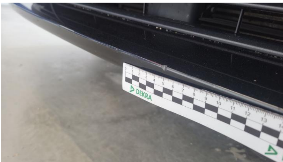
Fot. 43. Zderzak - Rysa/odprysk 2
