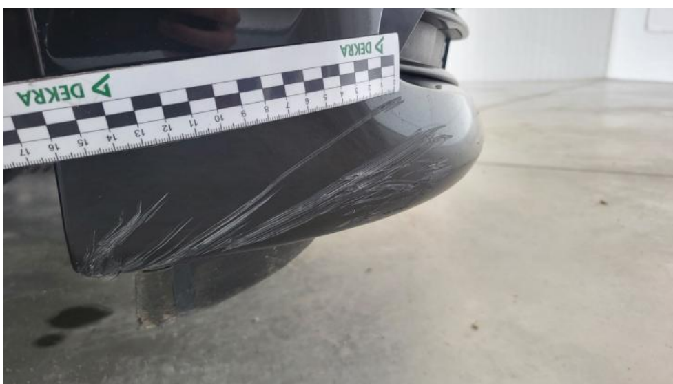
Fot. 44. Zderzak() - Rysa/odprysk 3
