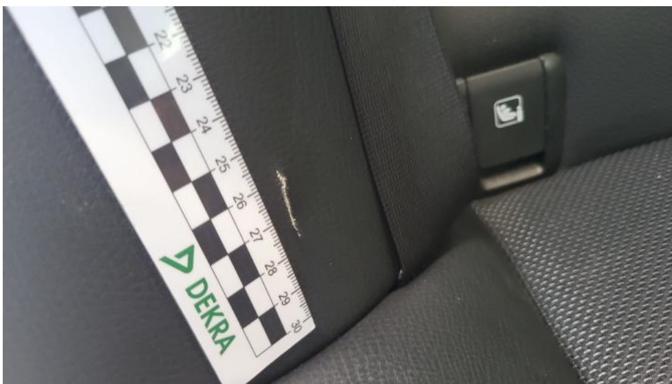
Fot. 68. Wykładzina(y) słupka tylnego P - Pęknięcie/rozerwanie 1
