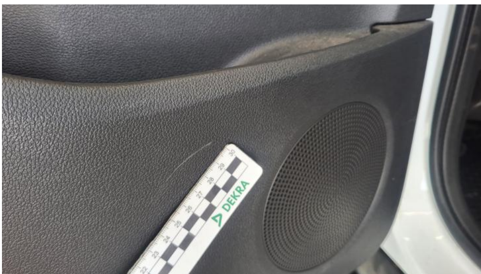
Fot. 54. Tapicerka drzwi tylnych L - Rysa/odprysk 1
