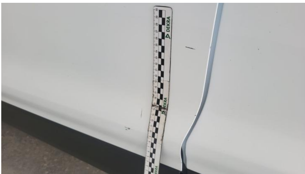
Fot. 44. Drzwi przed L - Rysa/odprysk 1
