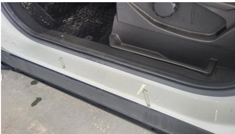
Fot. 48. Próg L - Wgniecenie/odkształcenie 1
