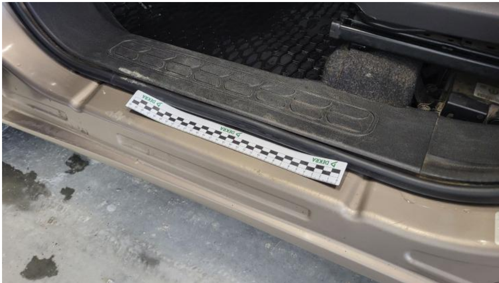
Photo 67. Próg L - Rysa/odprysk 2
