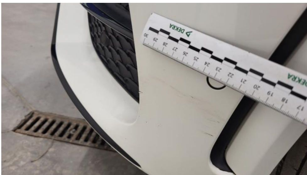
Fot. 44. Zderzak - Rysa/odprysk 1
