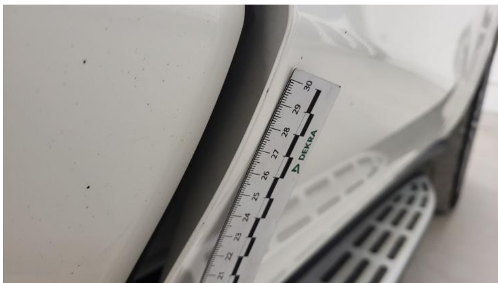
Fot. 48. Drzwi przednie P - Rysa/odprysk 1
