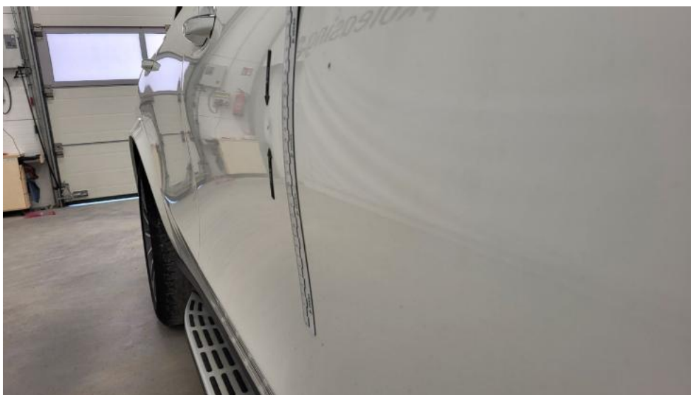
Fot. 49. Drzwi przednie P - Wgniecenie/odkształcenie 1
