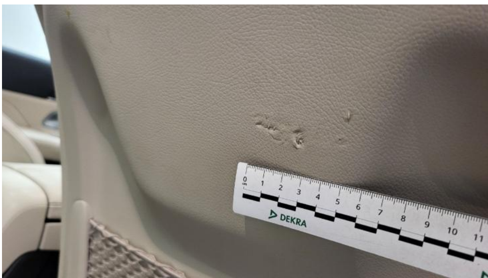
Fot. 64. Fotel prz. praw. - Wgniecenie/odkształcenie 1
