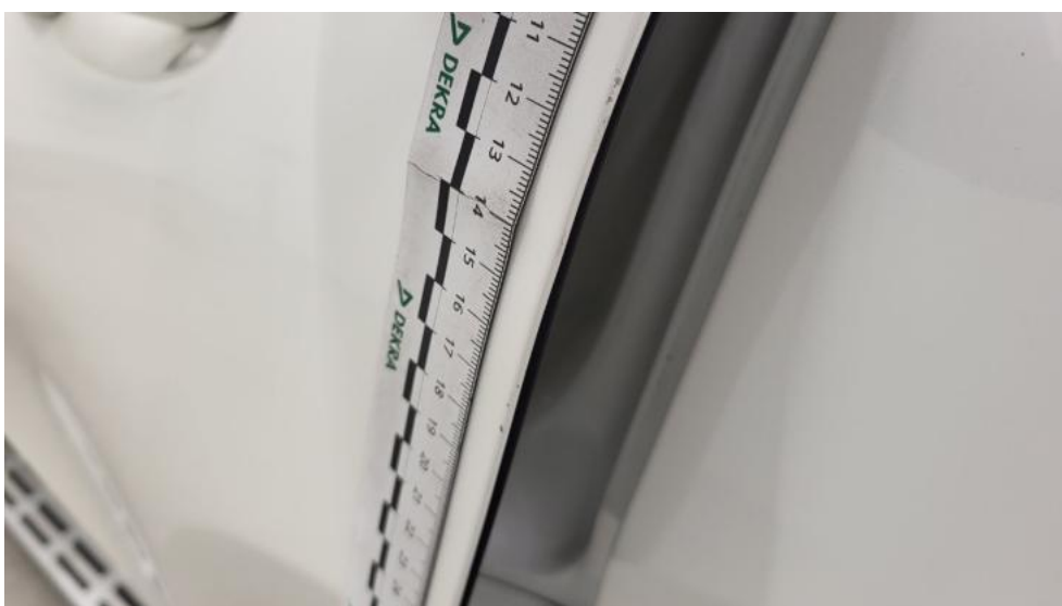
Fot. 60. Drzwi tylne L - Rysa/odprysk 1
