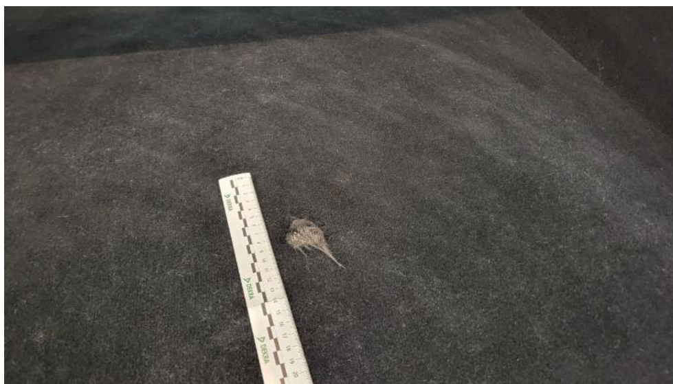
Fot. 71. Wykładzina podłogi bagażnika - Pęknięcie/rozerwanie 1
