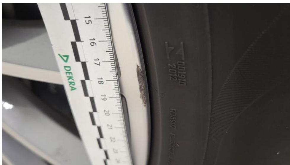
Fot. 61. Felga Aluminiowa przednia L - Rysa/odprysk 1
