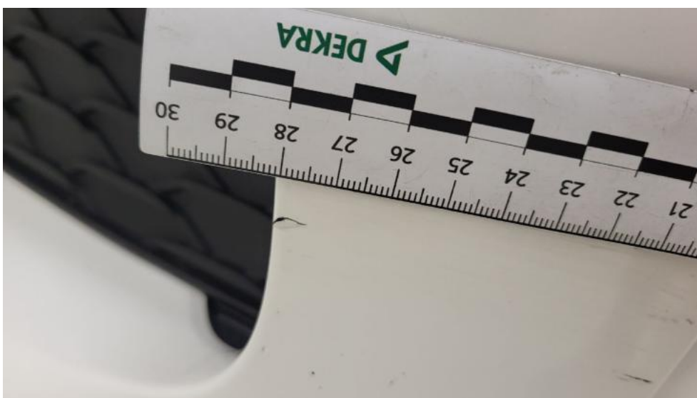
Fot. 46. Zderzak - Pęknięcie/rozerwanie 1
