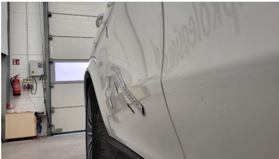
Fot. 51. Drzwi tylne P - Wgniecenie/odkształcenie 1
