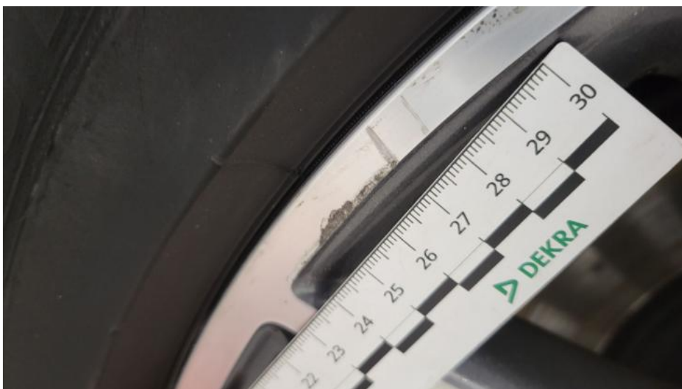
Fot. 52. Felga aluminiowa tylna P - Rysa/odprysk 1
