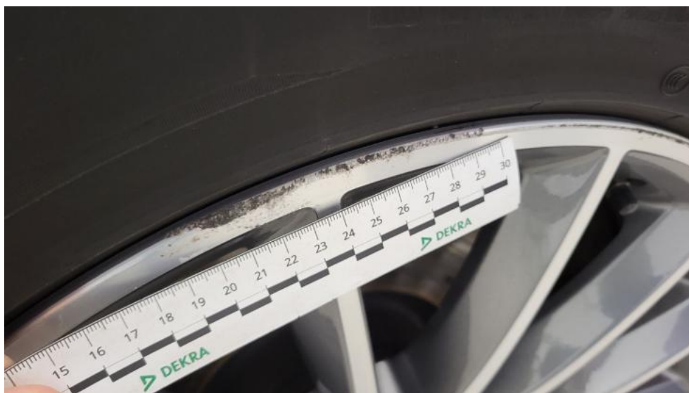
Fot. 47. Felga aluminiowa przednia P - Rysa/odprysk 1
