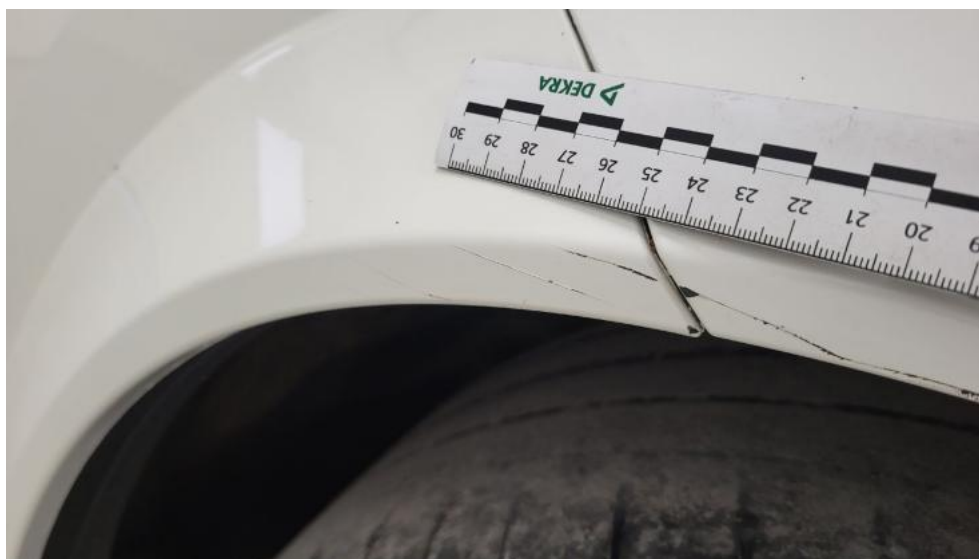
Fot. 55. Zderzak tylny - Rysa/odprysk 1
