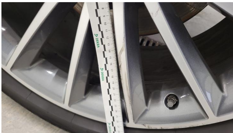
Fot. 57. Felga aluminiowa tylna L - Rysa/odprysk 1
