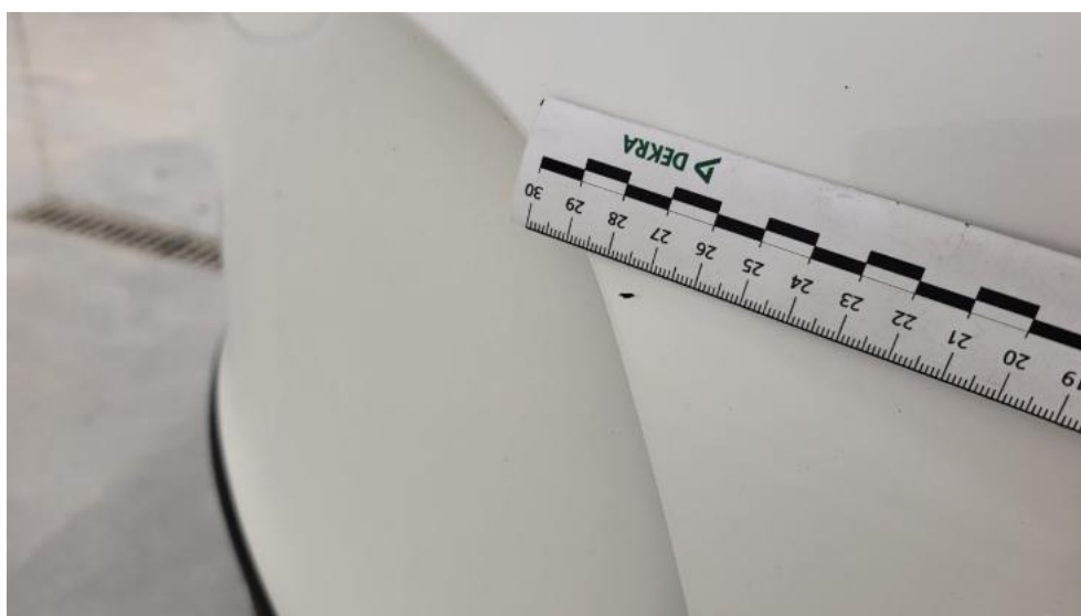
Fot. 56. Zderzak tylny - Rysa/odprysk 2
