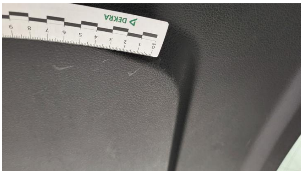
Fot. 72. Wykładzina pokrywy tylnej - Rysa/odprysk 1
