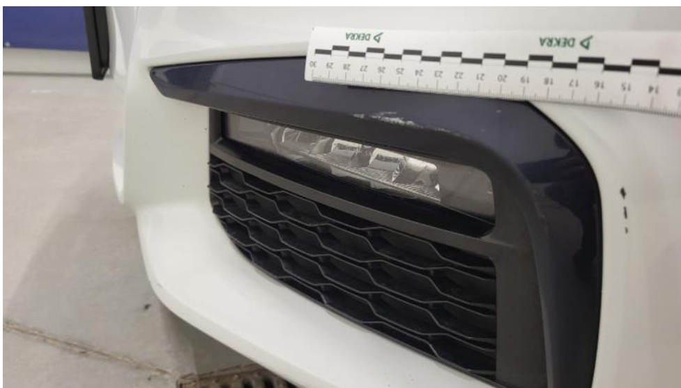
Fot. 40. Kratka/zaślepka halogenu L - Rysa/odprysk 1
