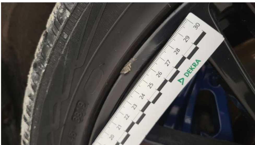
Fot. 50. Felga aluminiowa przednia P - Rysa/odprysk 1
