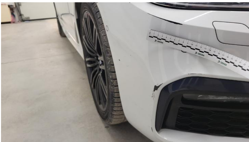
Fot. 47. Zderzak() - Rysa/odprysk 3
