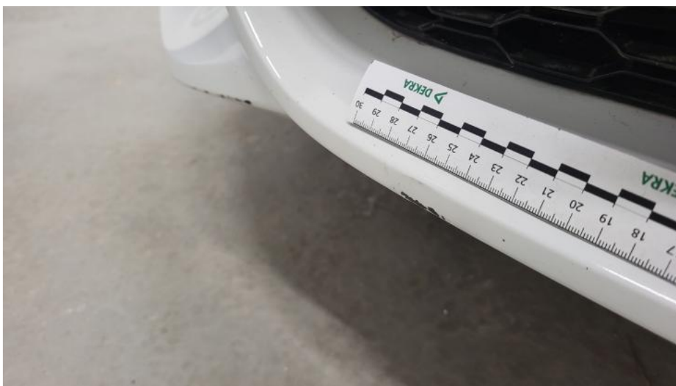
Fot. 48. Zderzak - Wgniecenie/odkształcenie 1
