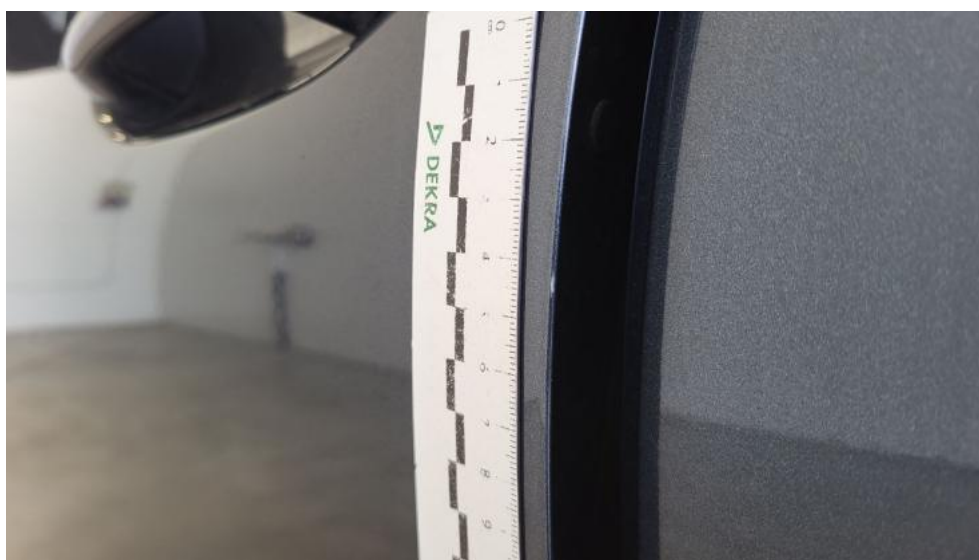
Fot. 60. Drzwi przed L - Rysa/odprysk 1
