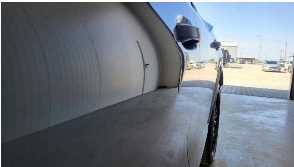
Fot. 61. Drzwi przed L - Wgniecenie/odkształcenie 1
