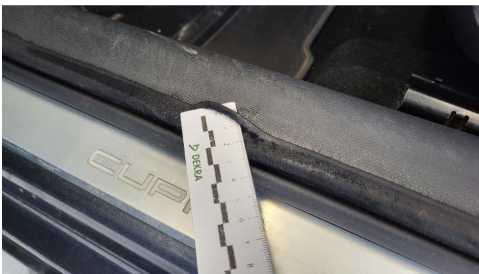
Fot. 70. Uszczelka drzwi przednich L - Pęknięcie/rozerwanie 1
