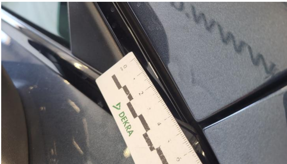
Fot. 49. Listwa drzwi przednich P - Rysa/odprysk 1
