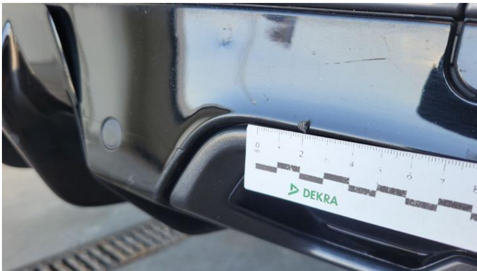
Fot. 57. Zderzak tylny cz dolna - Wgniecenie/odkształcenie 1
