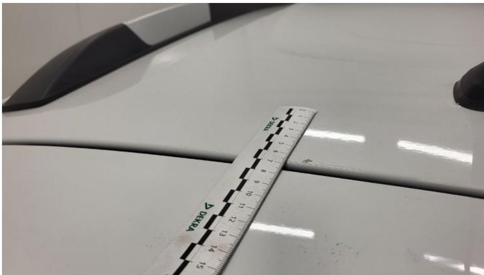
Fot. 65. Dach - Rysa/odprysk 2
