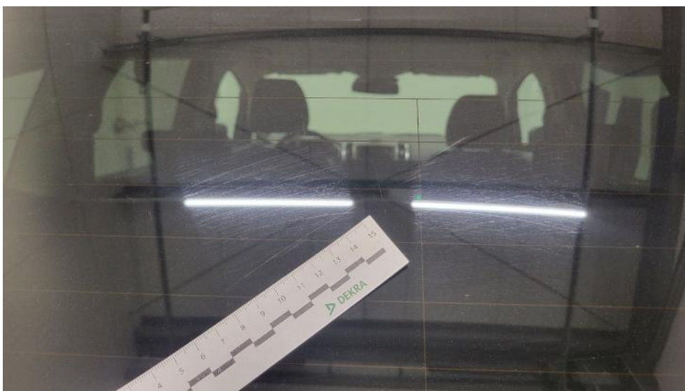
Photo 70. Szyba tylna - Rysa/odprysk 1
