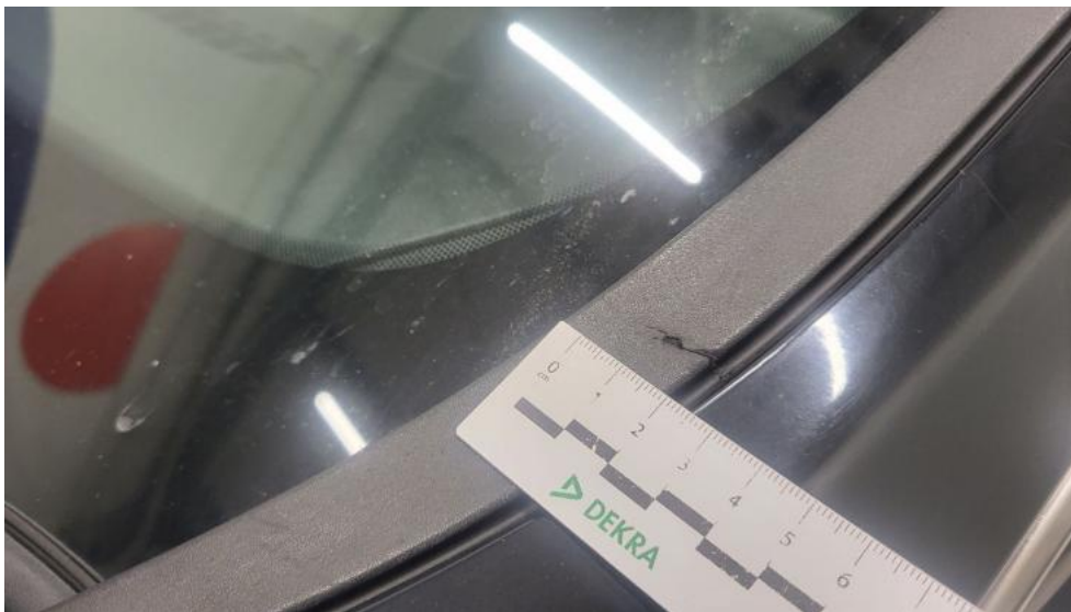
Photo 45. Uszczelka/listwa szyby czołowej - Rysa/odprysk 1
