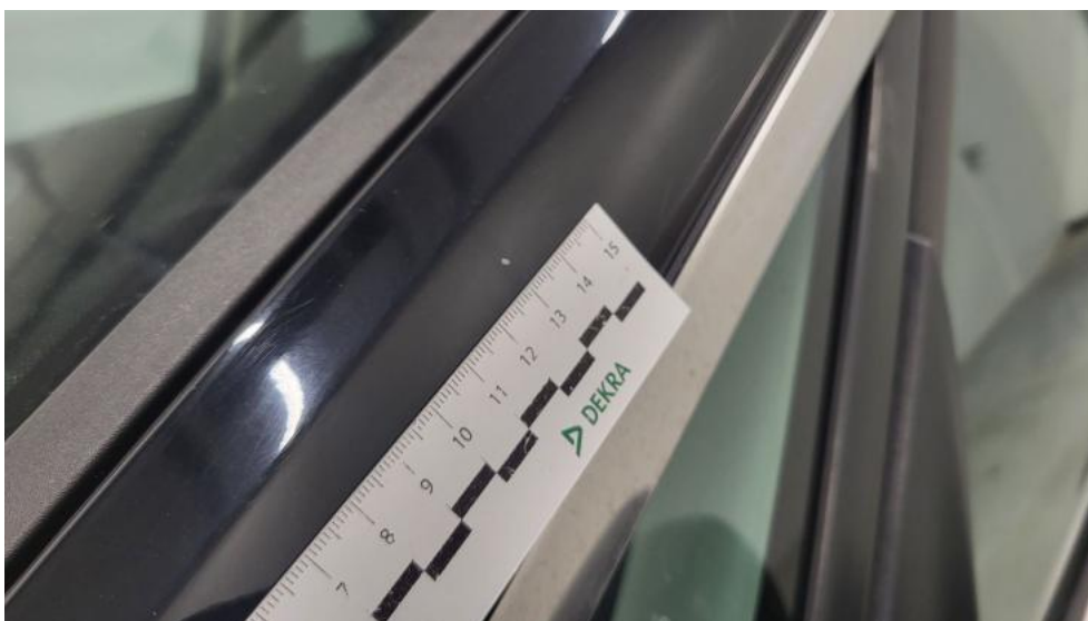
Photo 84. Słupek przedni L - Rysa/odprysk 1
