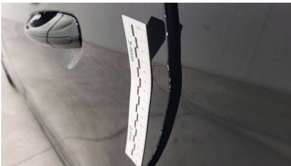
Photo 80. Drzwi tylne L - Rysa/odprysk 1
