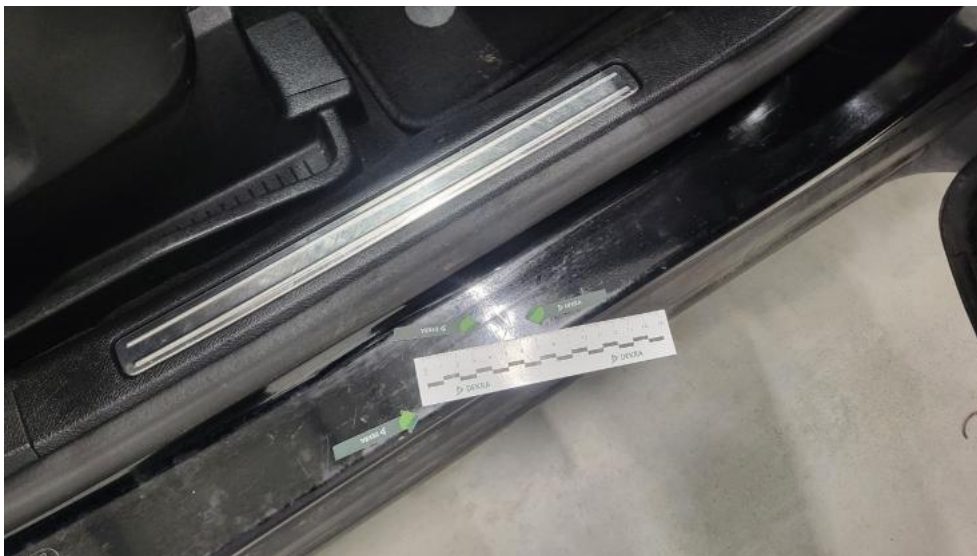
Photo 59. Próg P - Wgniecenie/odkształcenie 1
