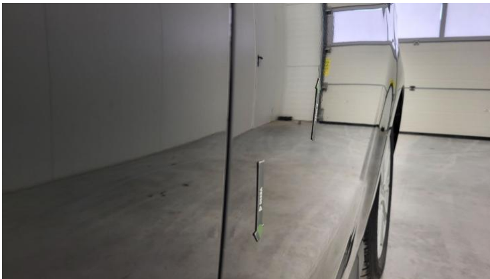
Photo 81. Drzwi tylne L - Wgniecenie/odkształcenie 1
