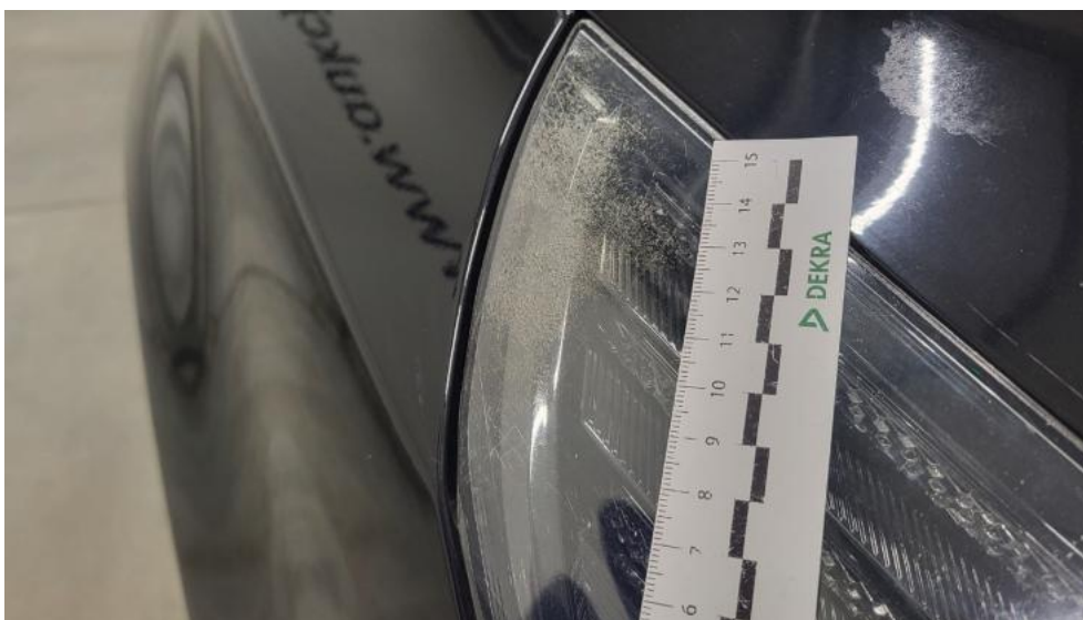
Photo 51. Reflektor P - Rysa/odprysk 1
