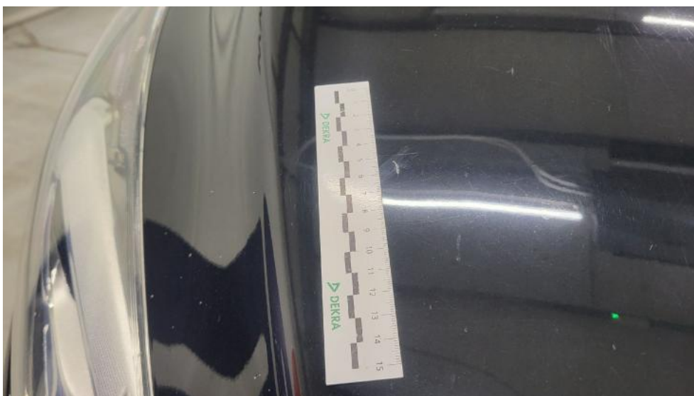
Photo 40. Pokrywa komory silnika - Rysa/odprysk 1
