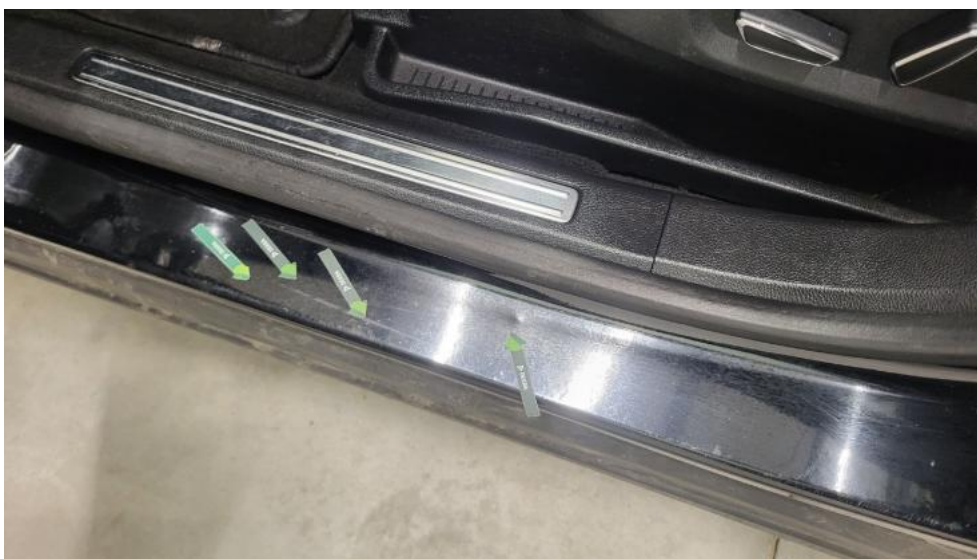
Photo 83. Próg L - Wgniecenie/odkształcenie 1
