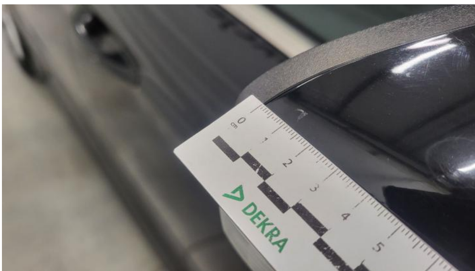
Photo 57. Lusterko zew P - Rysa/odprysk 1
