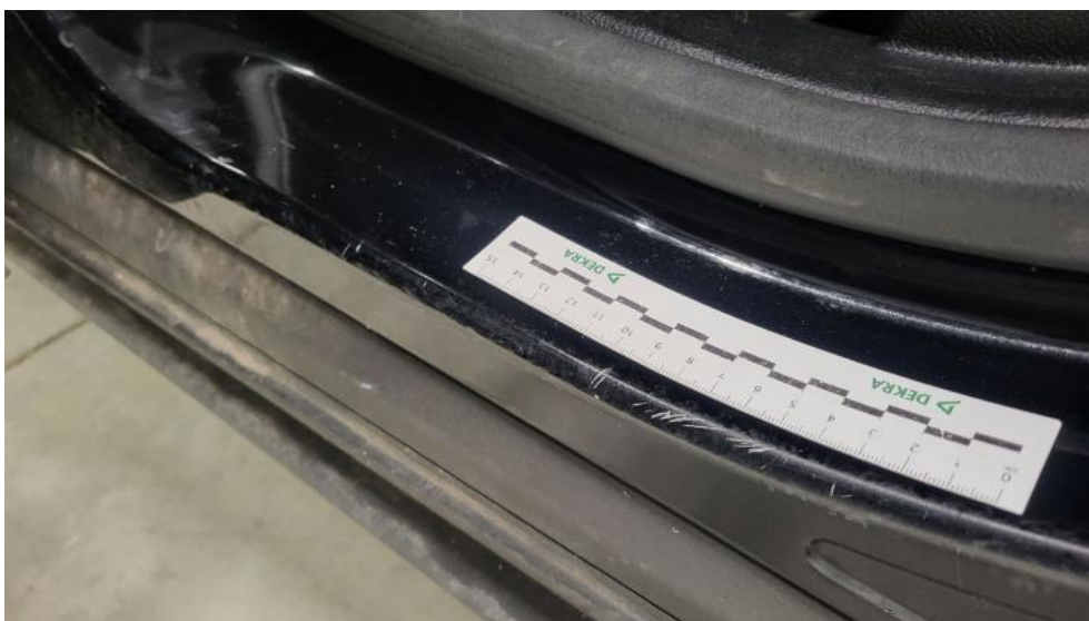
Photo 82. Próg L - Rysa/odprysk 1
