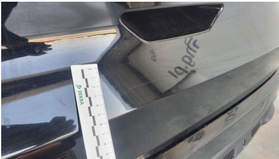
Photo 67. Pokrywy bagażnika - Wgniecenie/odkształcenie 2
