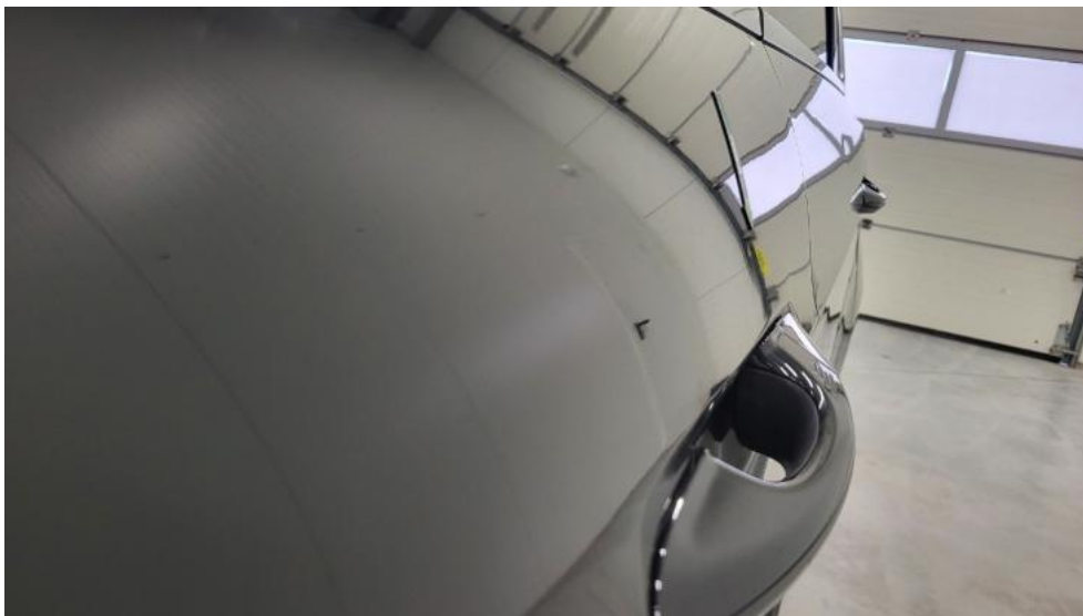
Photo 79. Drzwi przed L - Wgniecenie/odkształcenie 1
