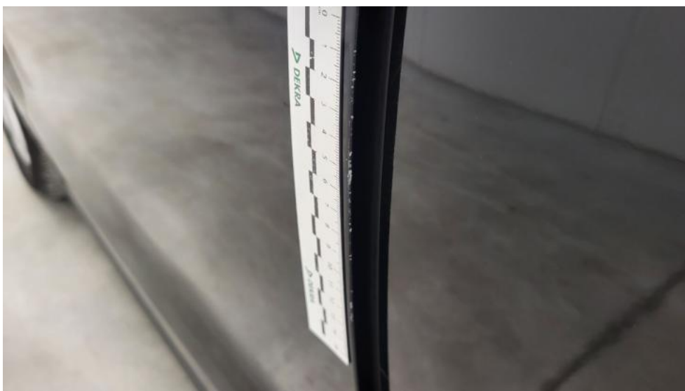
Photo 78. Drzwi przed L - Rysa/odprysk 1
