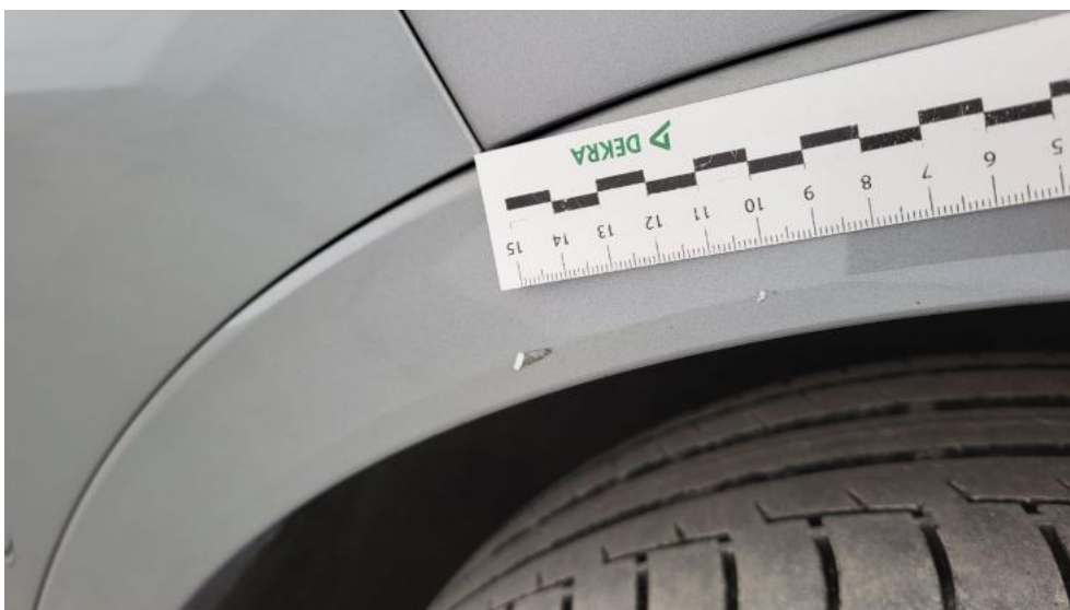
Fot. 68. Listwa błotnika przedniego L - Rysa/odprysk 1
