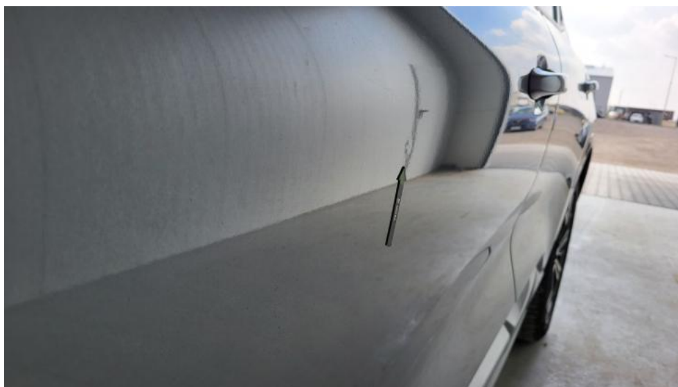
Fot. 65. Drzwi przed L - Wgniecenie/odkształcenie 1
