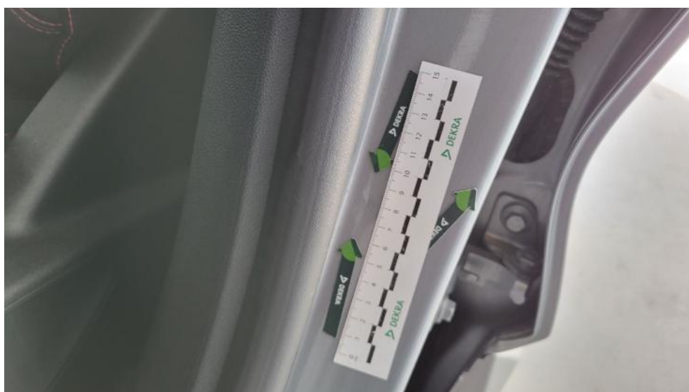
Fot. 66. Słupek środkowy L - Wgniecenie/odkształcenie 1
