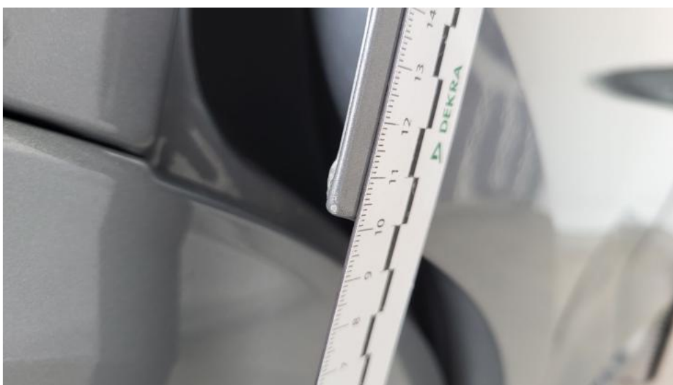
Fot. 50. Drzwi tylne P - Rysa/odprysk 1
