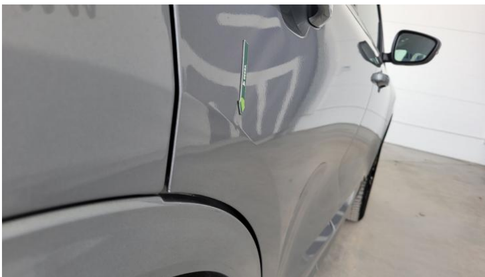
Fot. 51. Drzwi tylne P - Wgniecenie/odkształcenie 1
