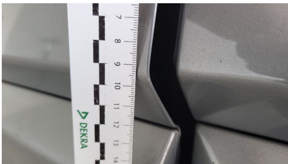
Fot. 64. Drzwi przed L - Rysa/odprysk 1
